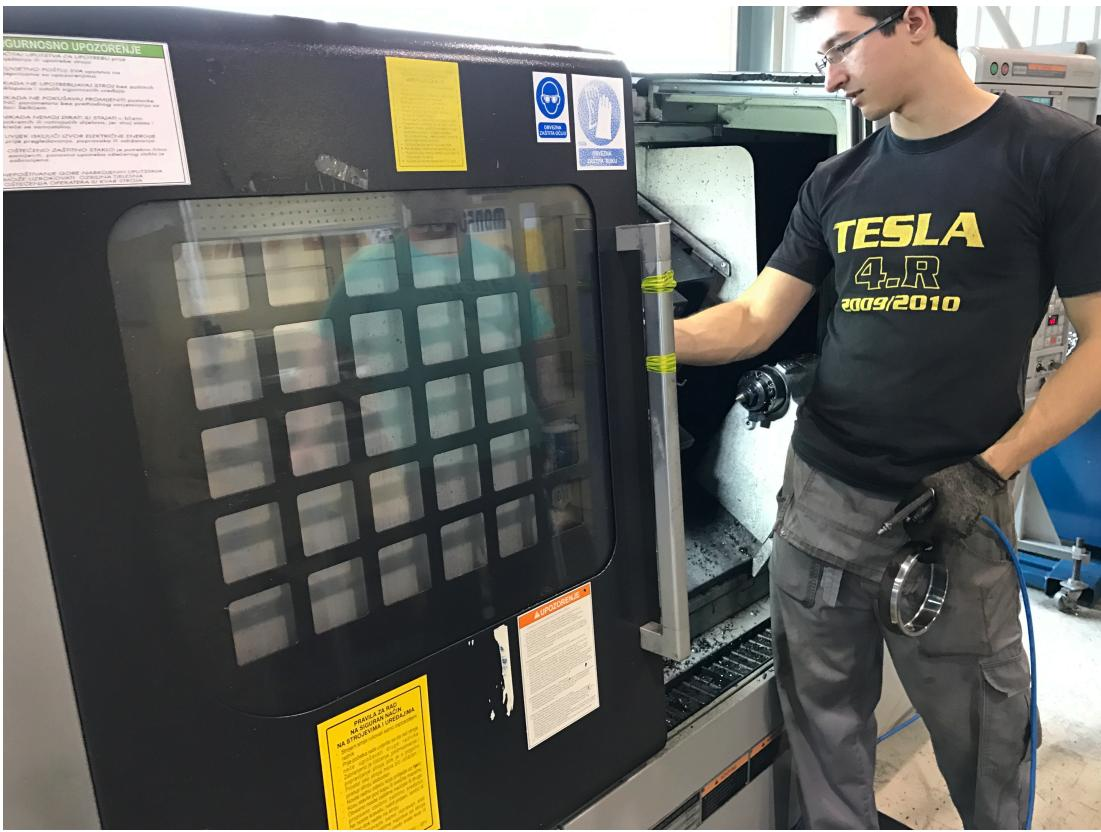
Radno mjesto sastoji se od 2 stroja, odnosno 2 tokarilice na kojima radi jedan operater. Radi se na 2 tokarilice jer jedna ne može napraviti potpunu operaciju obrade. Operacija na prvoj tokarilici je duža nego na drugoj te je normirano 15 sekundi za prebacivanje obratka s jedne na drugu tokarilicu. Ukupno vrijeme izrade obratka je jedna minuta.
