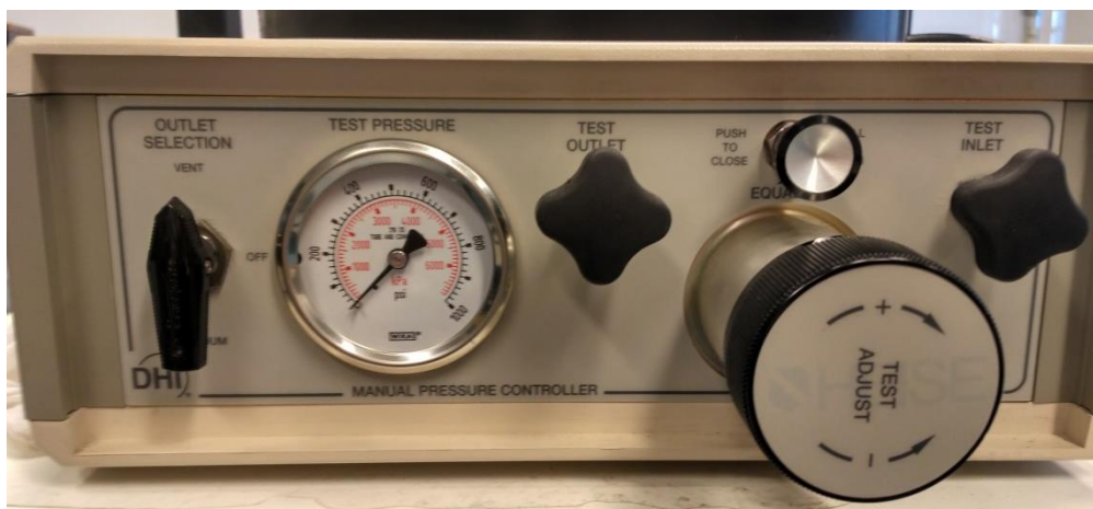
Slika 3.2 Ručni regulator tlaka MPC1
