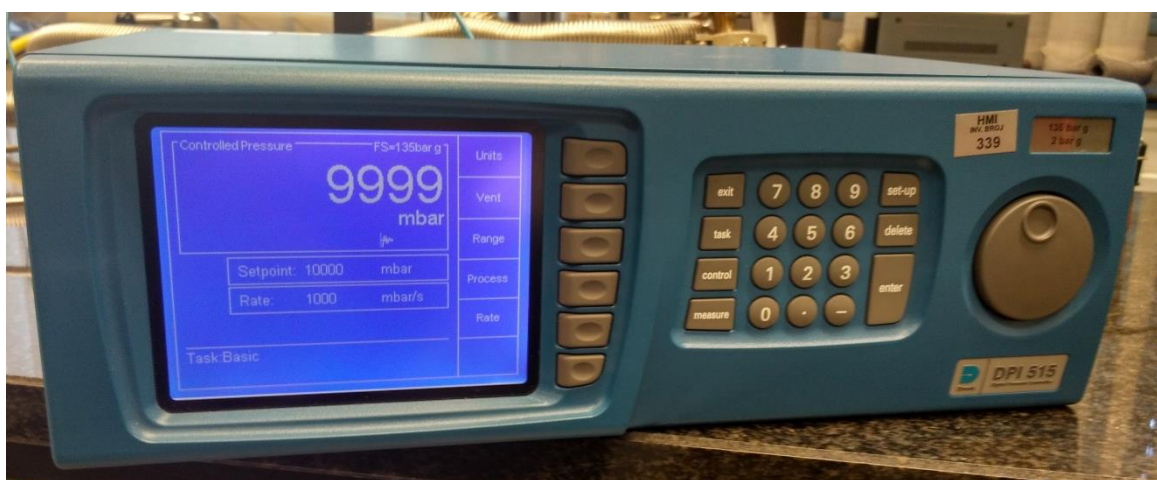
Slika 4.5 DPI 515 u načinu generiranja tlaka
