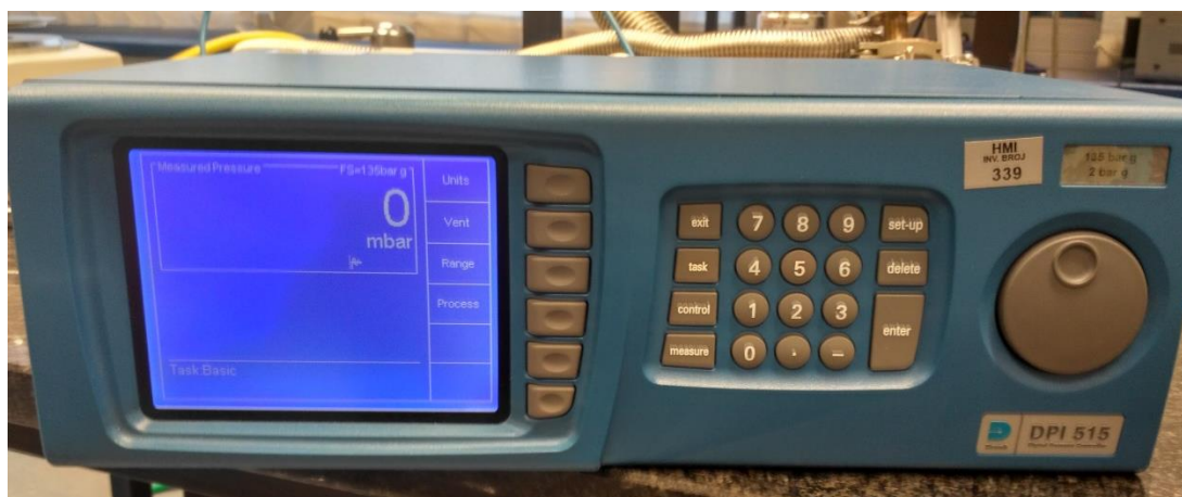
Slika 4.4 Pretvornik tlaka DPI 515 u načinu mjerenja tlaka
