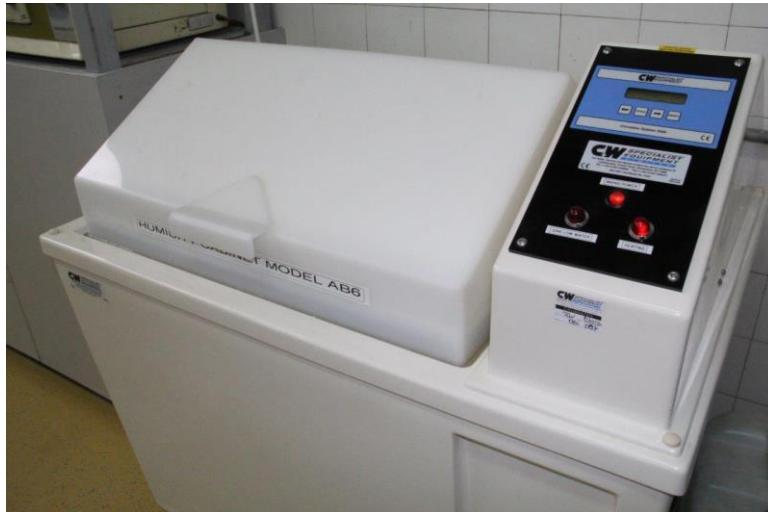
Slika 24: Vlažna komora C&W, Model AB6
