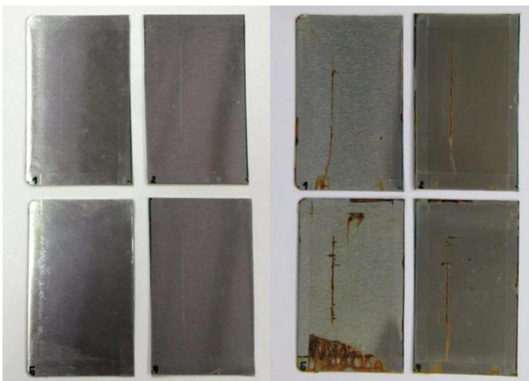
Slika 22: Uzorci 1 i 2 zaštićeni premazom 386 sa VCI inhibitorom te uzorci 6 i 7 zaštićeni premazom 386 bez VCI inhibitora prije (lijevo) i poslije (desno) ispitivanja u slanoj komori
