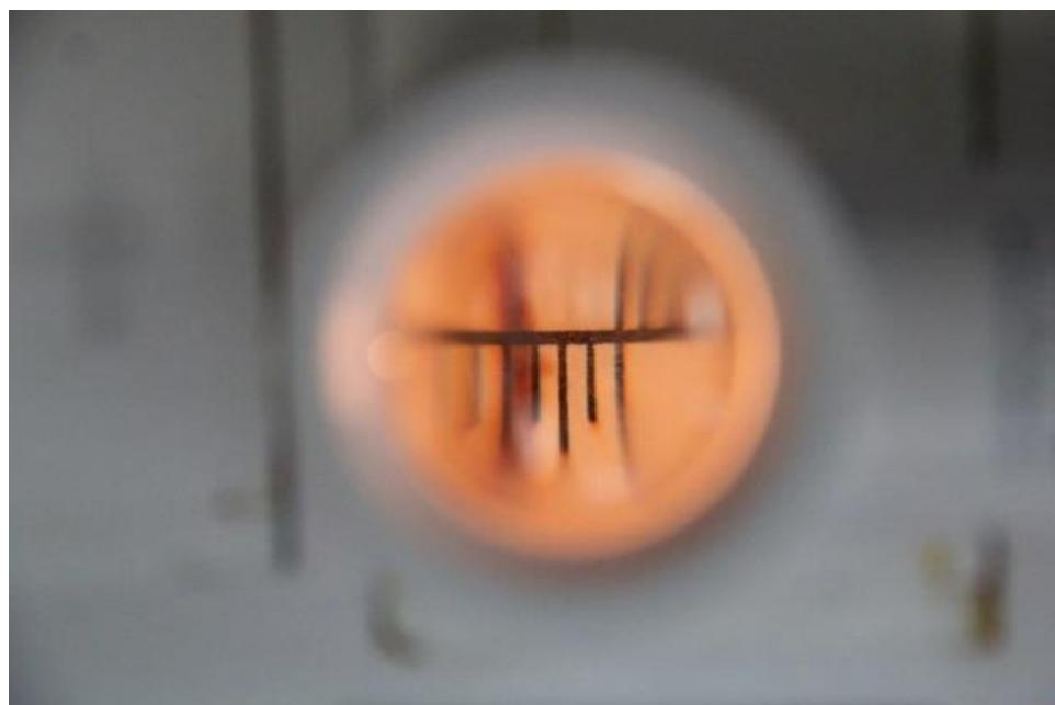
**Slika 28: Mjerjenje širine zone korozije oko ureza uz pomoć povećala sa mjernom skalom**
