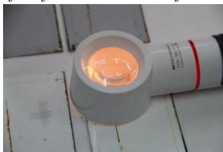
Slika 23: Mjerenje širine zone korozije oko ureza uz pomoć povećala sa mjernom skalom
