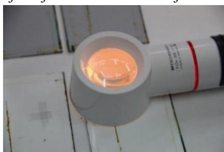
**Slika 23: Mjerjenje širine zone korozije oko ureza uz pomoć povećala sa mjernom skalom**
