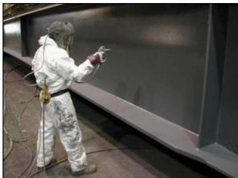
Slika 10: Nanošenje premaza bezračnim prskanjem [13]
