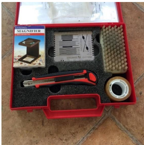
Slika 29: Set za Cross-cut test
