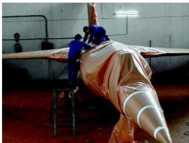
Slika 7: Primjer zaštite borbenog zrakoplova primjenom folije s VCI inhibitorom [1]
