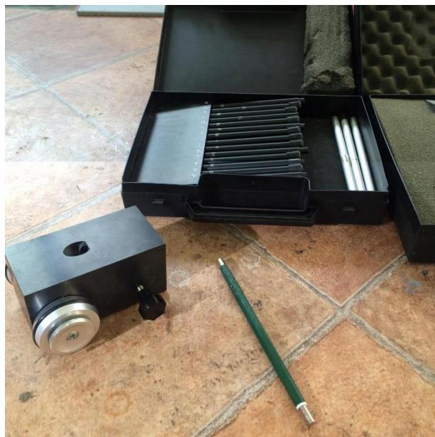
**Slika 19:** Set za mjerjenje tvrdoće premaza
