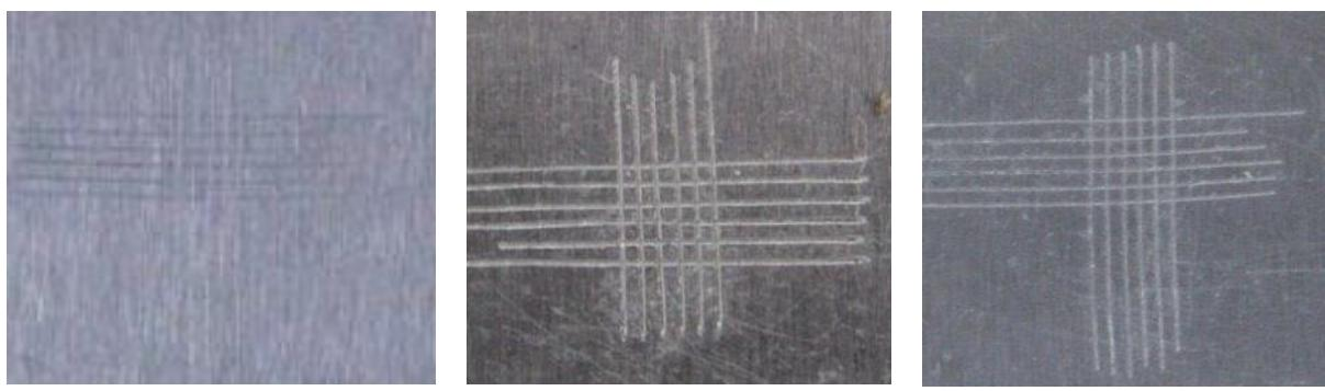
Slika 34: Uzorci premazani istim premazom, 386 bez inhibitora, ispitani na prionjivost Cross-cut metodom
