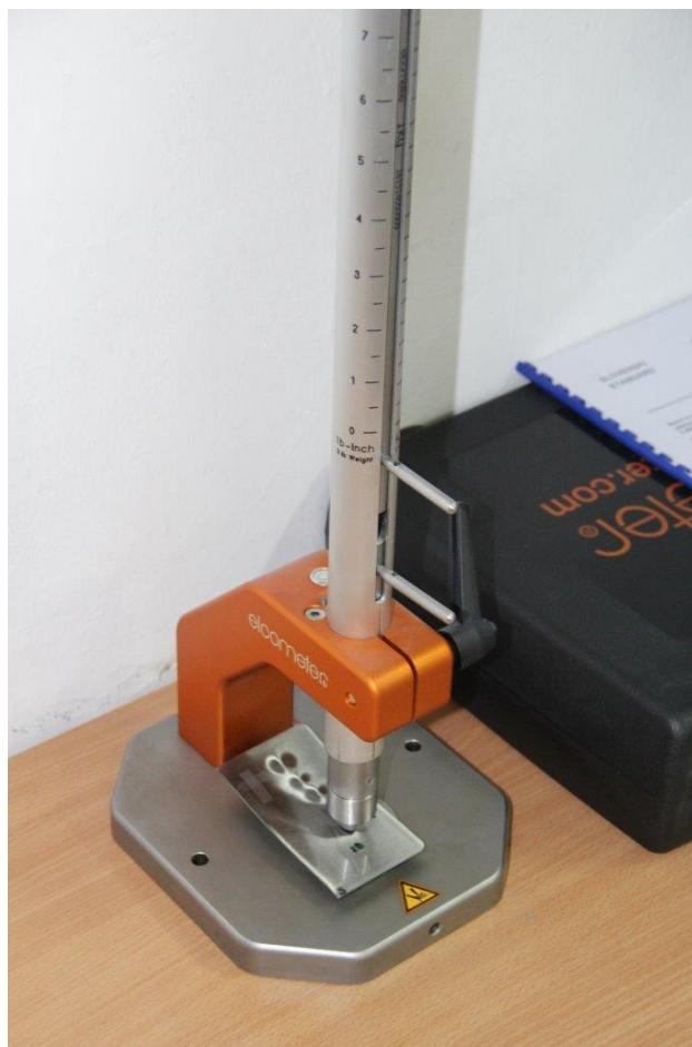
Slika 17: Ispitivanje otpornosti premaza na udar
