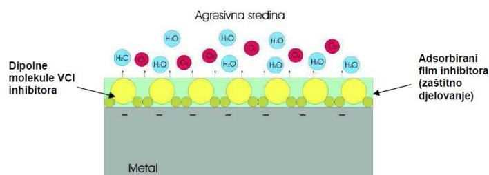
Slika 6: Mehanizam djelovanja hlapivog inhibitora korozije [1]
