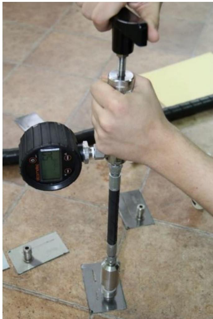
**Slika 36: Ispitivanje prionjivosti premaza vlačnom metodom (Pull-off) test**
