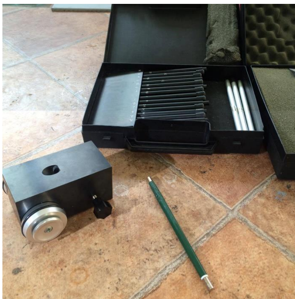
Slika 19: Set za mjerenje tvrdoće premaza
