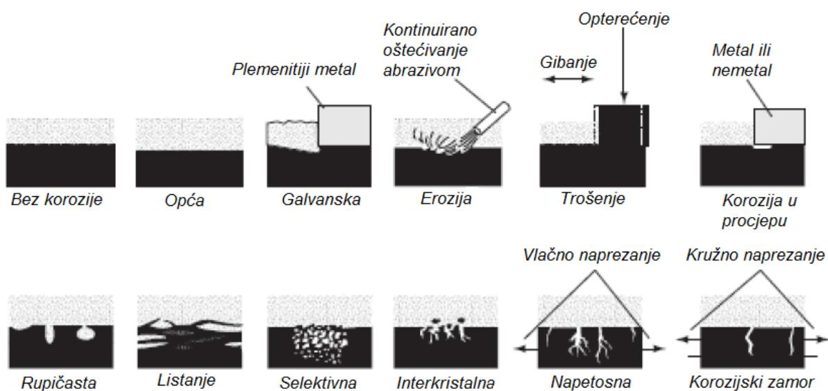
Slika 1: Vrste korozije [5]
