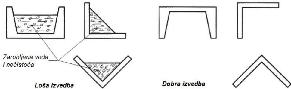
Slika 2: Primjer utjecaja oblikovanja i montaže konstrukcije na pojavu korozije [6]
