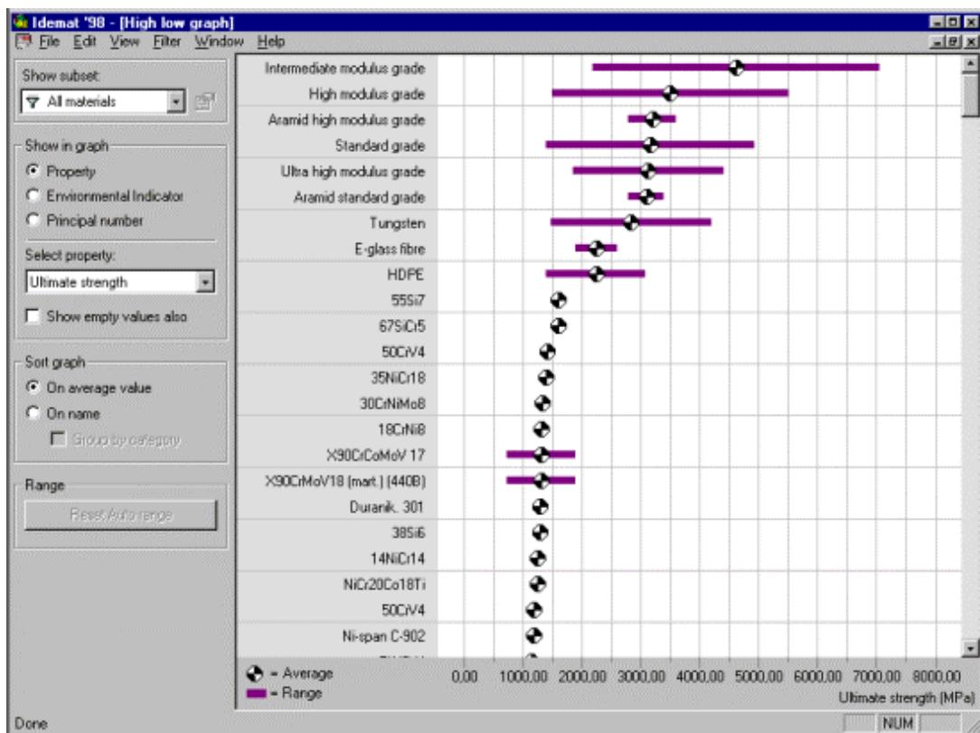
Slika 6.11.Grafička usporedba čvrstoće odabralih materijala u računalnoj aplikaciji IDEMAT [24]
