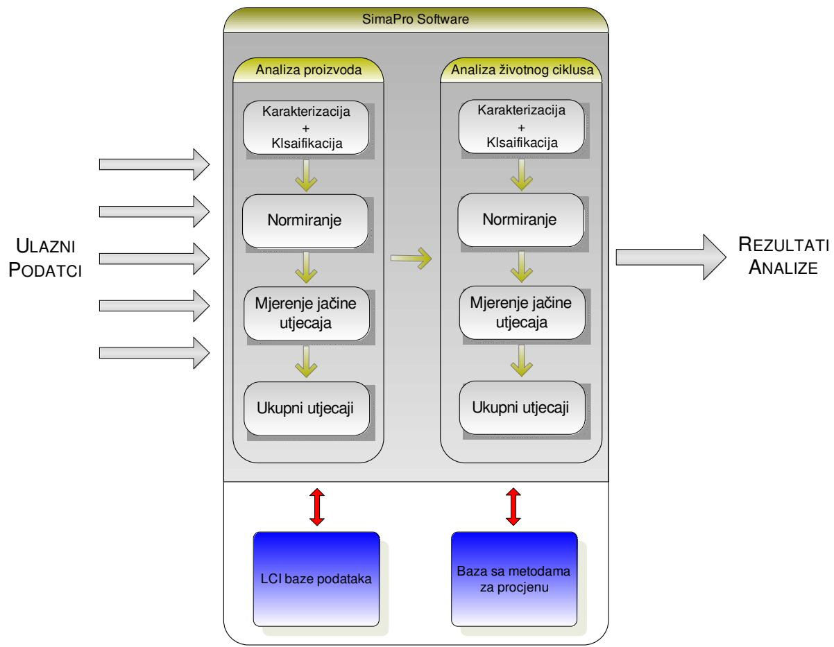
**Slika 6.4. Shematski prikaz principa rada "Sima-Pro" računalne aplikacije [2]**
