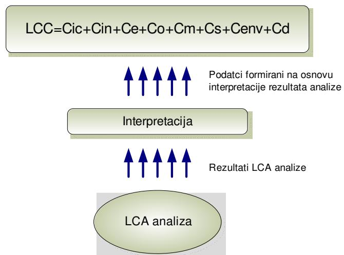
Slika 8.2. Shematski prikaz principa LCC metode [2]
