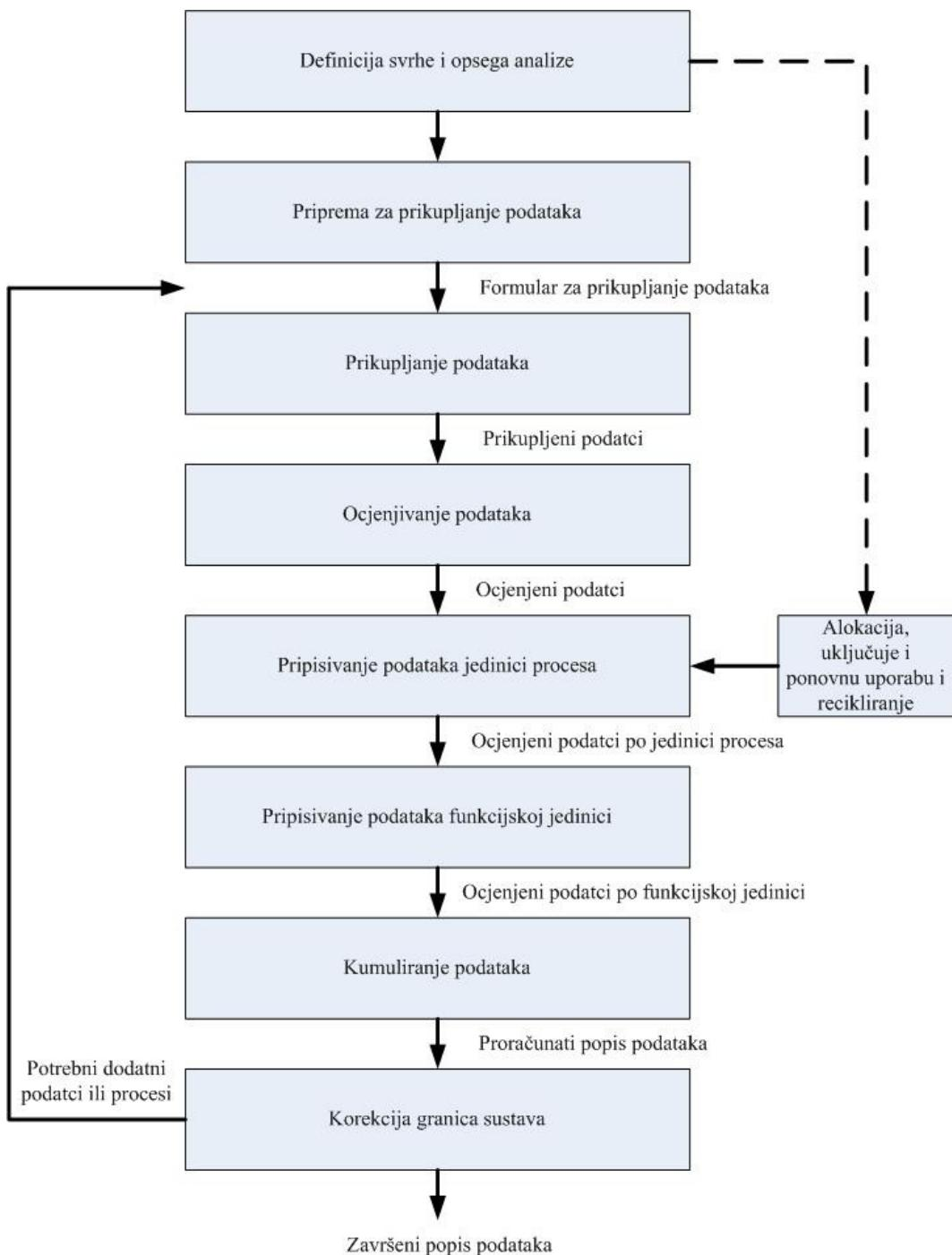
**Slika 5.8. Pojednostavljeni postupak provodenja faze prikupljanja i analize podataka**
