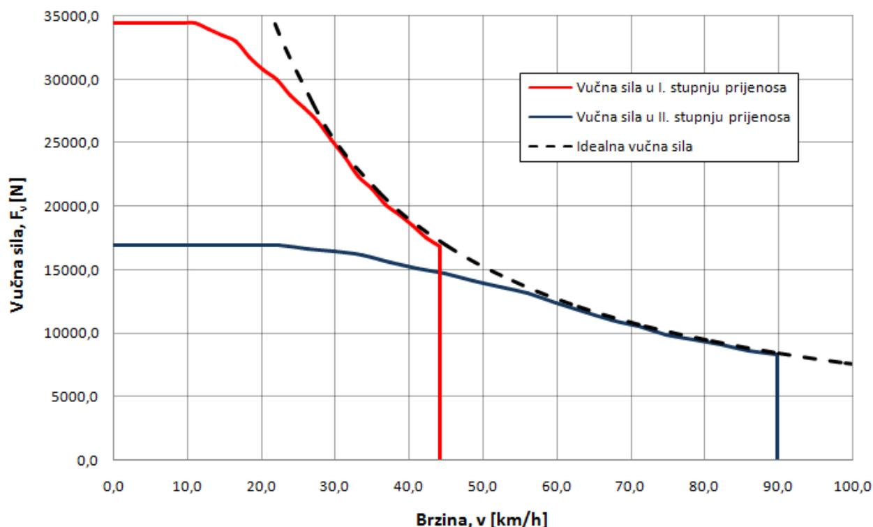
Slika 32. Vučni dijagram autobusa s električnim pogonom
