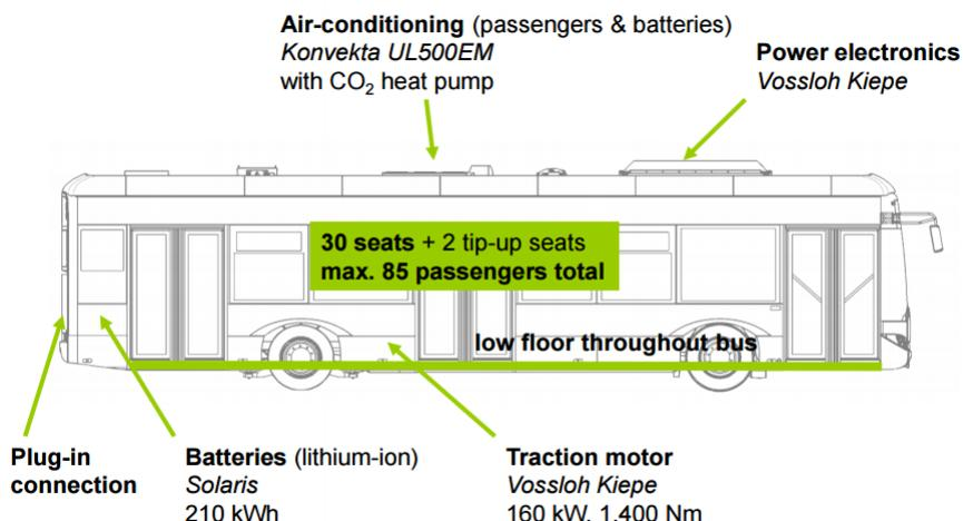
Slika 5. Solaris Urbino 12 Electric - Razmještaj komponenti [4]
