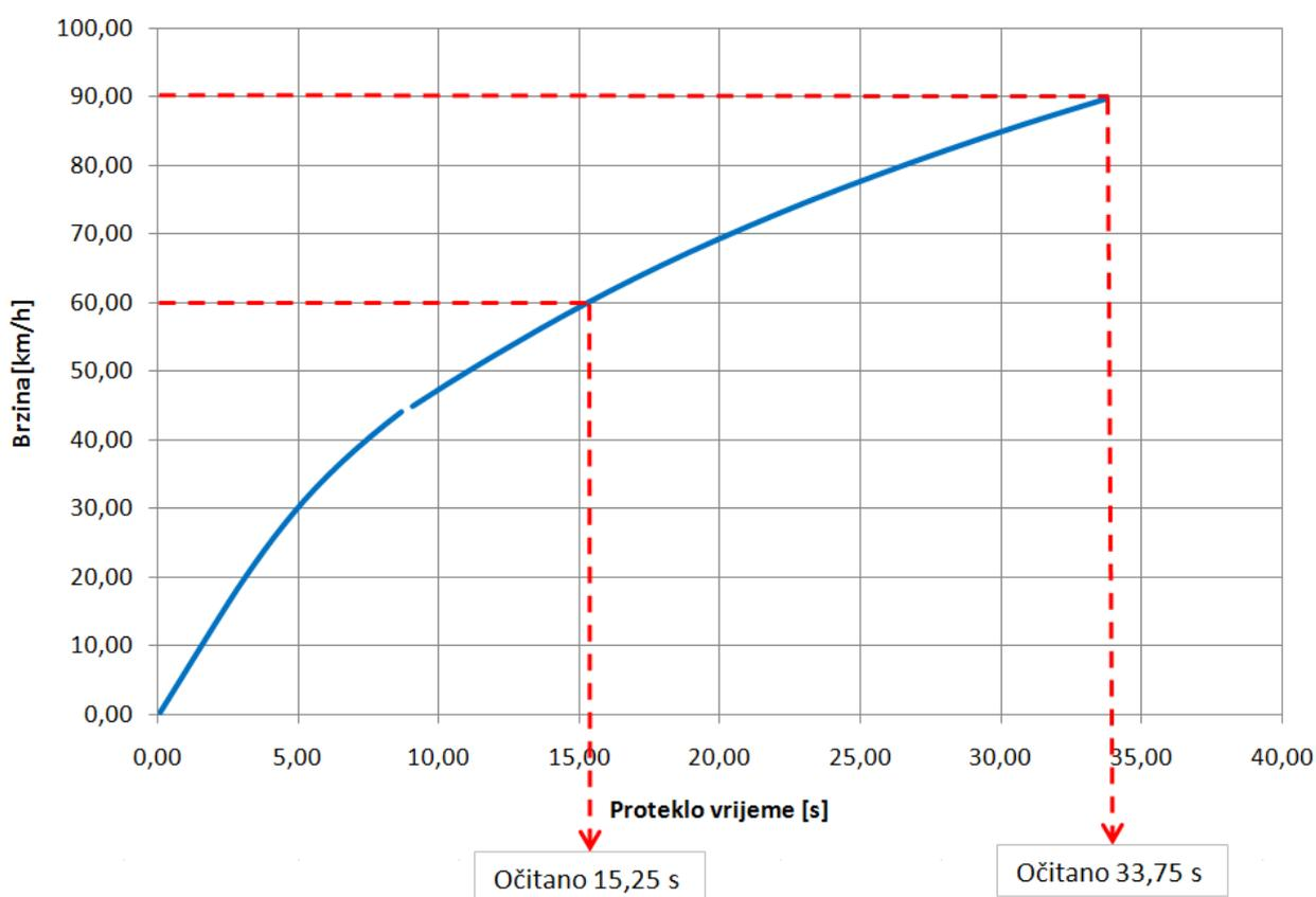
**Slika 36.** Ovisnost brzine vožnje o proteklom vremenu
