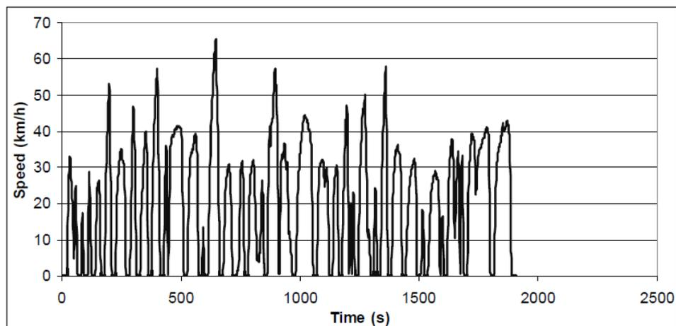
**Slika 12.** Promjena brzine u ovisnosti o vremenu za gradski ispitni vozni ciklus okruga Orange [9]
