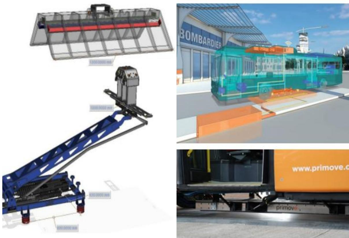
**Slika 10.** Oportunitetno punjenje putem pantografa (lijevo) i elektromagnetskom indukcijom (desno) [8]
