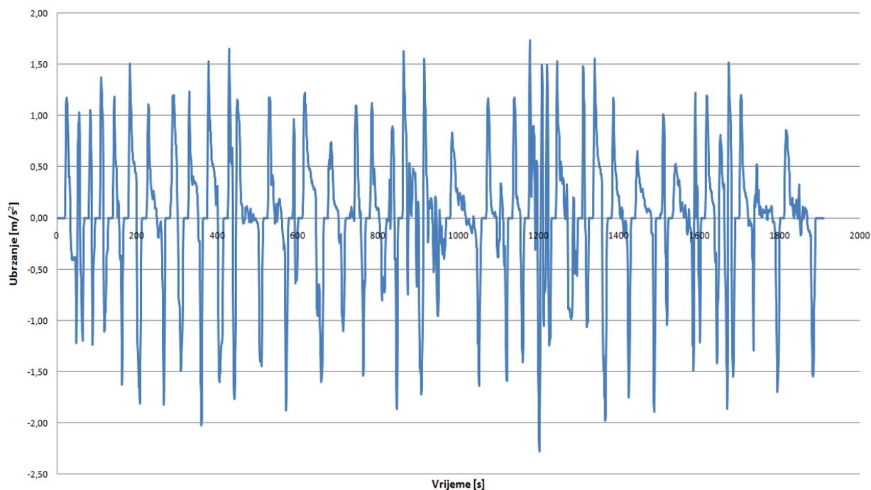
**Slika 27.** Dijagram profila ubrzanja za ispitni vozni ciklus za autobuse okruga Orange
