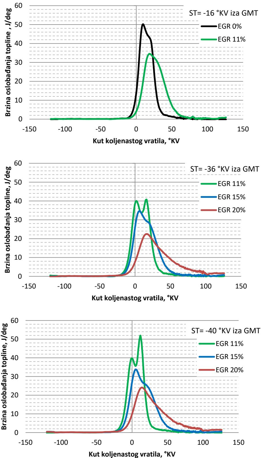
**Slika 25** Ovisnost brzine oslobođanja topline (ROHR) o kutu koljenastog vratila za isti kut paljenja i različite udjele EGR-a.
