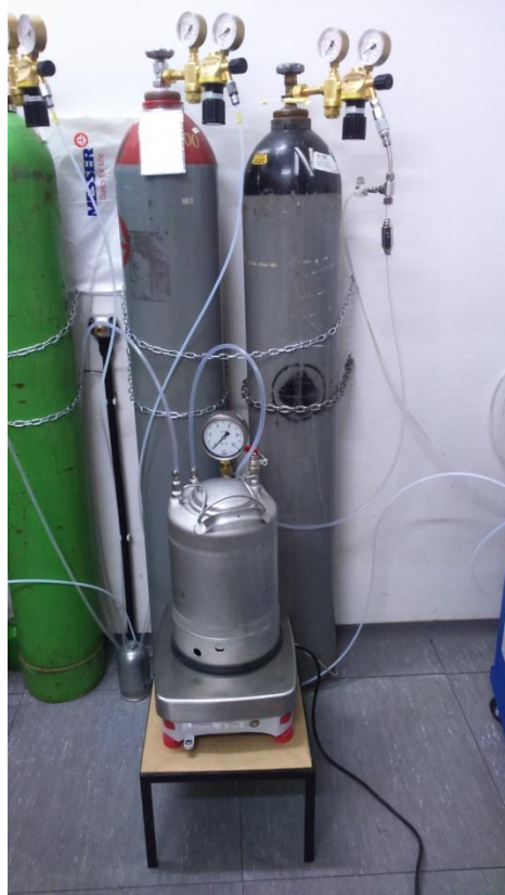
Slika 12 Spremnik goriva na vagi i boca s dušikom.
