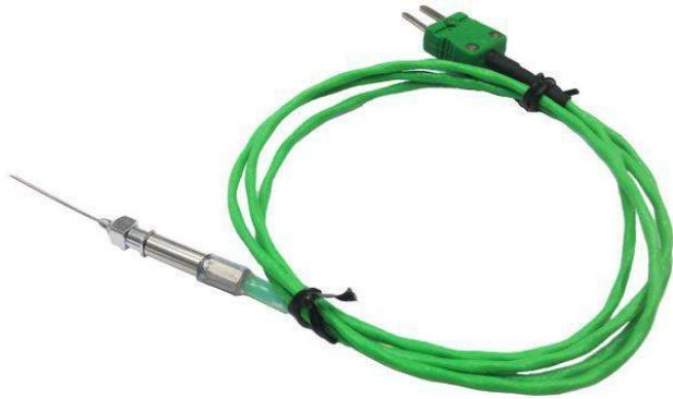
**Slika 10** Električni termopar tip K.
