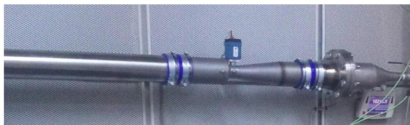
**Slika 11** Anemometar s ugrijanom žicom, Model 2017L-V.
