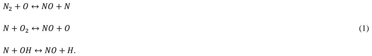
Formacija NO<sub>x</sub> spojeva može se opisati eksponencijalnom funkcijom. Brzina formacije NO<sub>x</sub> spojeva može se opisati jednadžbom 2 iz koje proizlazi da se smanjenje emisije NO<sub>x</sub> spojeva postiže smanjenjem temperature i koncentracije kisika u komori za izgaranje.
