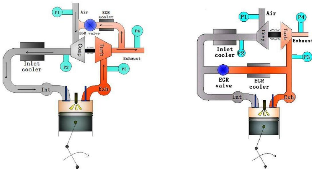
**Slika 2** Niskotlačni (lijevo) i visokotlačni (desno) EGR sustav [1].
