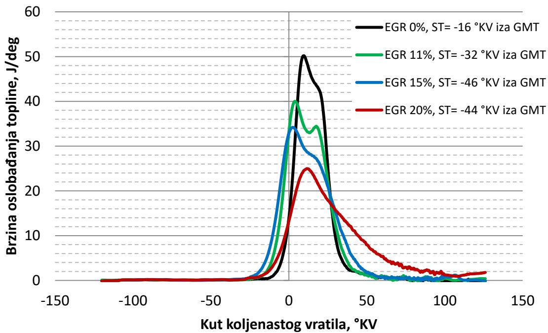
Slika 27 Ovisnost brzine oslobođanja topline (ROHR) о куту колjenastog вратила за оптимални кут палива.
