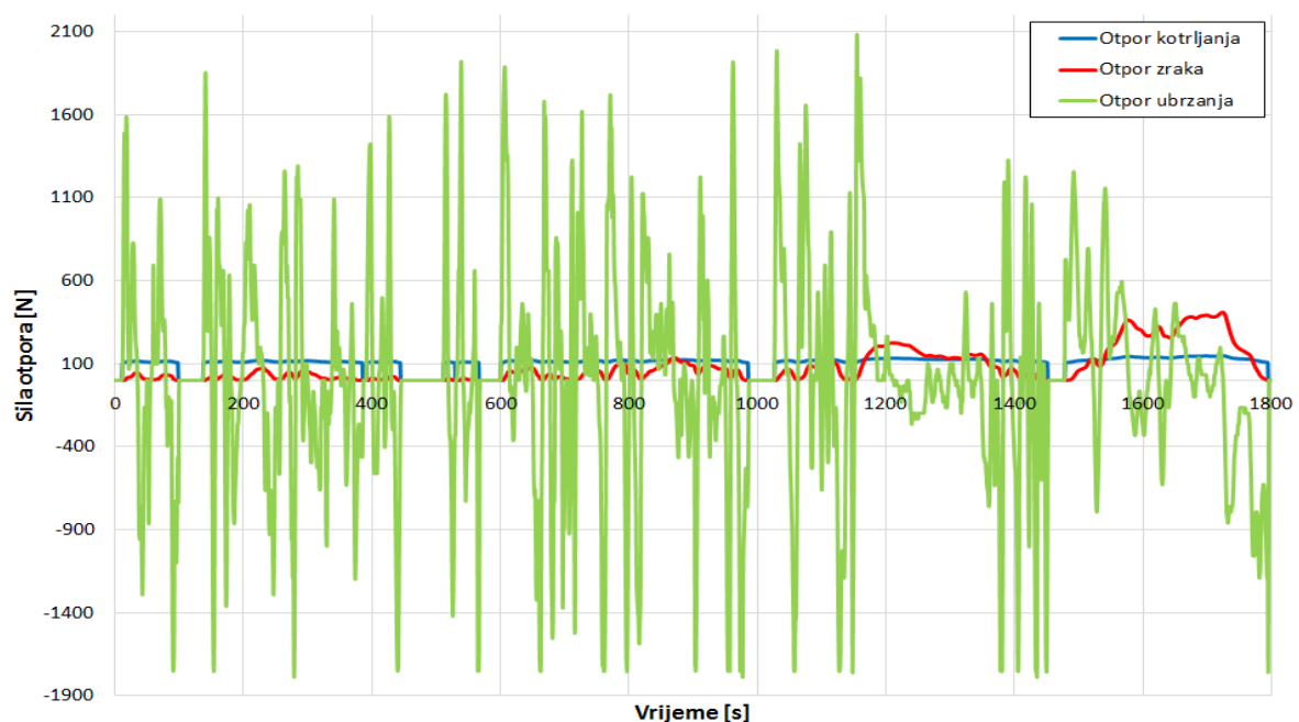
Slika 4.1. Sile pojedinih otpora vožnje električnog vozila
