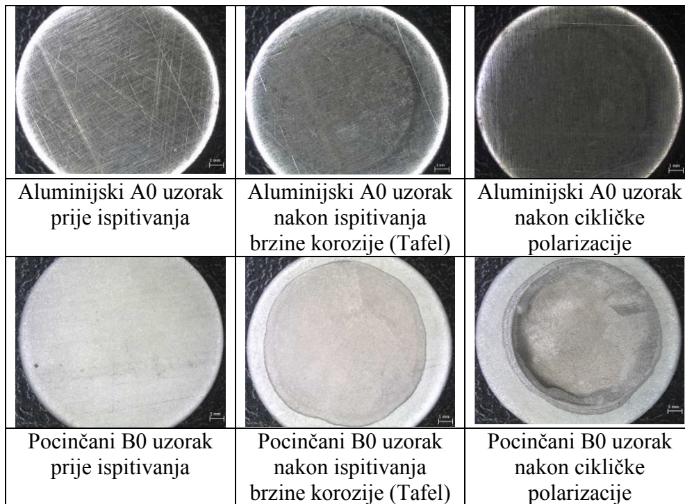
Slika 65. Izgled nezaštićenih uzoraka prije i nakon elektrokemijskih ispitivanja [17]
