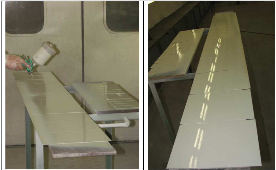
Slika 38. Nanošenje međuslojnog premaza [17]
