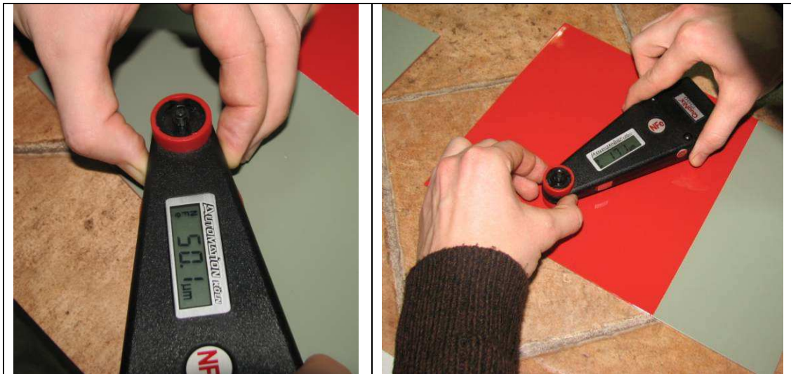
Slika 46. Mjerenje debljine prevlake po slojevima [17]
