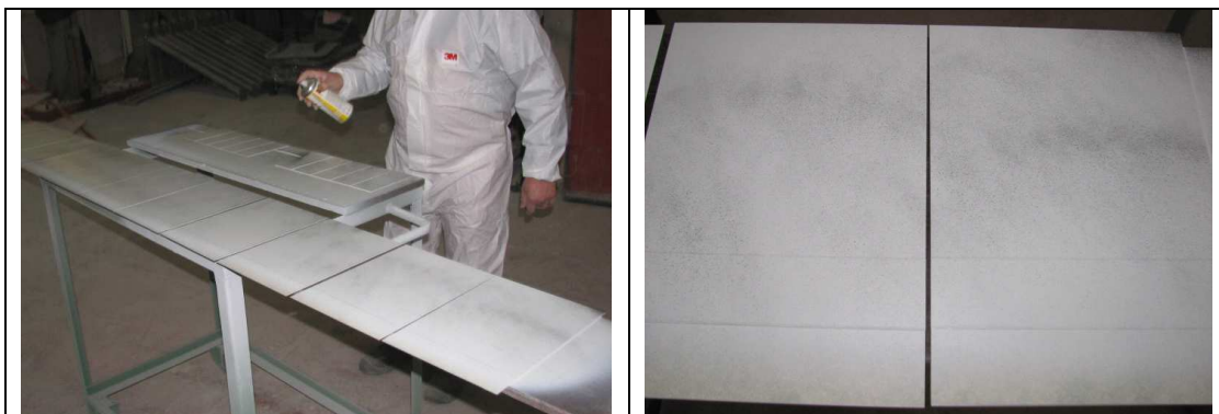
Slika 39. Nanošenje kontrolnog praška [17]
