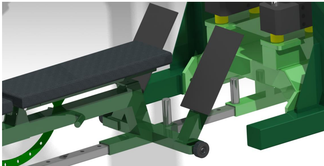
Slika 87. Sustav za vođenje sjedala sprave pogled 1
