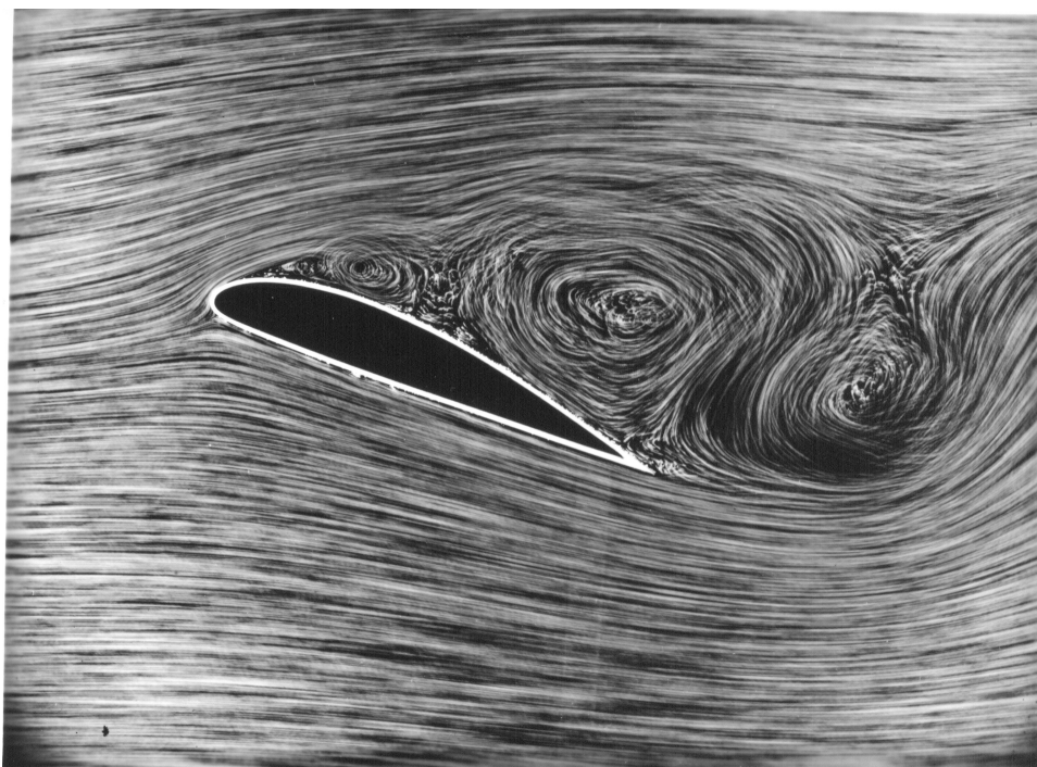
Slika 4: Odvajanje strujanja pri velikim napadnim kutevima.
