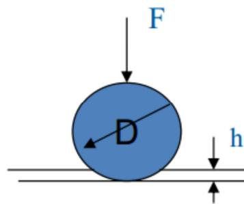
Slika 3.5.1 Mjerjenje tvrdoće [9]
