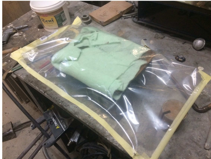
Slika 3.3.5 Pripremanje kalupa za vakuumiranje
