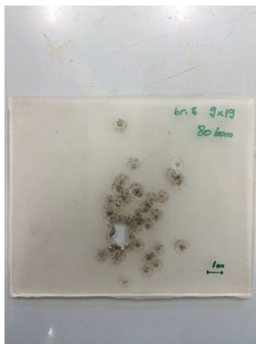
Slika 3.6.3 Ploča 3 prostrijeljena je s 80 hitaca pištoljem, zrnom 9x19 mm.
