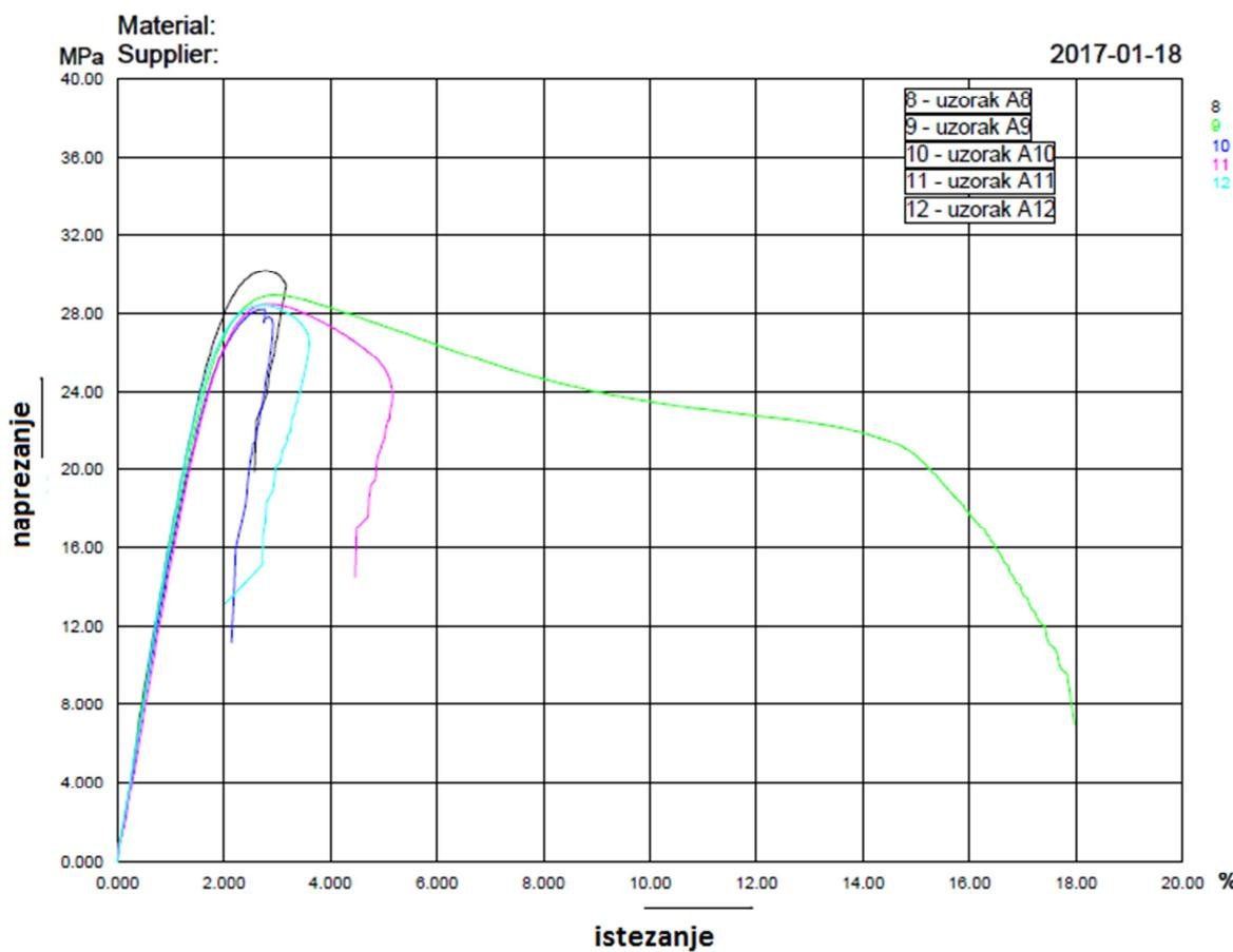
**Slika 4.1 Dijagram naprezanje-istezanje za epruvete uzorka A (nepropucana ABS meta)**
