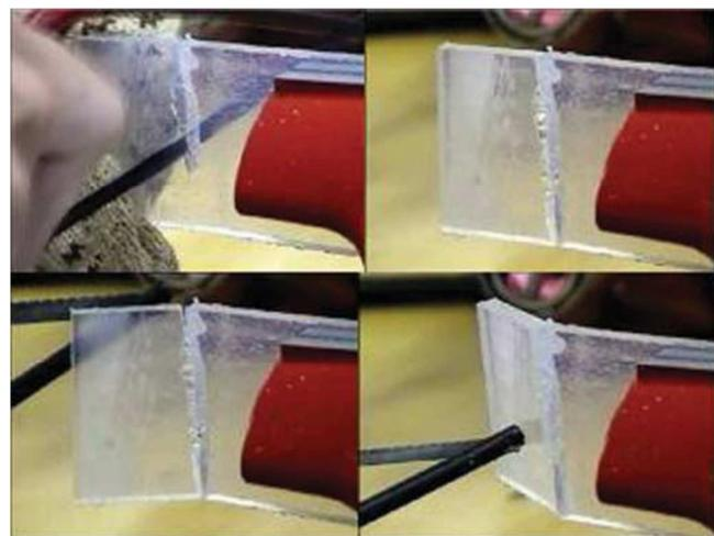
Slika 2.4.4.1 Zacjeljivanje kod postupka rezanja ručnom pilom [1]
