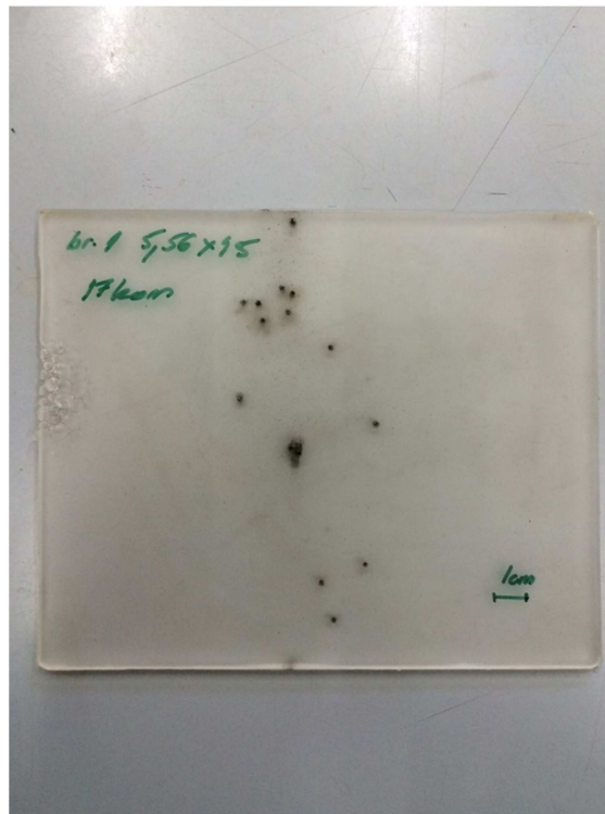
Slika 3.6.4 Ploča 4 prostrijeljena je s 20 hitaca iz puške, zrnem 5,56x45 mm.
