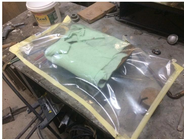
Slika 3.3.5 Pripremanje kalupa za vakuumiranje
