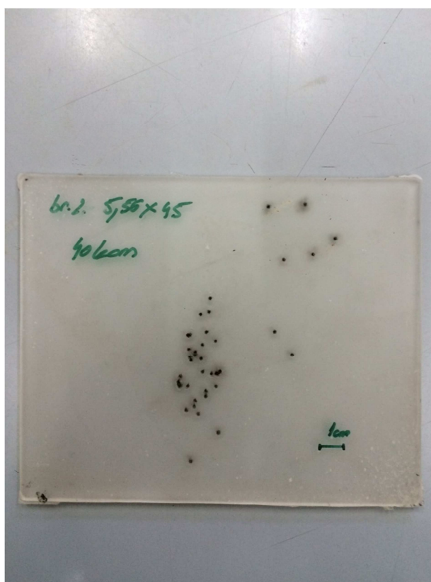
Slika 3.6.5 Ploča 5 prostrijeljena je s 40 hitaca iz puške, zrnem 5,56x45 mm.
