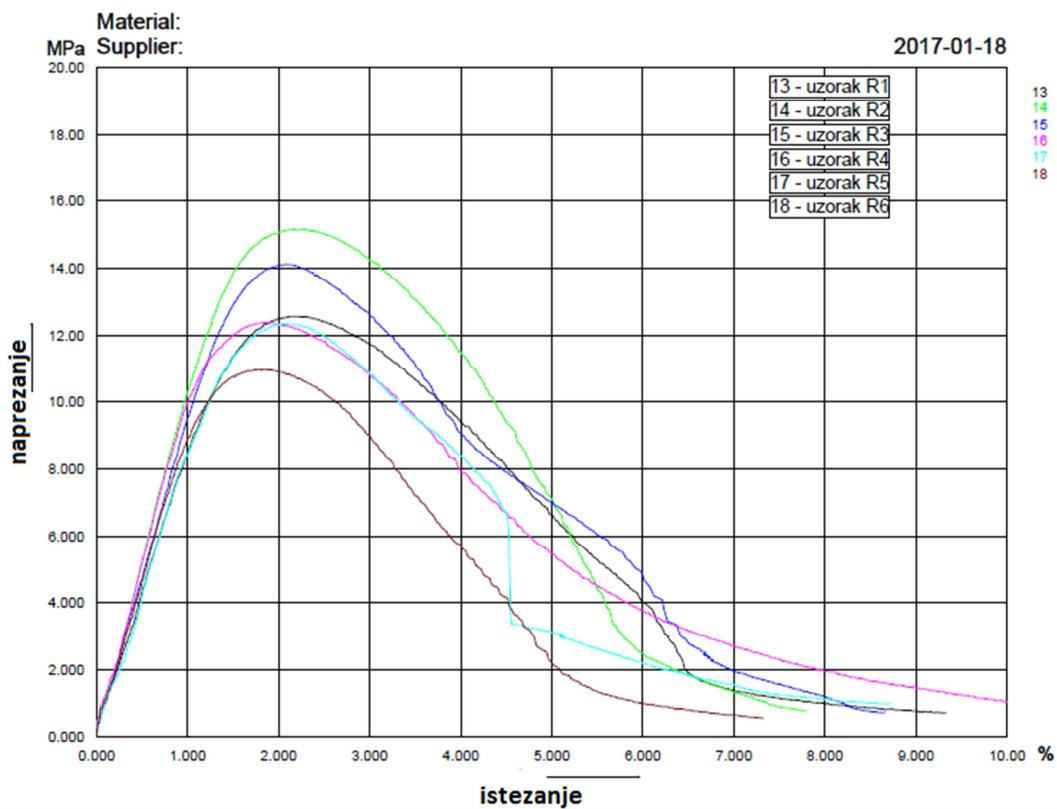
**Slika 4.2 Dijagram naprezanje-istezanje za epruvete uzorka R (ABS prostrijeljen s 9 mm)**
