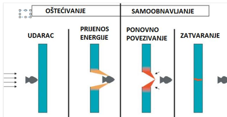
Slika 2.7.1 Mechanizam samoobnavljanja uslijed balističkog oštećenja [1]
