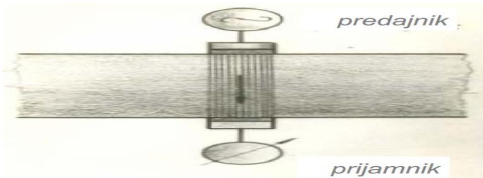
Slika 8. Metoda prozvučavanje uzorka [5]
