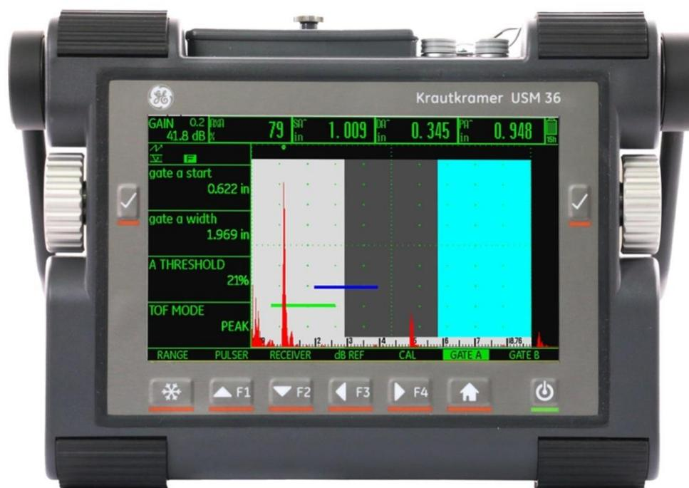
**Slika 14. Uređaj za mjerenje ultrazvuka USM 36 Krautkramer [8]**
