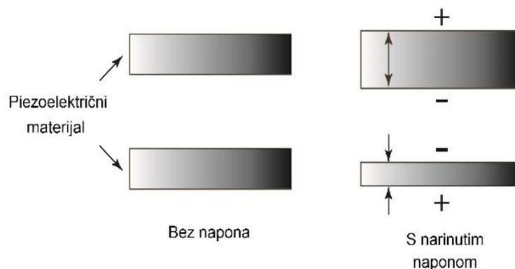
Slika 3. Piezoelektrični efekt [5]
