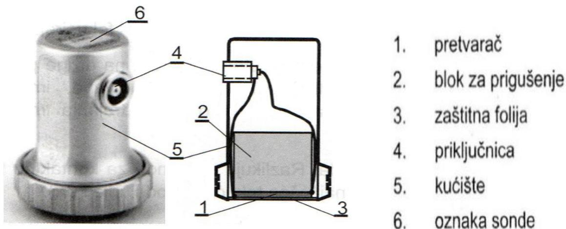
Slika 15. Dijelovi ravne sonde [3]
