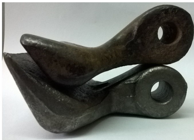
Slika 31. Usporedba korištenog i nekorištenog noža malčera
