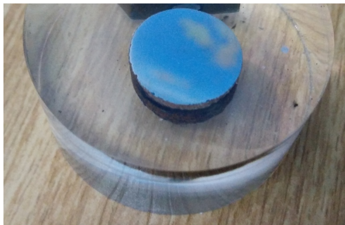
Slika 43. Uzorak vijka u polimernom kalupu
