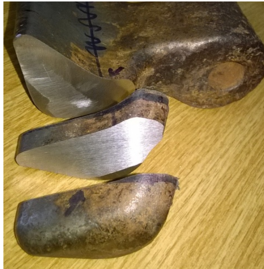
Slika 35. Odrezani uzorak noža malčera za analizu
