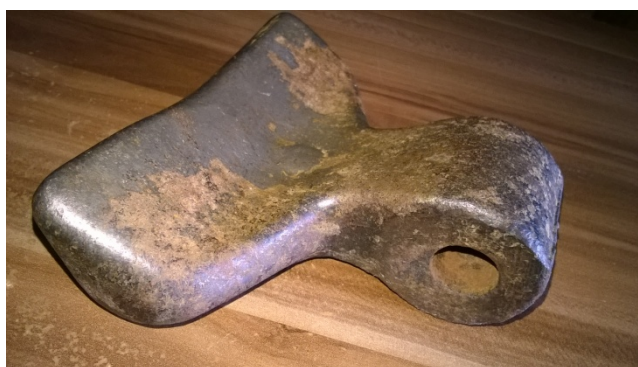
Slika 30. Korišteni nož malčera
