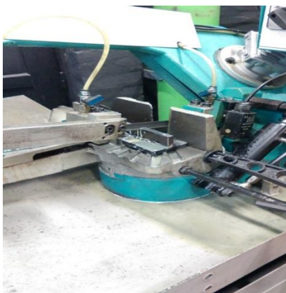
Slika 30. Rezanje makroizbruska tračnom pilom
