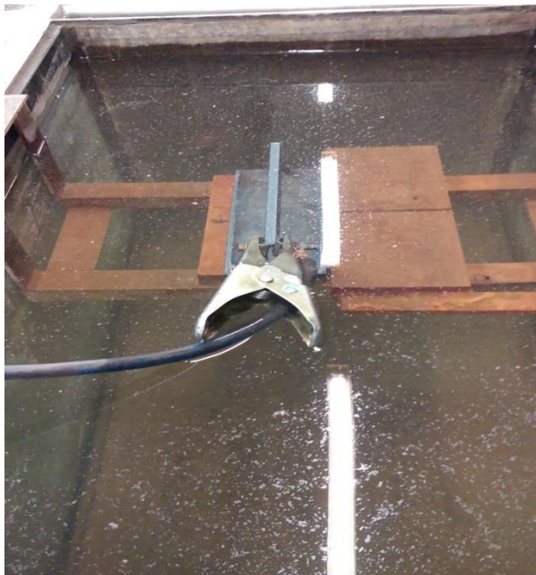
Slika 24. Kutni spoj pripremljen za zavarivanje
