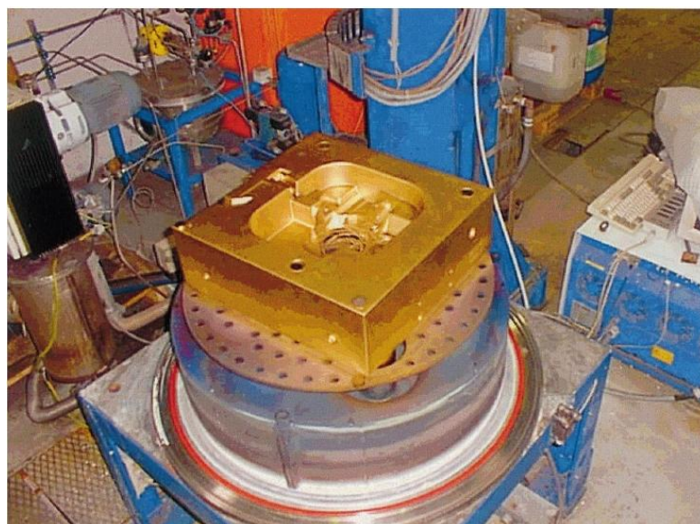
Slika 21 Polovica kalupa za tlačni lijev aluminijskih legura prevučena TiN prevlakom [16]
