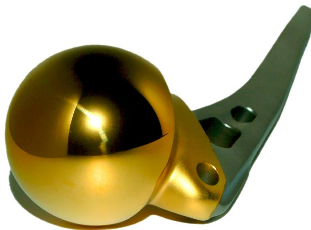
Slika 19 Implantat za umjetni kuk dodatno zaštićem prevlakom TiN[22]
