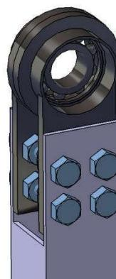
**Slika 17. Kućište ležaja**
