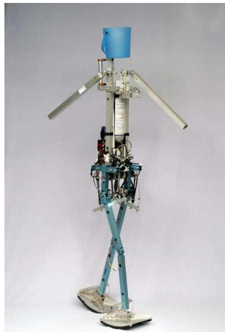
**Slika 11. Pneumatski humanoidni robot Denise sveučilišta TU Delft**
