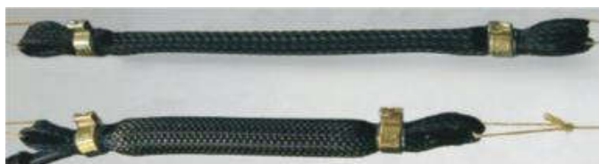
Slika 23. McKibbenov pneumatski mišić
