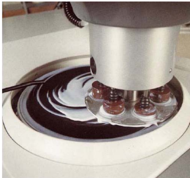
Slika 34.b Uređaj za završno fino poliranje istovremeno više uzoraka [11 ]
