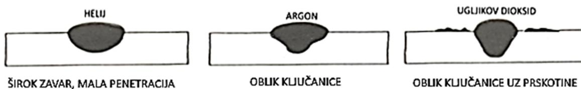
Slika 15. Utjecaj plinova na geometriju zavara [5]
