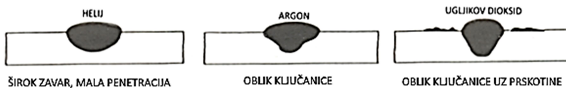
Slika 15. Utjecaj plinova na geometriju zavara [5]
