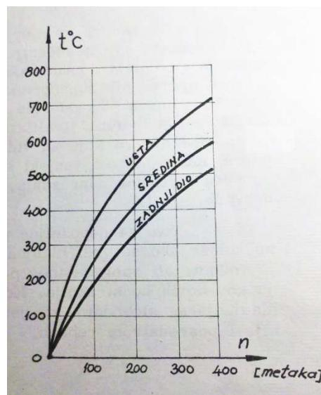
Slika 9. Promjena temperature po presjeku cijevi [17]
