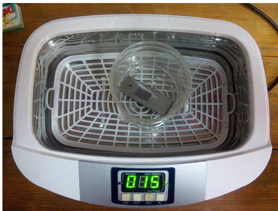
Slika 29. Uređaj za ultrazvučno čišćenje
