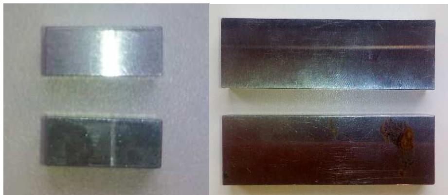
**Slika 15. Ispitni uzorci u nemodificiranom stanju**
