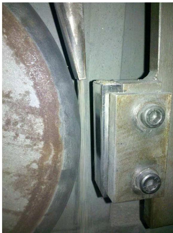
Slika 26. Detalj uređaja i trag trošenja na uzorku [1]
