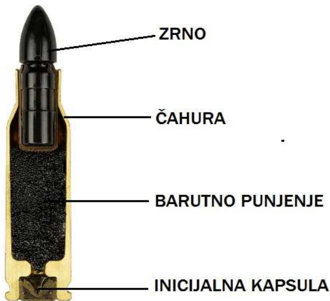
Slika 6. Poprečni presjek metka [1]
