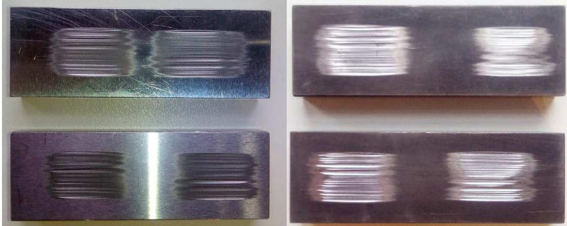
**Slika 27. Ispitni uzorak nakon ispitivanja otpornosti na abraziju**
