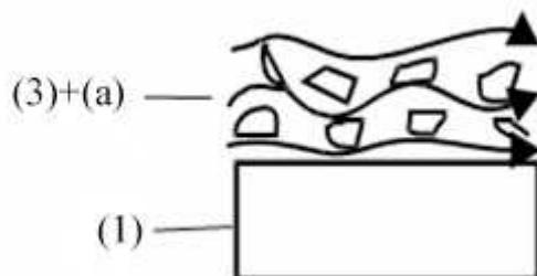
Slika 13. Shematski prikaz erozije česticama [11]
