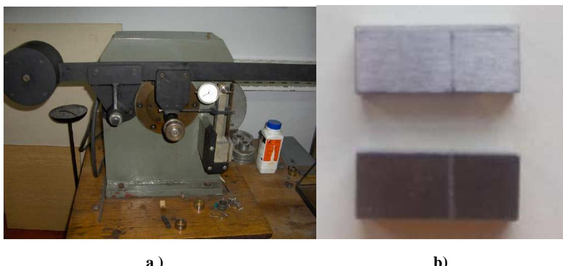
**Slika 31.** a) uredaj za ispitivanje otpornosti na adhezijsko trošenje b) ispitni uzorci nakon ispitivanja otpornosti na adhezijsko trošenje
