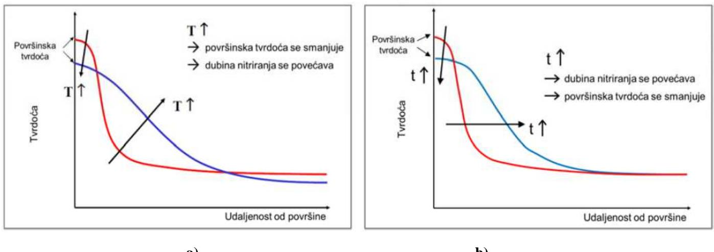
**Slika 23. a) Utjecaj temperature nitriranja, b) vremena nitriranja na tvrdoću i dubinu nitriranog sloja [2]**
