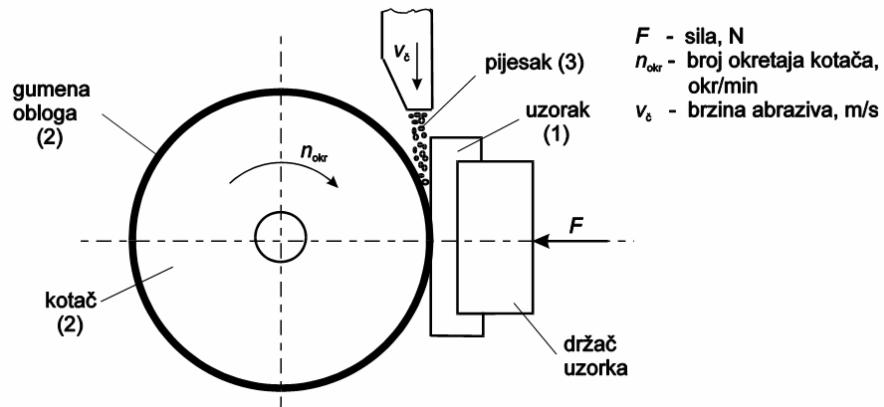
Slika 24. Skica uređaja "suhu pjesak/gumeni kotač" [11]
