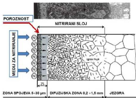
Slika 17. Mikrostruktura nitriranog sloja nakon nitriranja [4]
