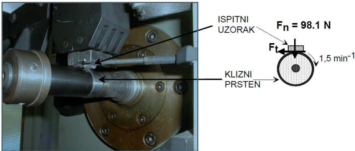
**Slika 30.** Uredaj za ispitivanje faktora trenja i shematski prikaz ispitnog uzorka i prstena [7]
