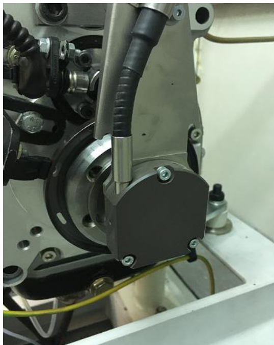
Slika 8. Senzor položaja koljenastog vratila
