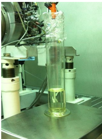
Slika 12. Mjerenje količine ubrizganog goriva
