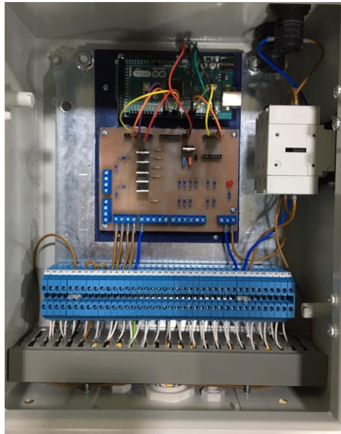
**Slika 40. Unutarnja ploča upravljačkog ormara s montiranim komponentama**
