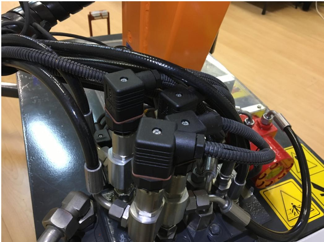
Slika 17. Ugrađeni senzori tlaka
