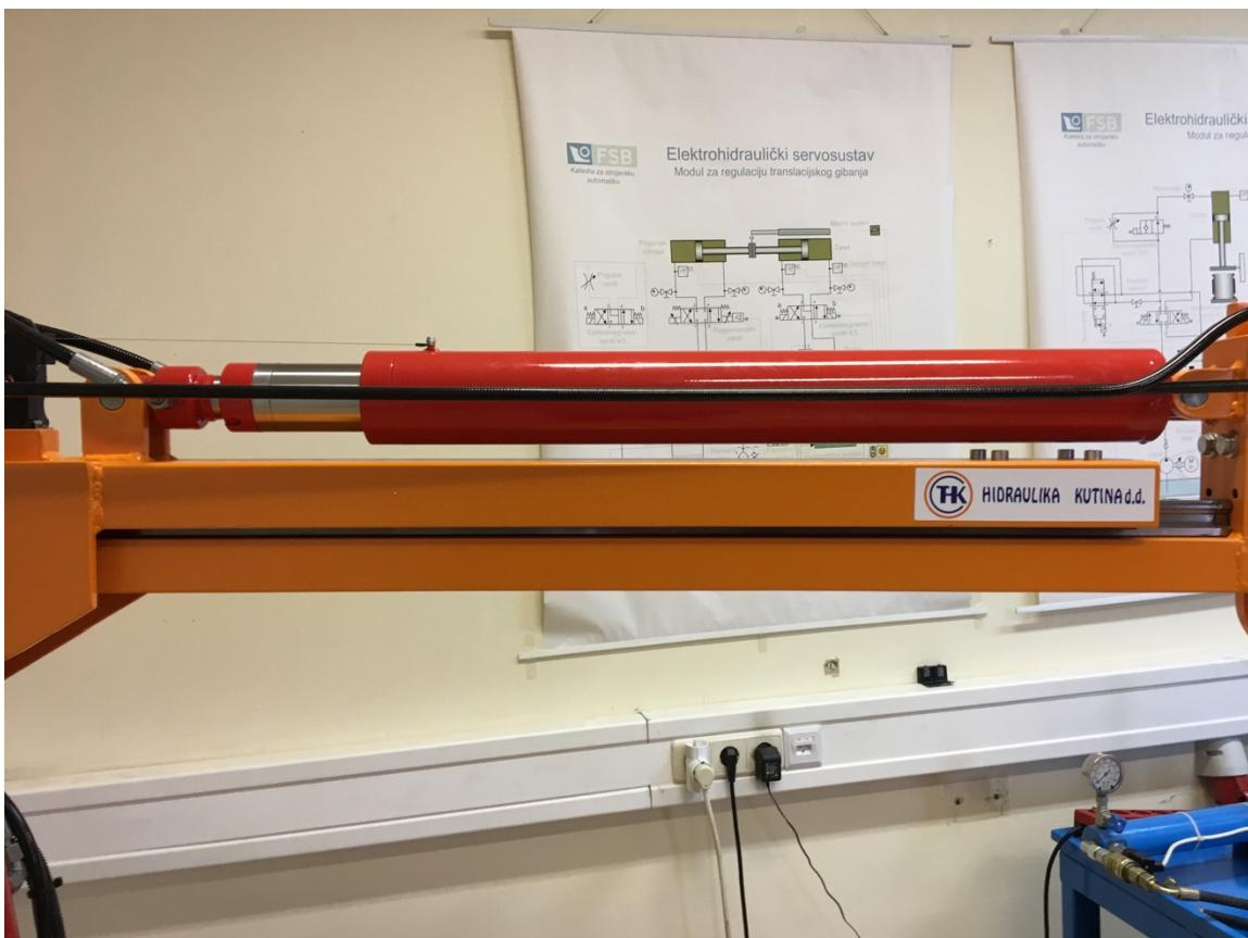
Slika 6. Teleskopski dvoradni hidraulički cilindar
