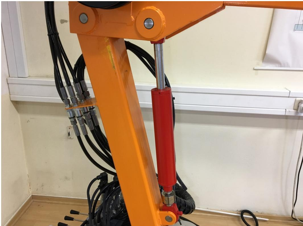
**Slika 5. Podizni dvoradni hidraulički cilindar ruke manipulatora**
