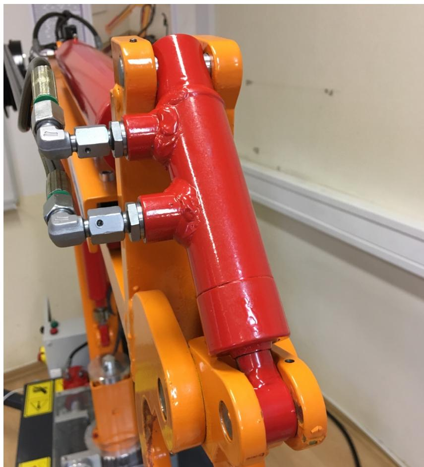
Slika 7. Hidraulički cilindar prihvavnice
