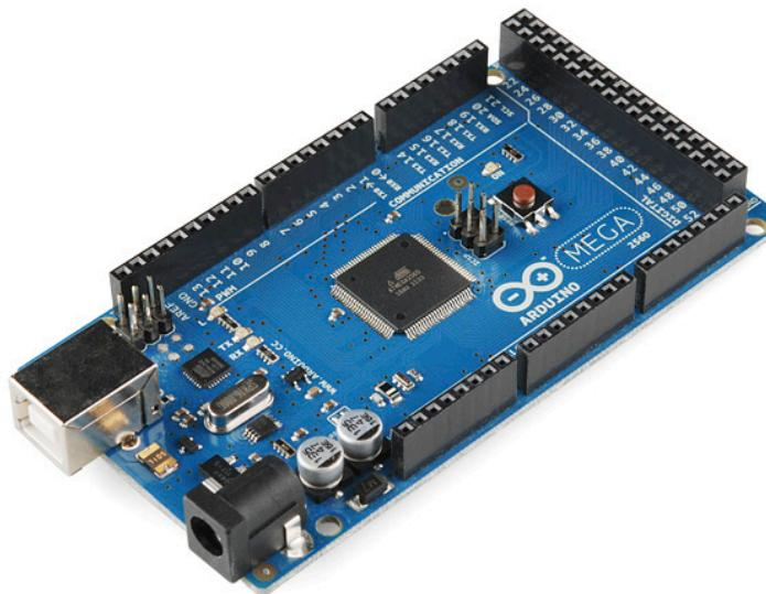
Slika 38 Arduino Mega 2560 mikrokontroler [11]
