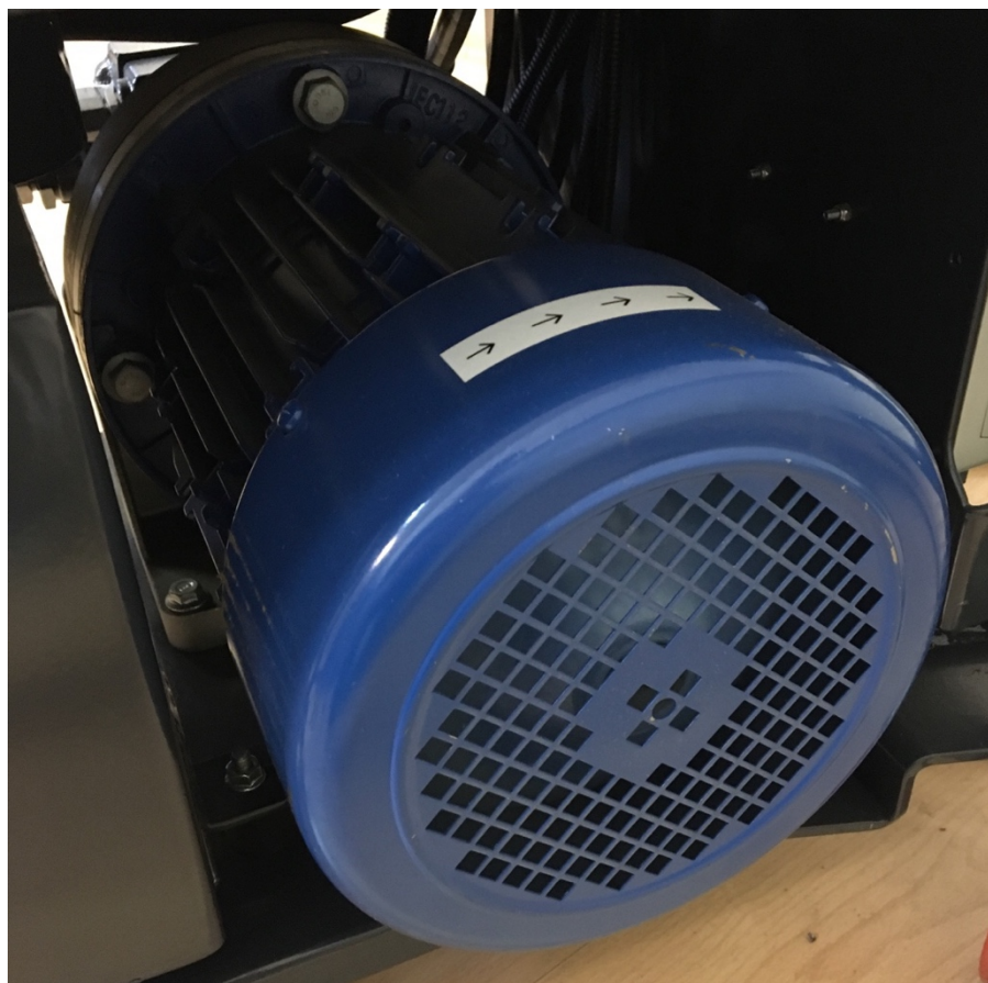
Slika 8. Ugrađeni trofazni asinkroni elektromotor
