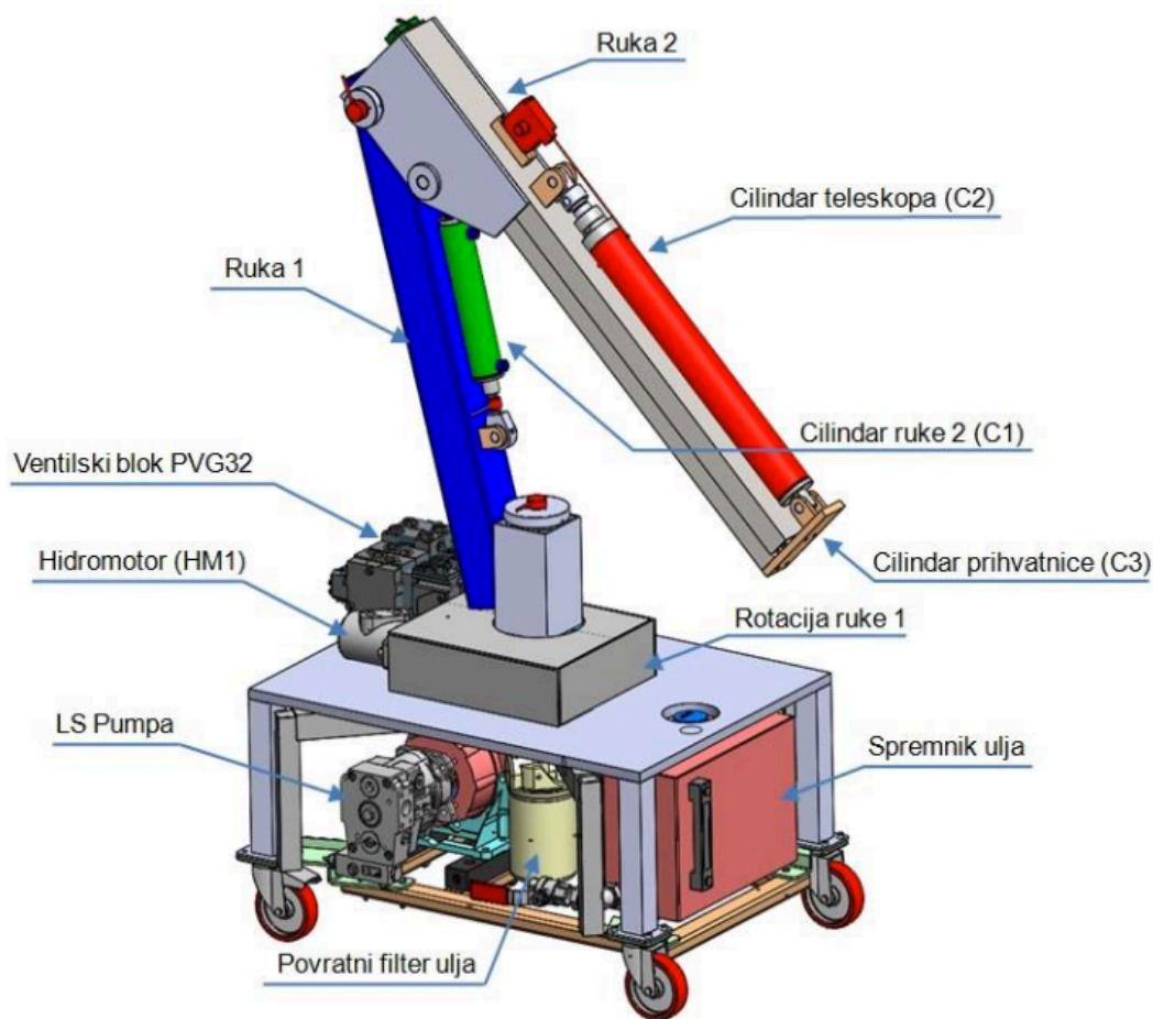
Slika 2. Glavne komponente elektrohidrauličkog robotskog manipulatora [2]
