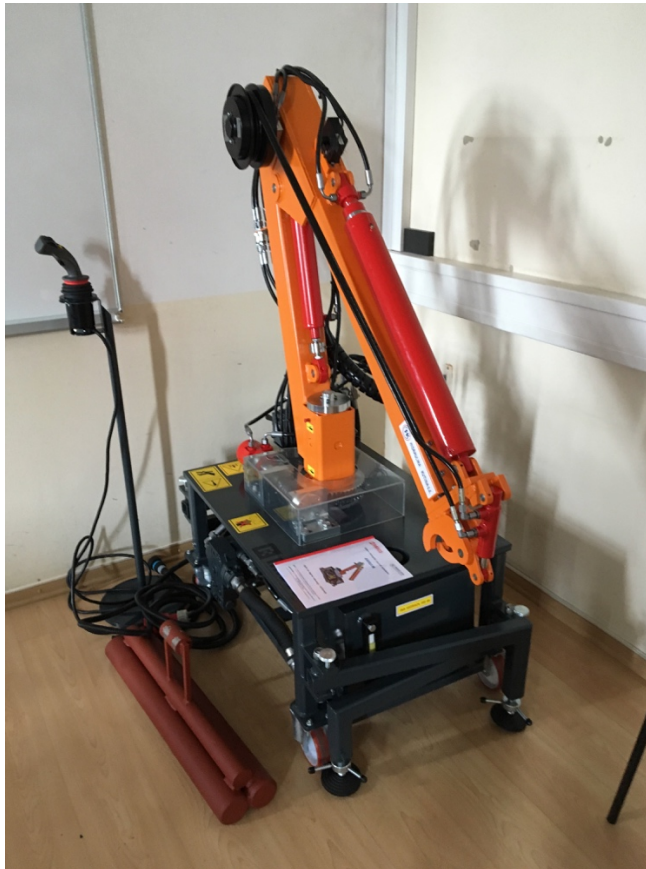
Slika 1. Elektrohidraulički robotski manipulator (EHROM)
