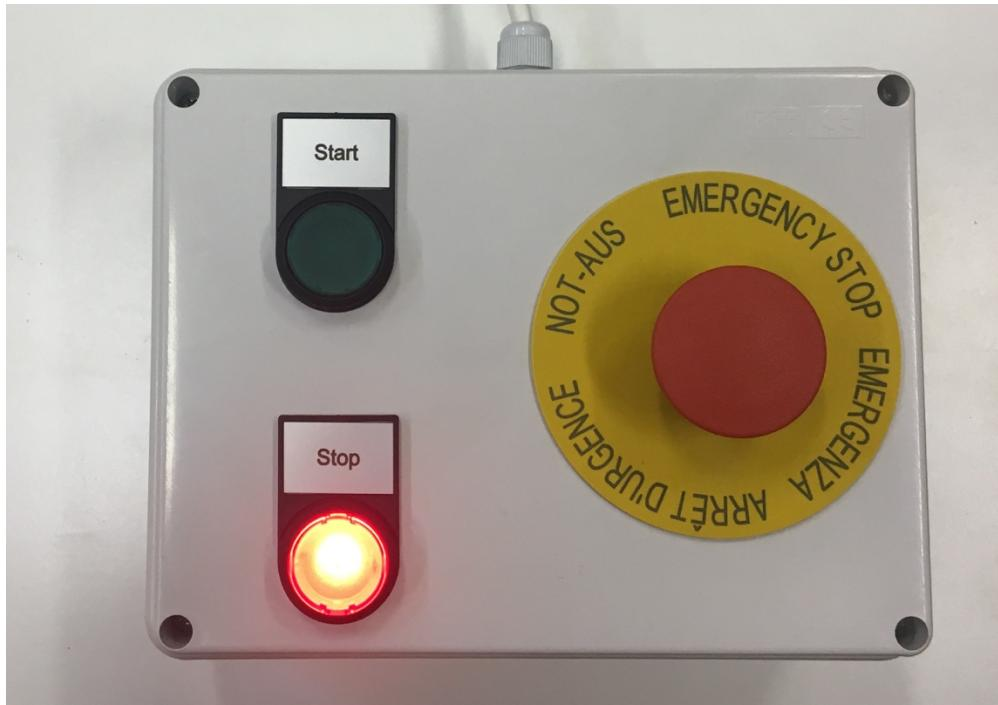
Slika 43. Signal isključenog napajanja ventilskog bloka
