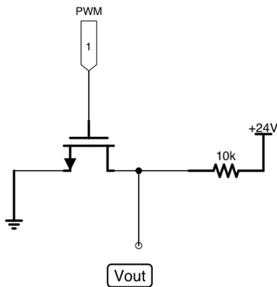
Slika 26. MOSFET spoj za pojačanje napona upravljačkih signala ventila
