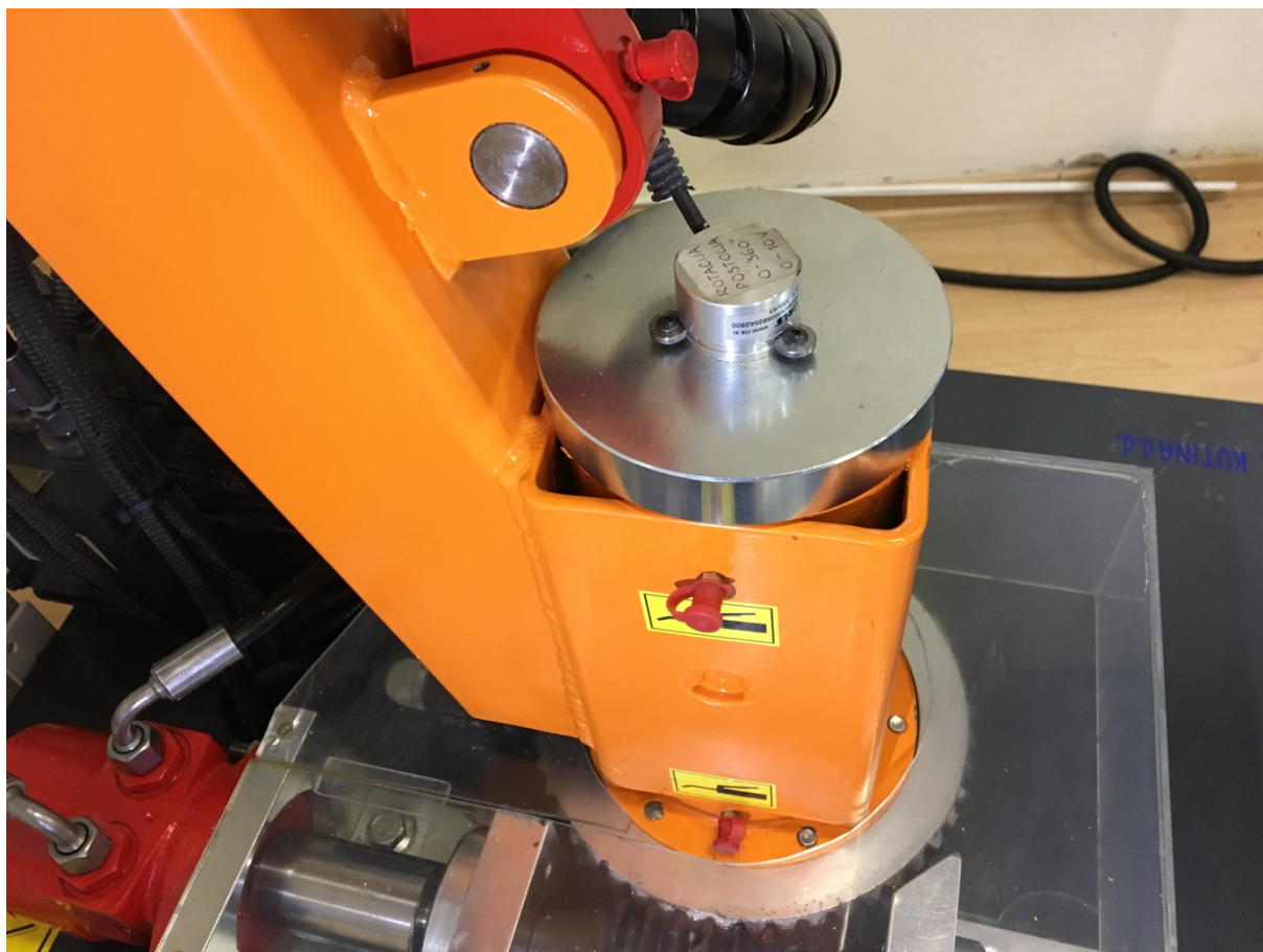
Slika 14. Rotacioni davač kuta zakreta postolja manipulatora
