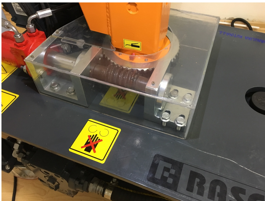
Slika 9. Spoj hidromotora i pužnog prijenosa za ostvarivanje rotacije postolja
