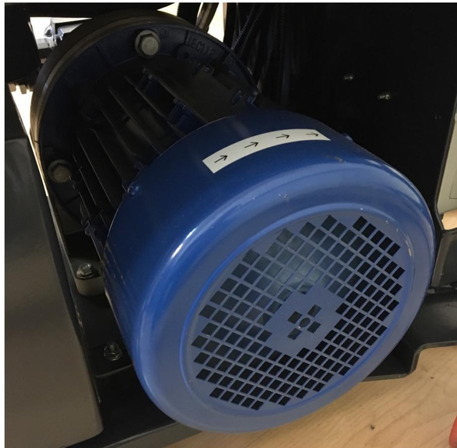
Slika 8. Ugrađeni trofazni asinkroni elektromotor
