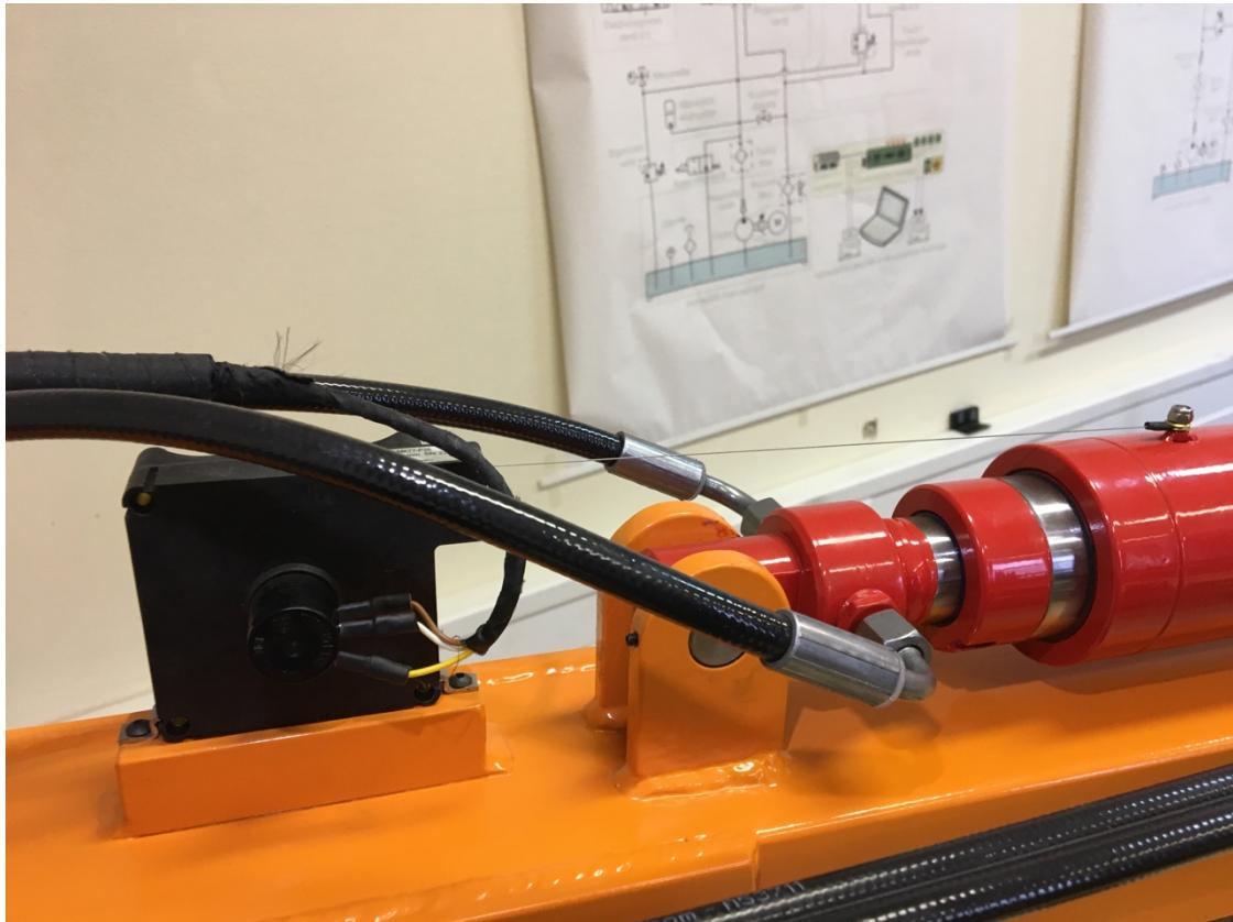
**Slika 16. Linearni potenciometar s djelomično izvučenom poteznom niti**
