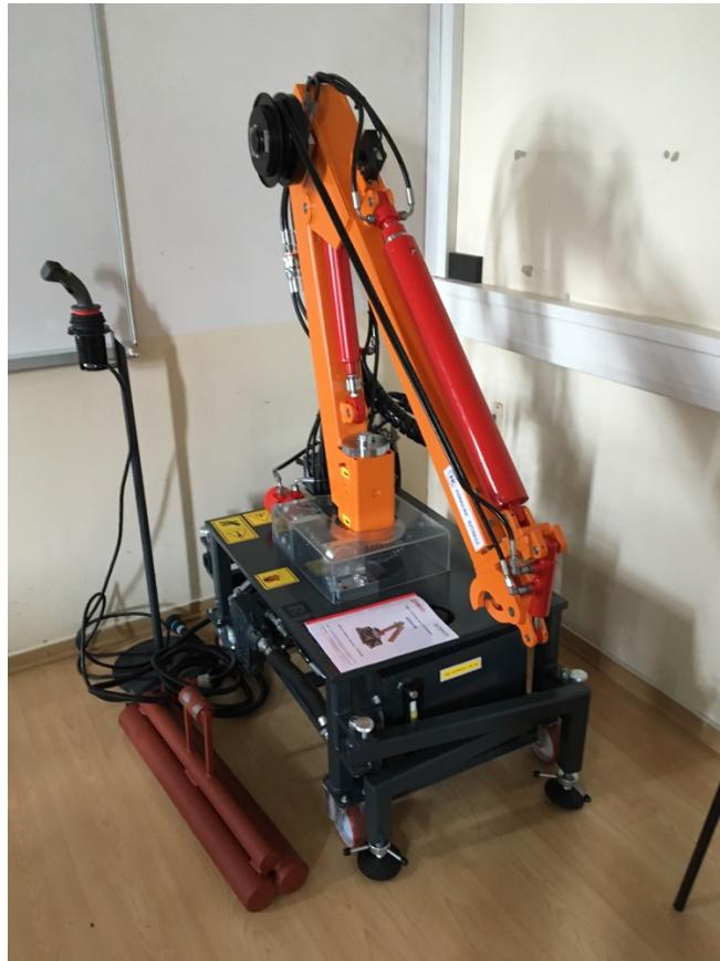
Slika 1. Elektrohidraulički robotski manipulator (EHROM)
