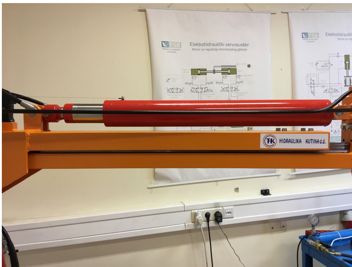
Slika 6. Teleskopski dvoradni hidraulički cilindar
