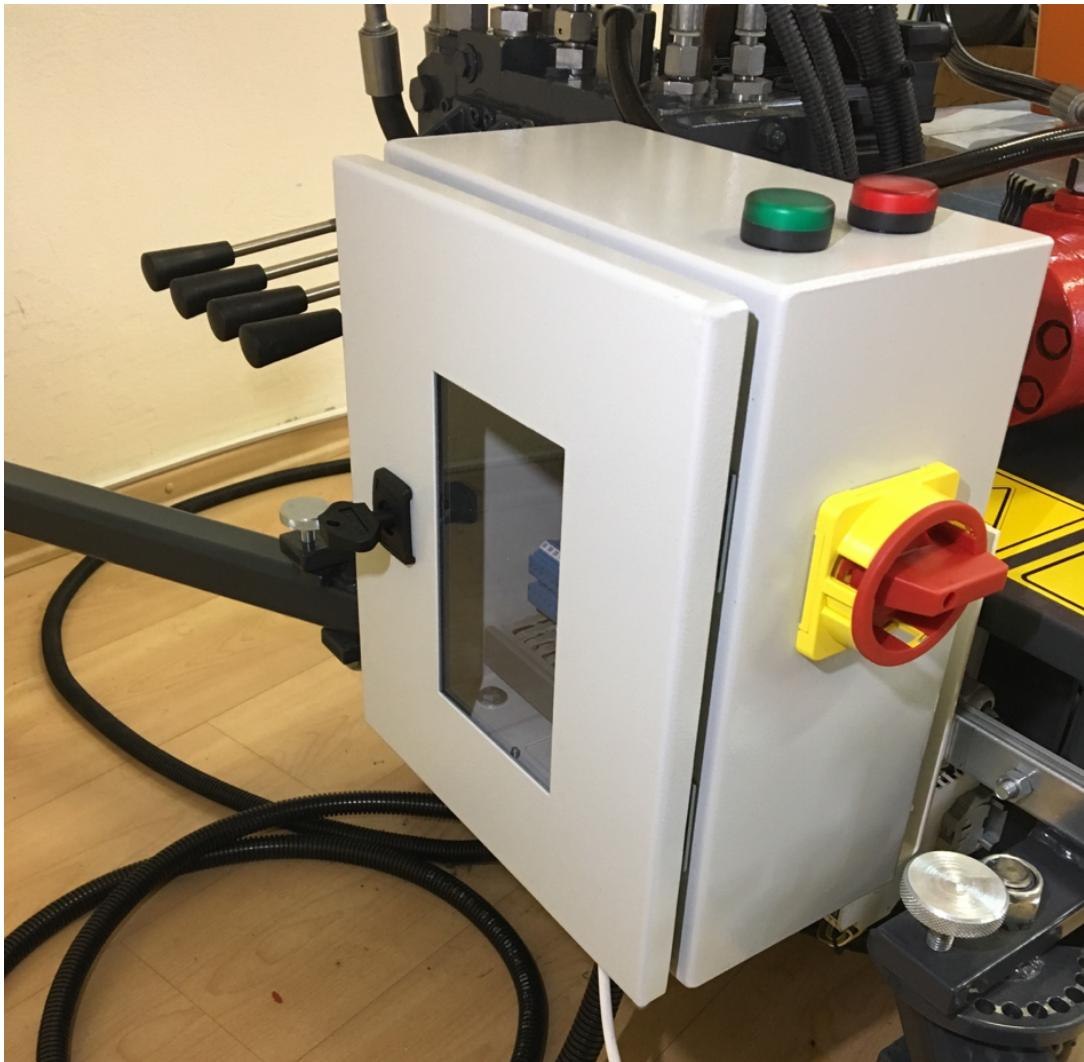
Slika 39. Upravljački ormari ugrađeni na manipulator
