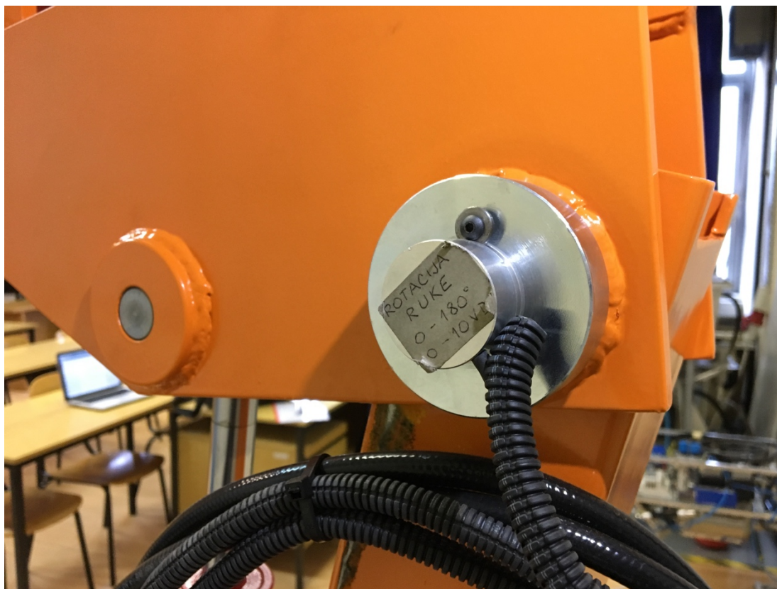
Slika 15. Rotacioni davač kuta zakreta ruke manipulatora
