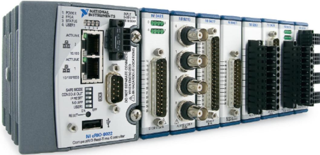
**Slika 46.** Primjer tržišno dostupne upravljačke jedinice CompactRIO tvrtke National Instruments
