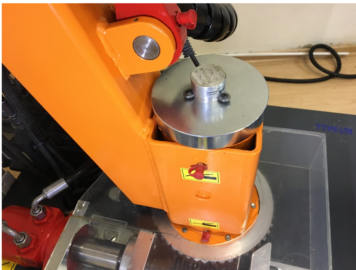
Slika 14. Rotacioni davač kuta zakreta postolja manipulatora
