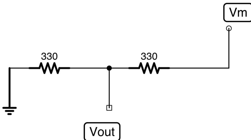
Slika 27. Naponsko djelilo za skaliranje napona senzora
