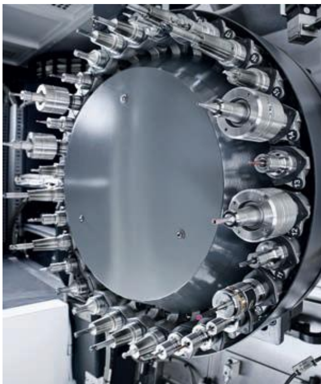
Slika 19. Izmjenjivač alata sa spremište za 30 alata [13]
