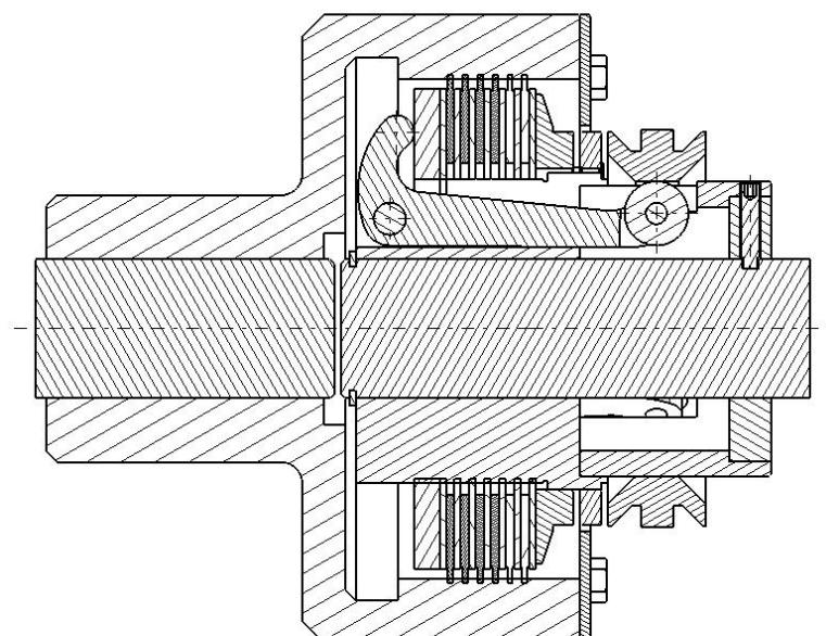
Slika 3.4.: Višelamelna mehanička spojka s glavčinom za dva vratila
