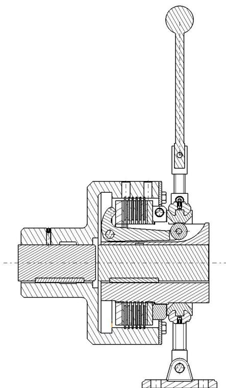
Slika 3.8.: Višelamelna spojka s ručnim sustavom za uključenje
