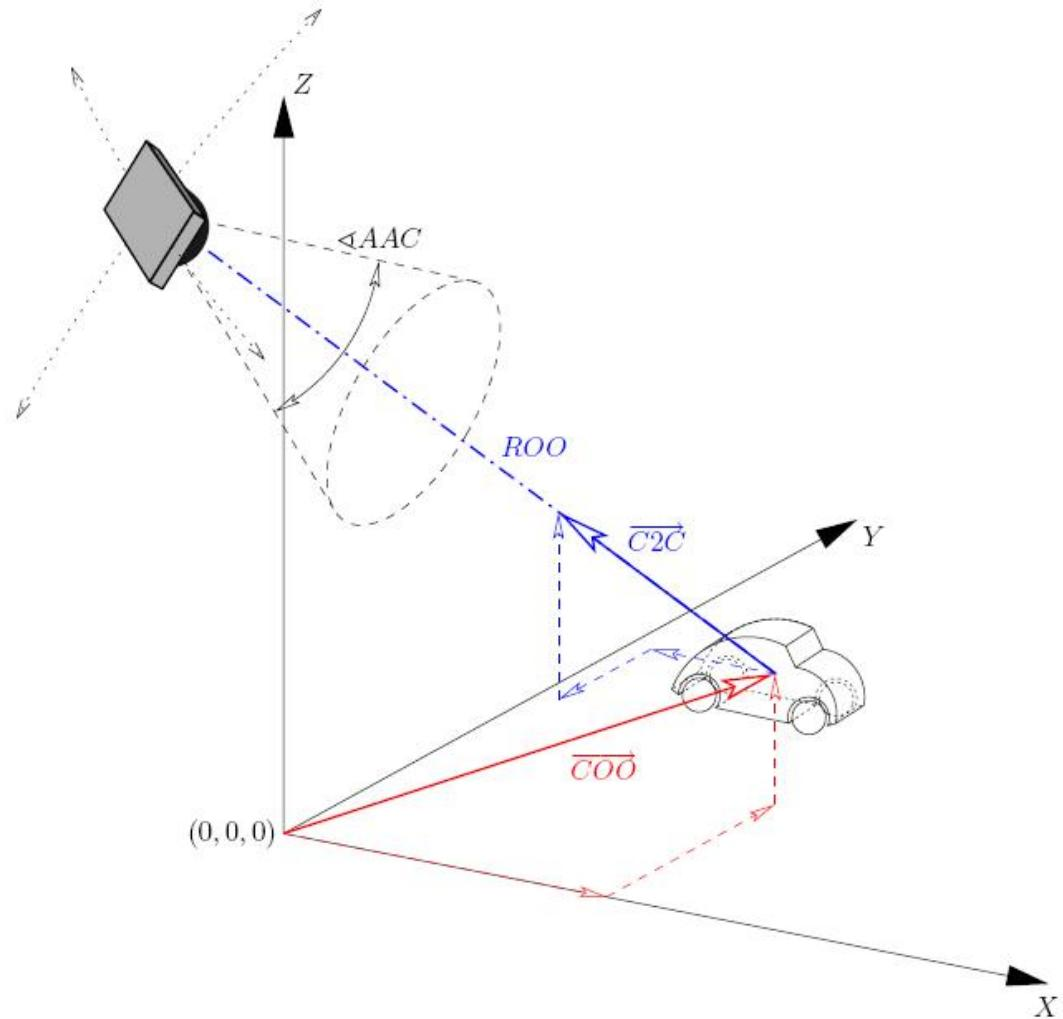
Slika 2.1.: Kamera i 3D objekt u Globalnom Sustavu  $XYZ$ ; iz središta sustava prema objektu pozicioniran je vektor  $\vec{COO}$ , iz centra objekta prema kameri pozicioniran je vektor  $\vec{C2C}$ , radijus orbite je  $ROO$ , širina kuta kamere je  $\angle AAC$
