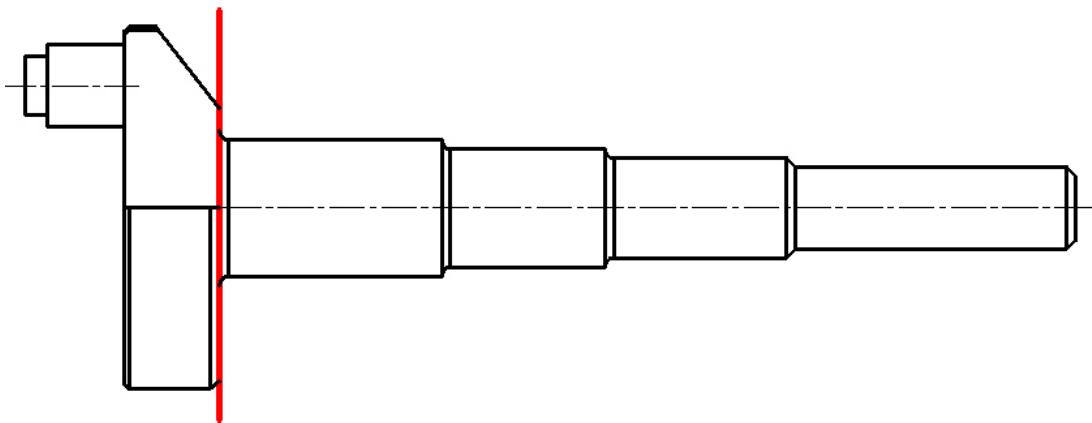
**Slika 38. Odabir fiktivne ravnine od koje će se mjeriti duljinske mjere**
