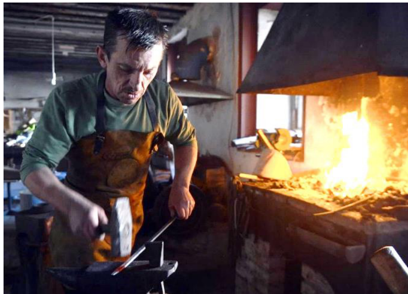
Slika 1. Kovanje snagom ruke udarcima čekića po nakovnju [1]
