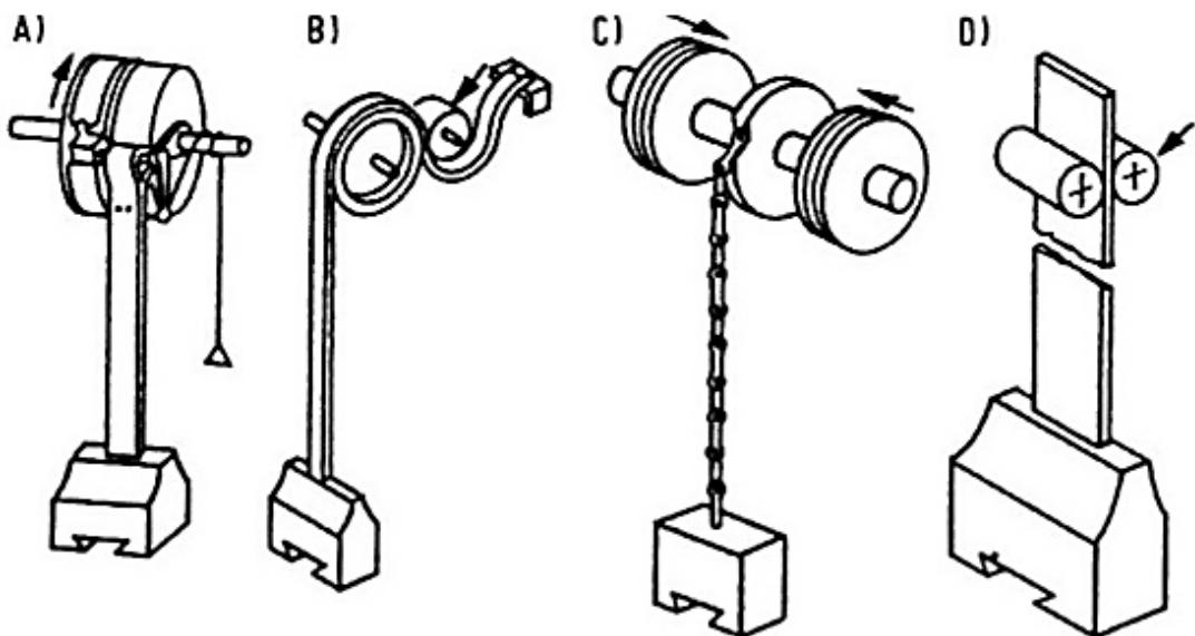
Slika 23. Razne izvedbe mehaničkih gravitacijskih batova A) i B) bat s trakom ili remenom
