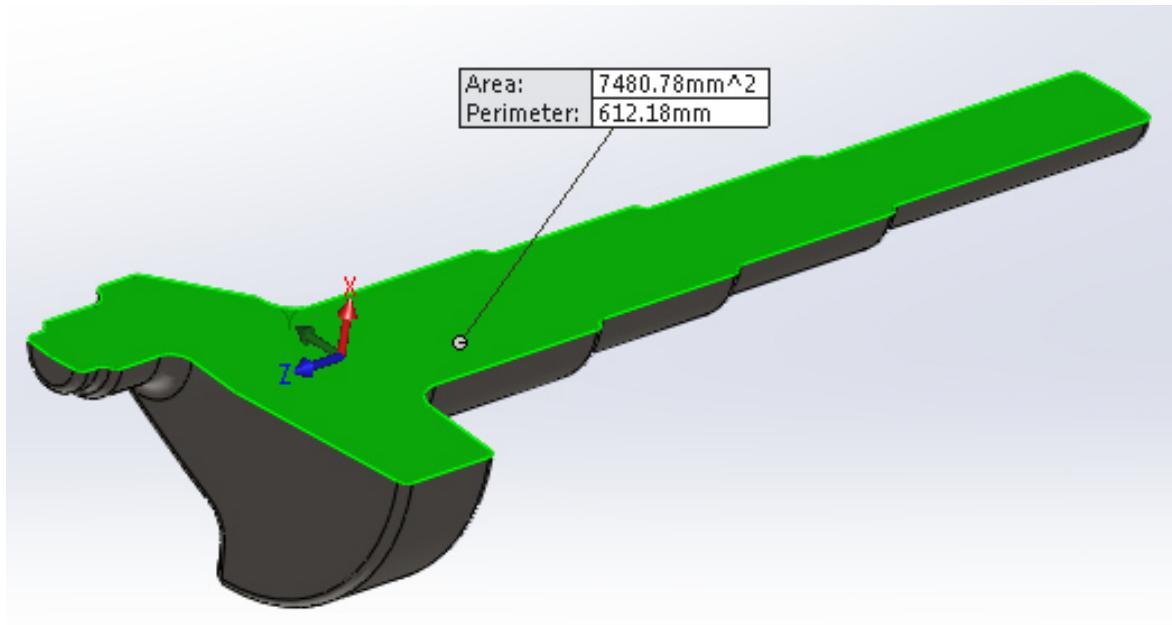
**Slika 43.** Površina poprečnog presjeka otkivka u horizontalnoj ravnini
