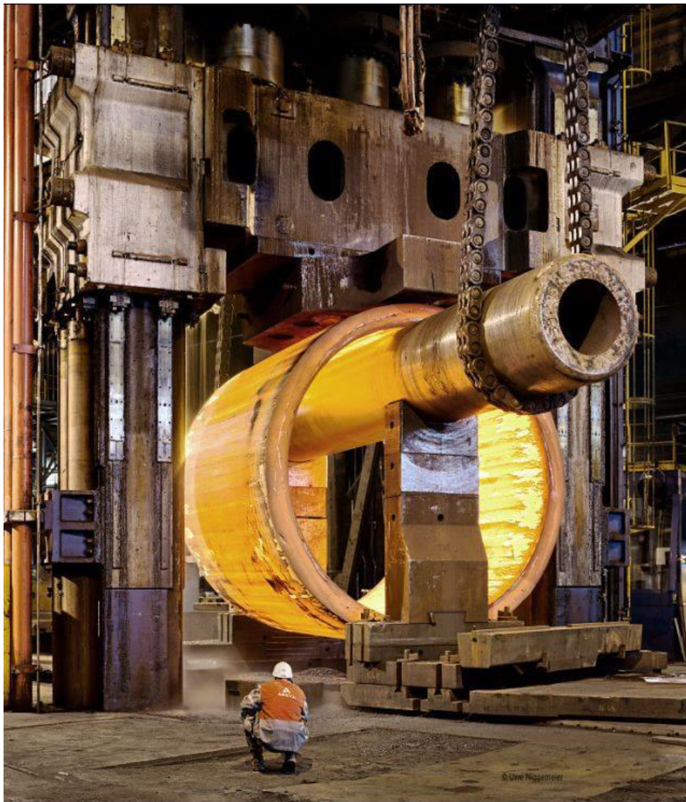
Slika 7. Slobodno kovanje otkivka velikih dimenzija i oblika [12]
