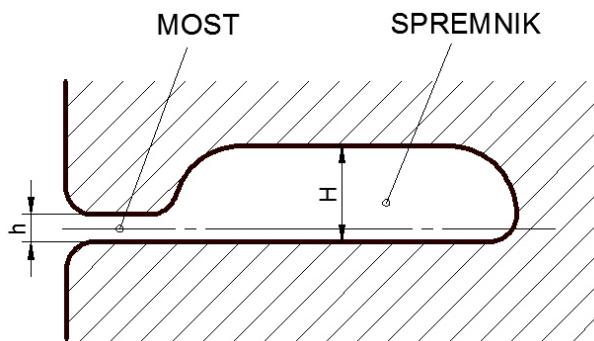
**Slika 16. Dijelovi kanala za vijenac, most i spremnik [15]**
