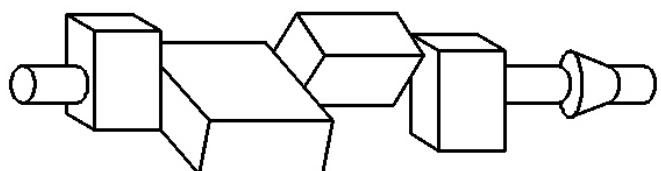
**Slika 13.** Shematski prikaz slobodnog kovanja koljenastog vratila: 1) Ingot 2) Izduživanje i odstranjivanje glave ingota 3) Zasijecanje 4) - 5) Izduživanje i oblikovanje 6) Završno oblikovanje do 8) [14]
