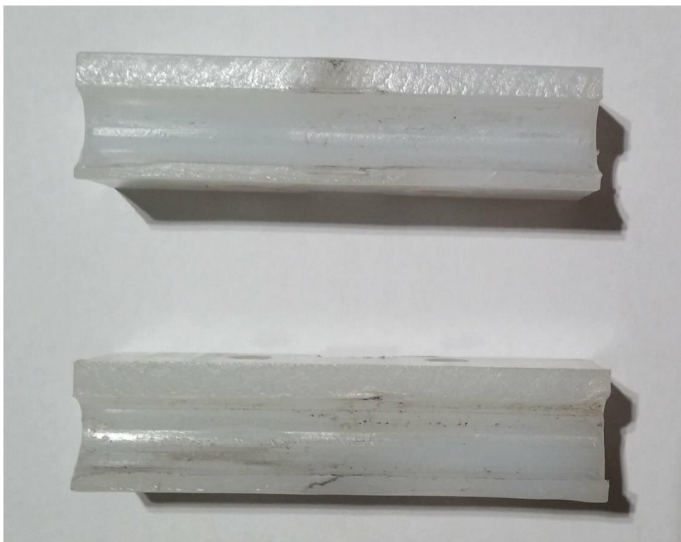
Slika 17. Alati nakon ultrazvučnog čišćenja, od gore: polimerni (savijao nehrđajući čelik), polimerni (savijao bakar)
