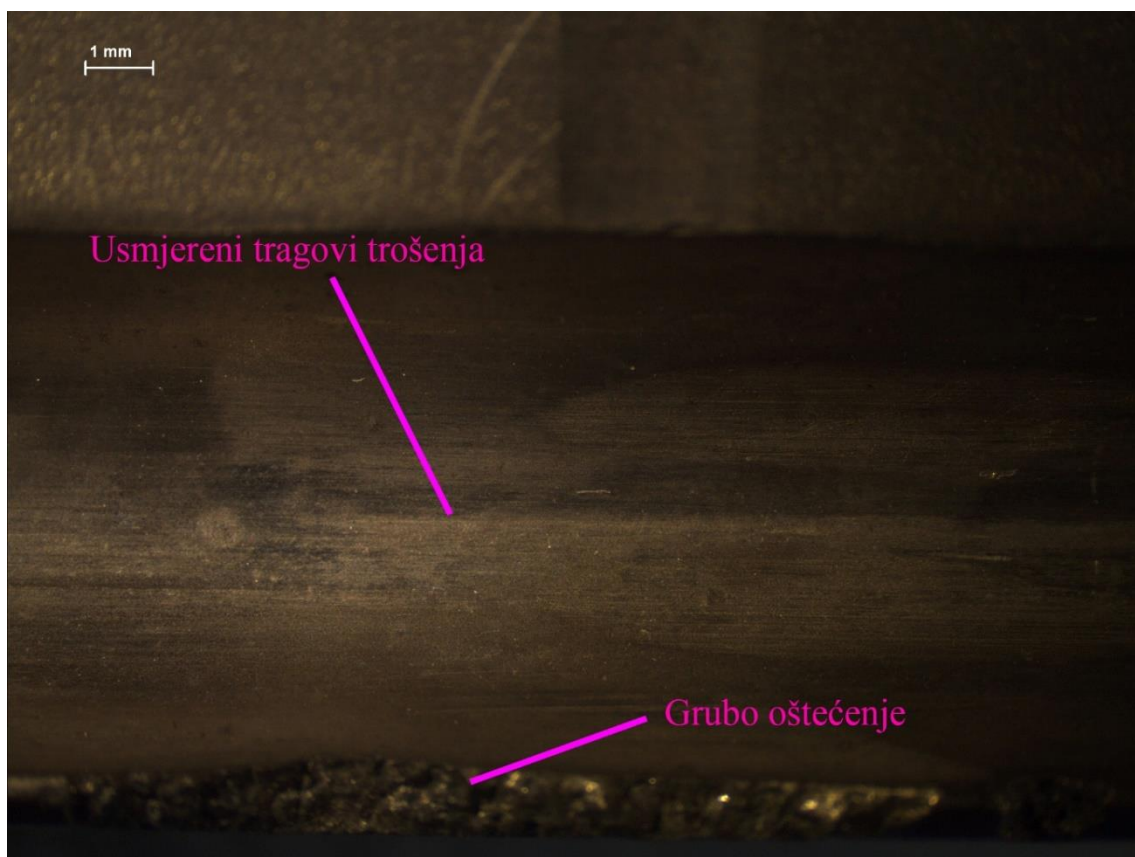
Slika 27. Tragovi trošenja brončanog alata (povećanje 7.88x)
