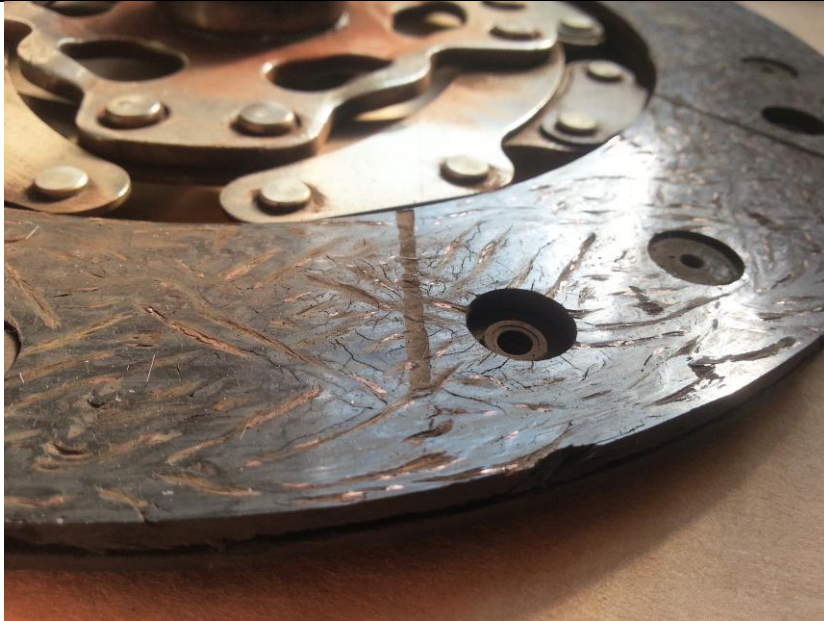
Slika 60. Tragovi trošenja na tanjuru tarne spojke
