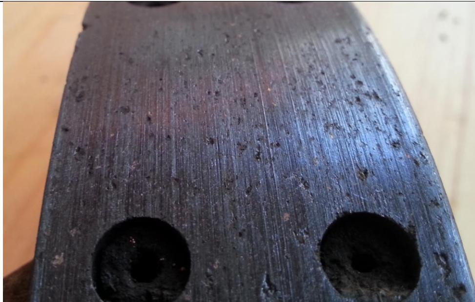
Slika 73. Površina potrošene kočione obloge bubanj kočnice
