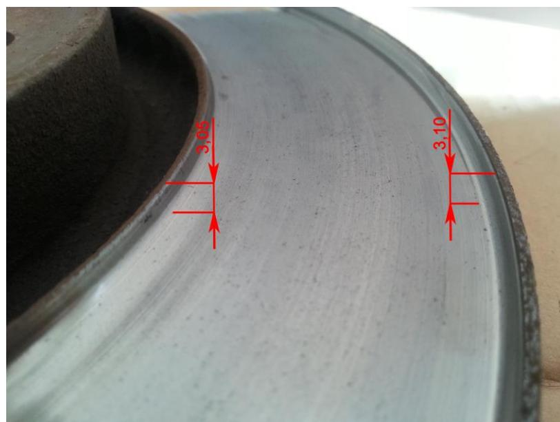
Slika 64. Mjere potrošene površine kočionog diska 1
