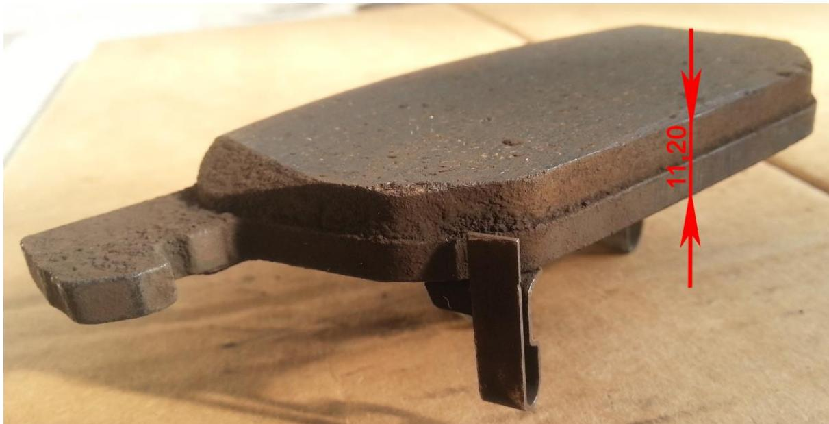
Slika 69. Debljina unutarnje strane unutarnje kočione pločice 1
