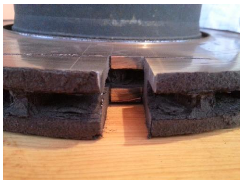
Slika 85. Mjesto izrezivanja uzorka diska
