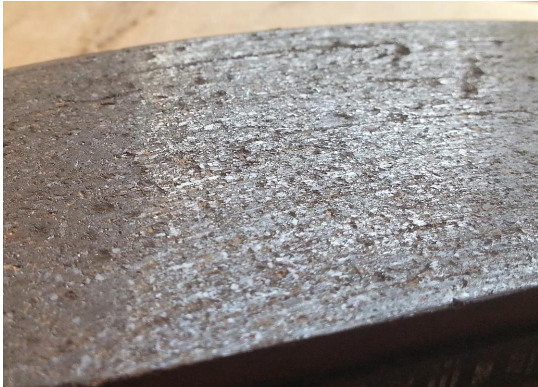
Slika 66. Trošena površina kočione pločice 1
