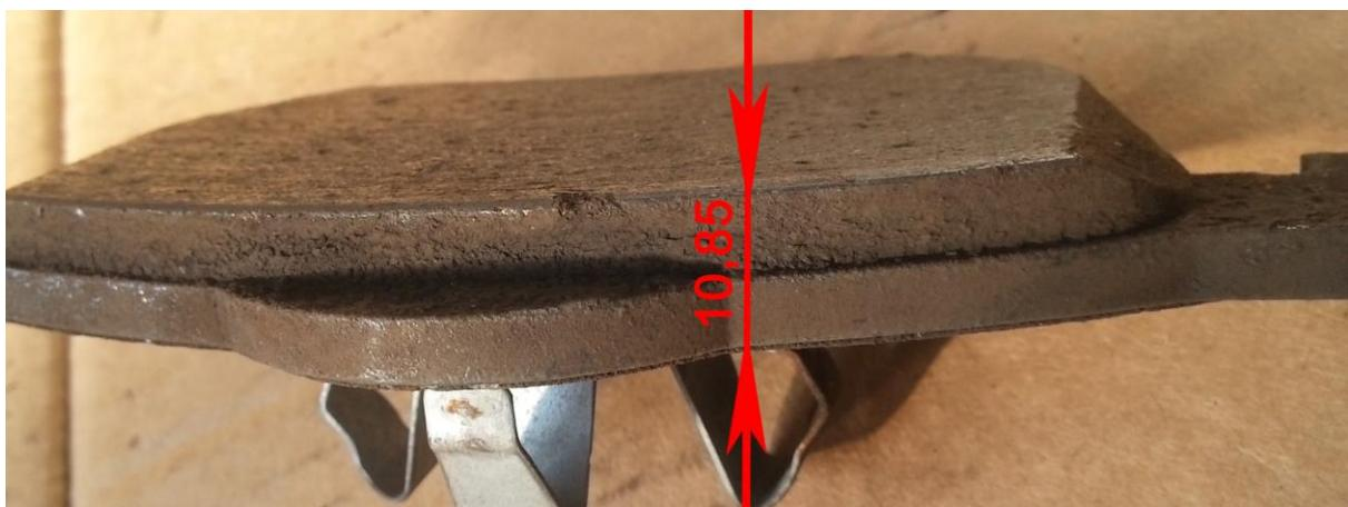
Slika 70. Debljina vanjske strane unutarnje kočione pločice 1
