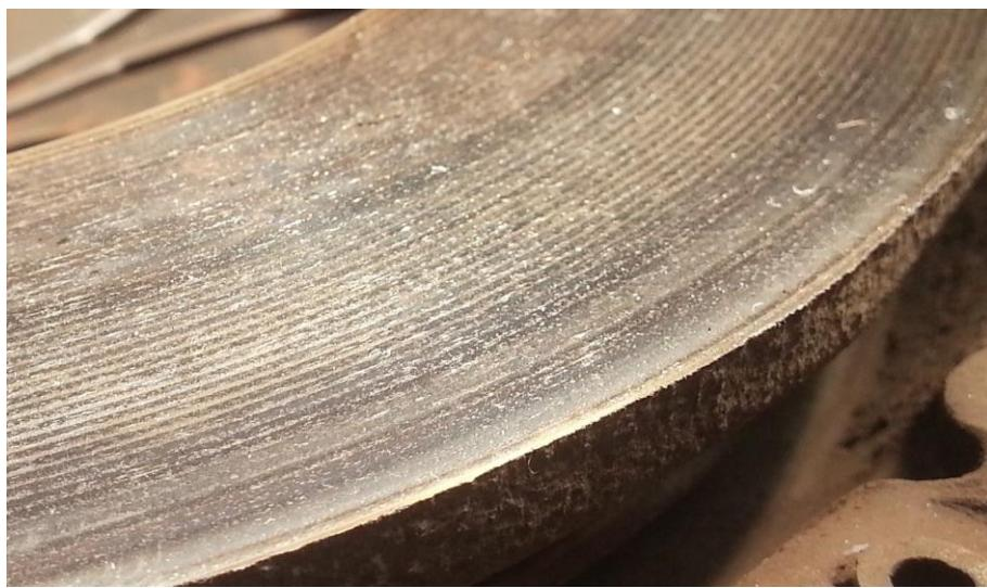
Slika 57. Tragovi trošenja na potisnoj ploči
