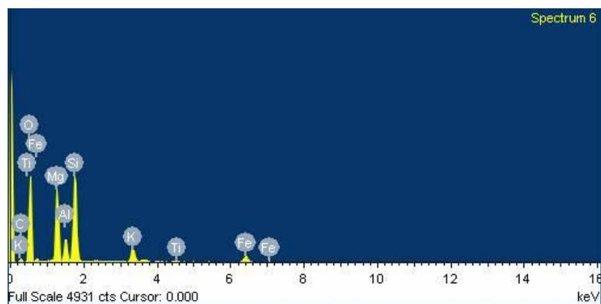
**Slika 120. EDS kemijska analiza elemenata uzorka kočione obloge - 5**
