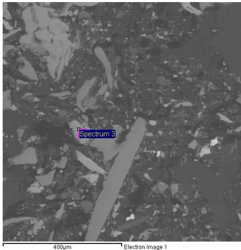
**Slika 109. Područje druge analize površine uzorka kočione obloge**
