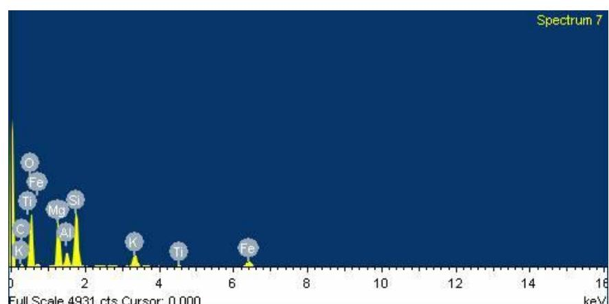
**Slika 123. EDS kemijska analiza elemenata uzorka kočione obloge - 6**
