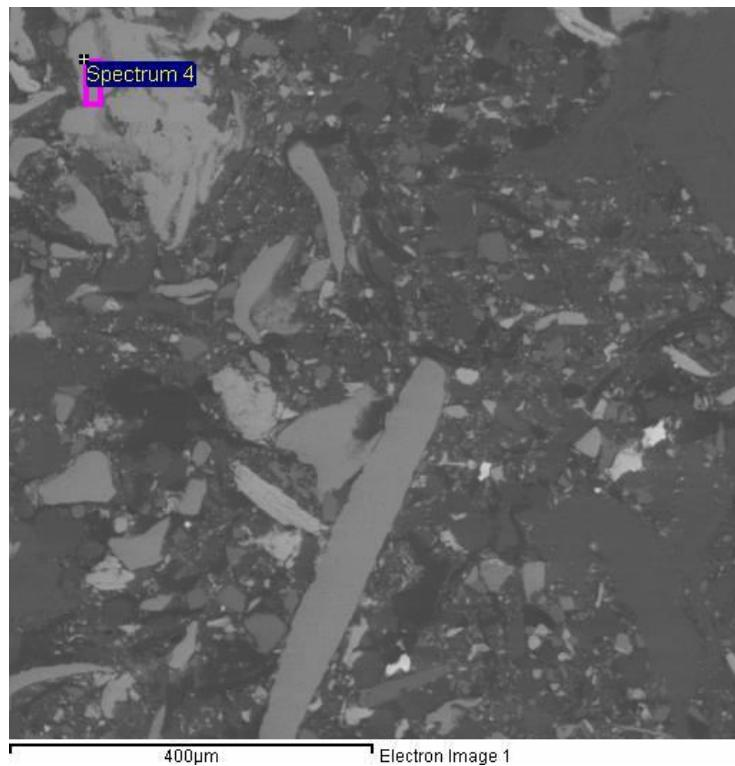
**Slika 112. Područje treće analize površine uzorka kočione obloge**
