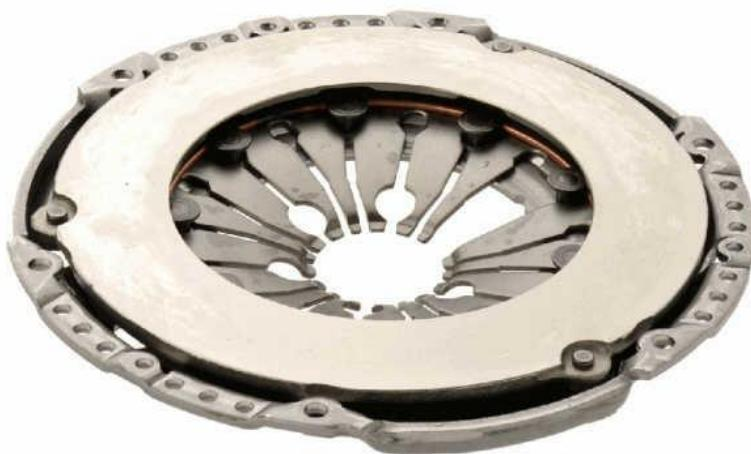
**Slika 56. Novi set potisne ploče s potisnim ležajem**
