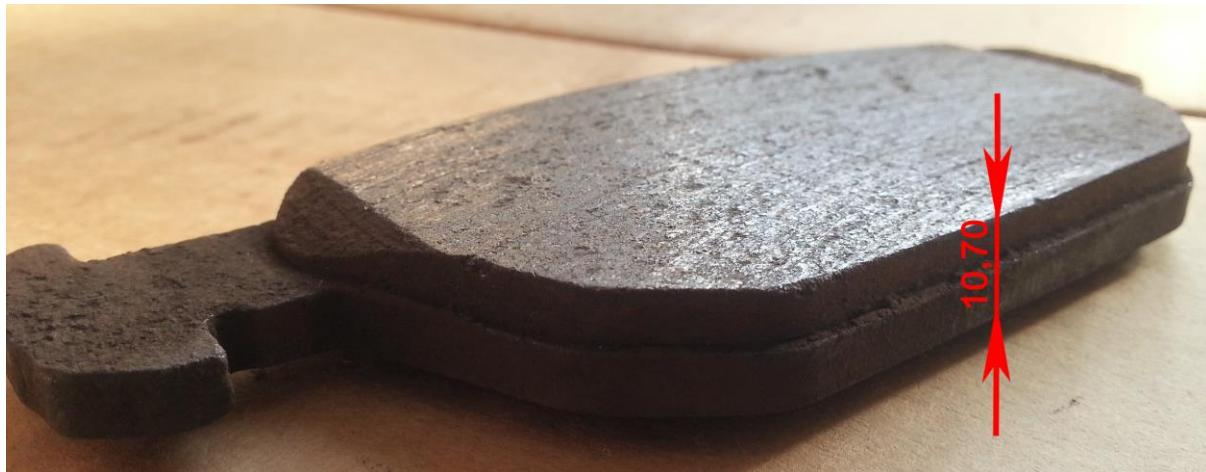
Slika 67. Debljina unutarnje strane vanjske kočione pločice 1
