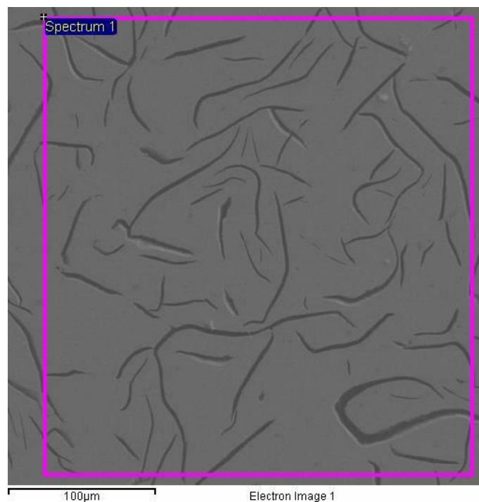
**Slika 98. Područje prve analize površine uzorka kočionog diska**
