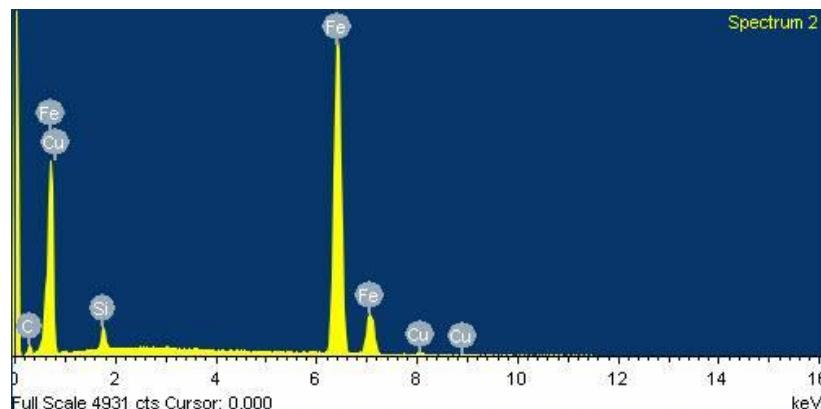
**Slika 103. EDS kemijska analiza elemenata uzorka kočionog diska - 2**
