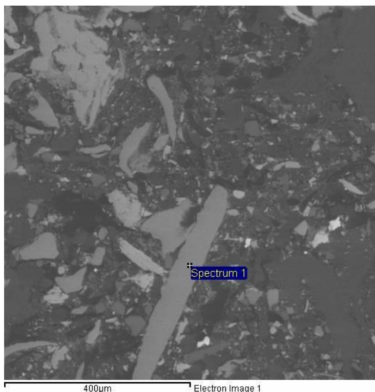
Slika 106. Mjesto prve analize površine uzorka kočione obloge
