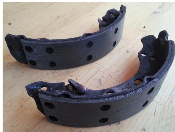
**Slika 71. Potrošene obloge bubanj kočnice**
