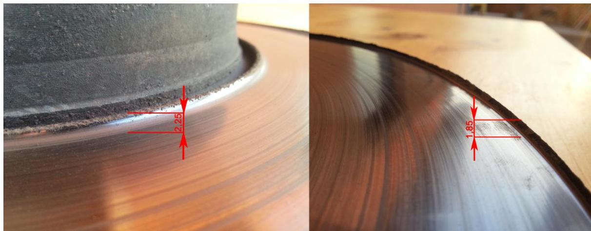
Slika 82. Dimenzije urezanog žlijeba na disku – unutarnji i vanjski dio diska
