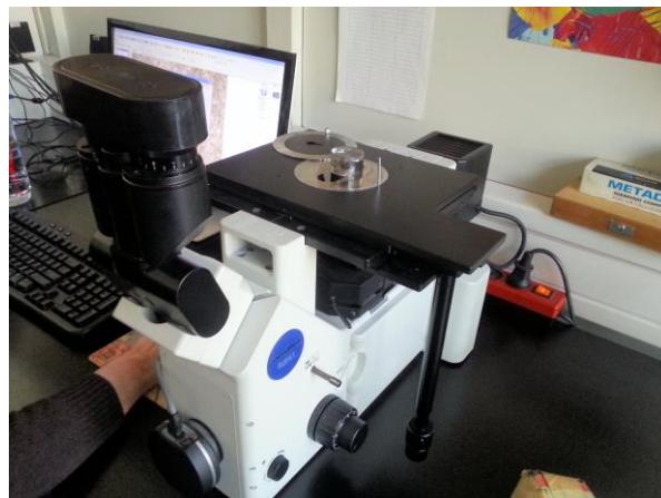
**Slika 90. Uzorci na svjetlosnom mikroskopu „OLYMPUS GX51“**
