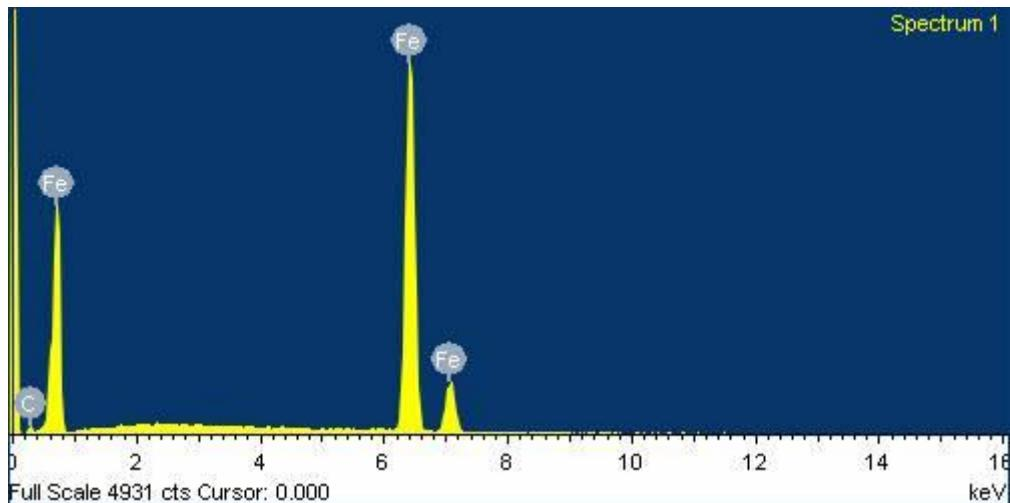
Slika 108. EDS kemijska analiza elemenata uzorka kočione obloge – 1
