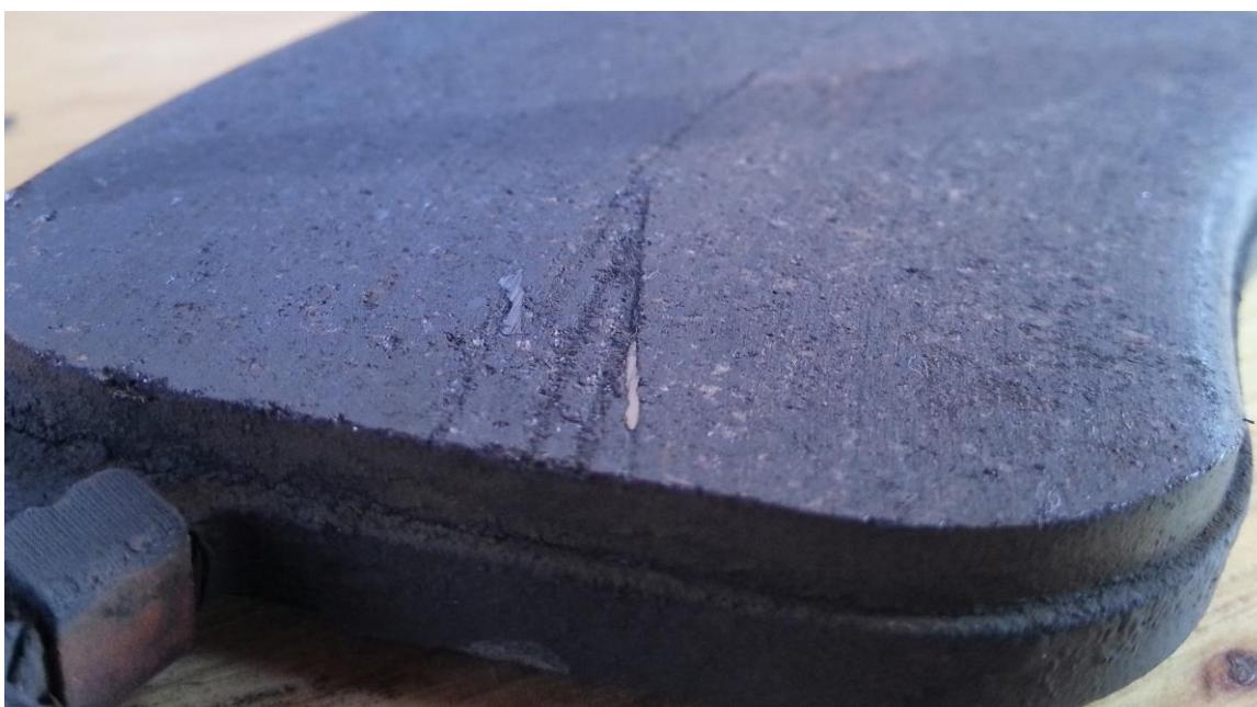
Slika 84. Trošena površina ispitivane kočione obloge
