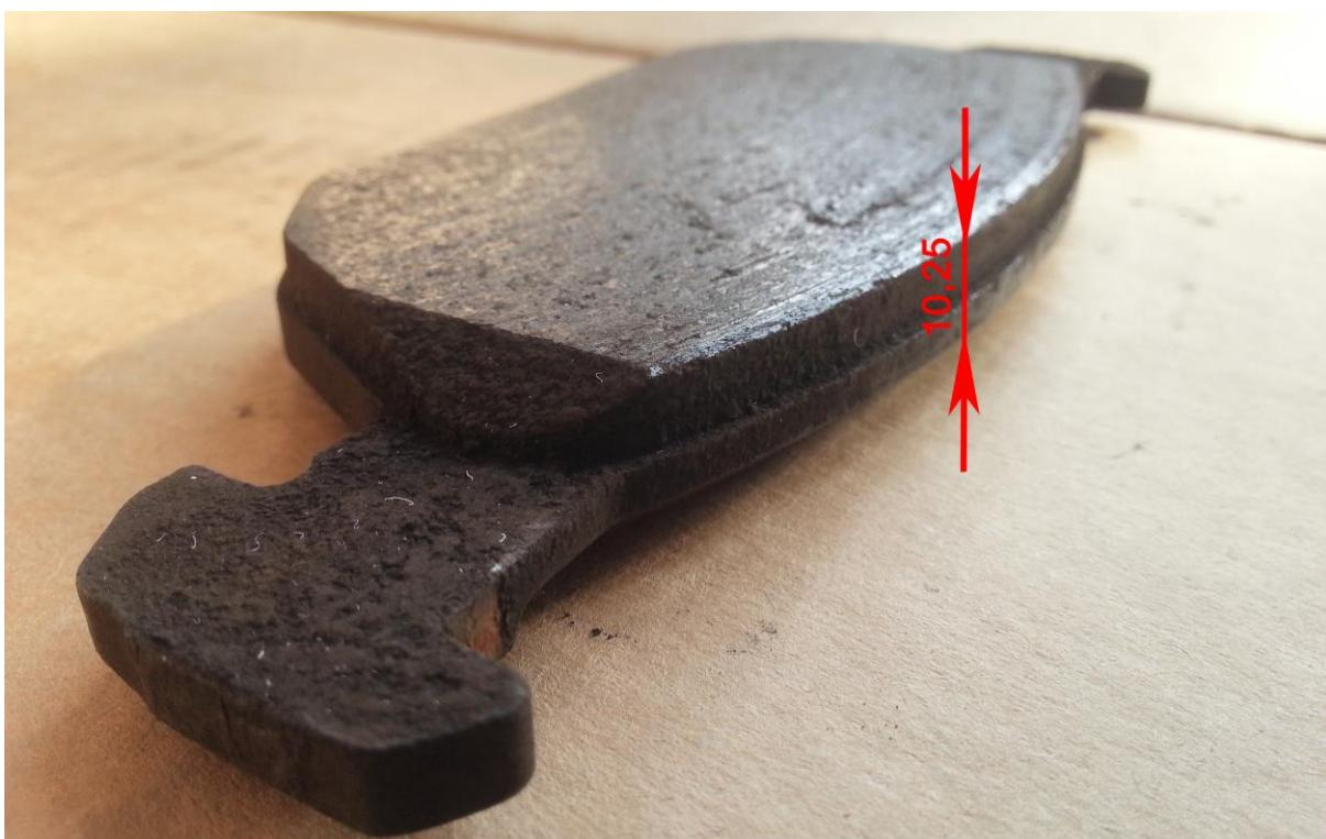
Slika 68. Debljina vanjske strane vanjske kočione pločice 1
