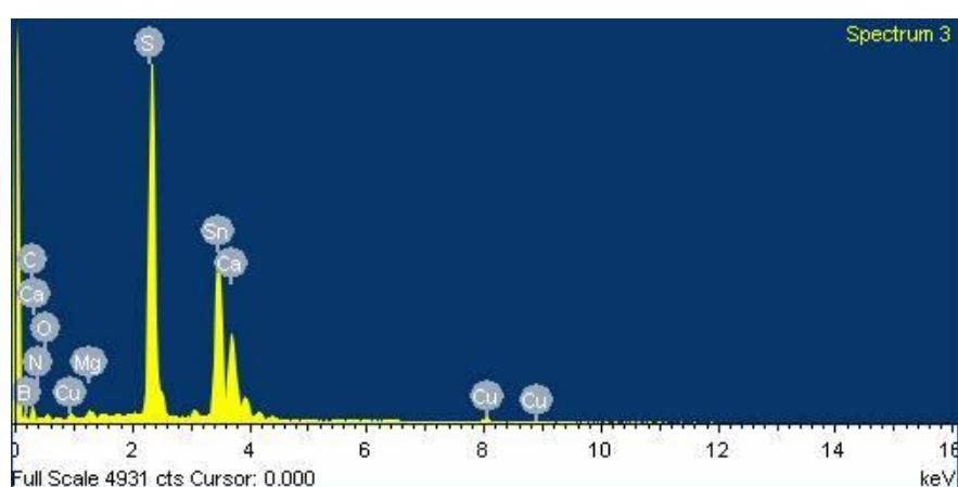
**Slika 110. Udio elemenata uzorka kočione obloge – 2**
