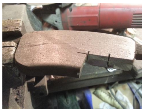
Slika 86. Mjesto izrezivanja uzorka obloge
