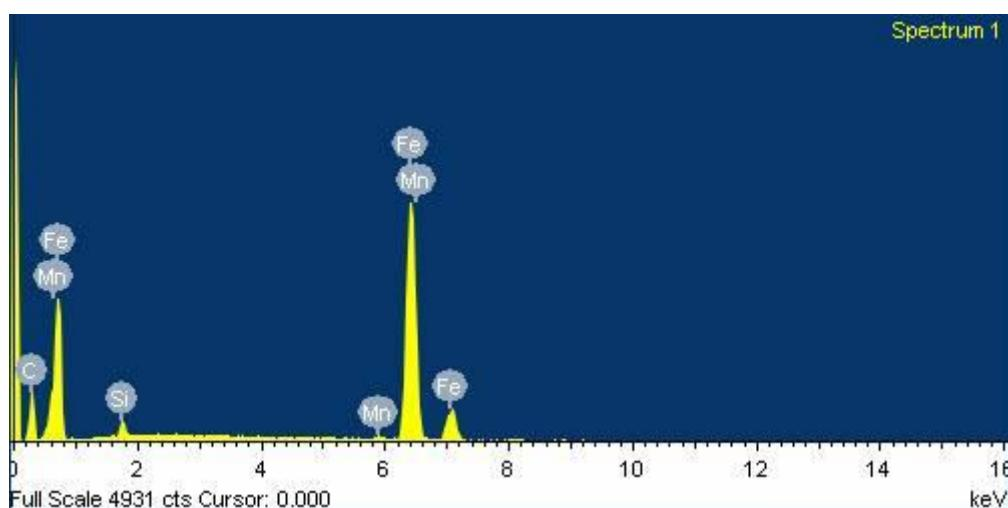
**Slika 100. EDS kemijska analiza elemenata uzorka kočionog diska - 1**
