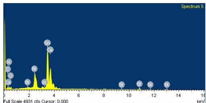
**Slika 117. EDS kemijska analiza elemenata uzorka kočione obloge – 4**
