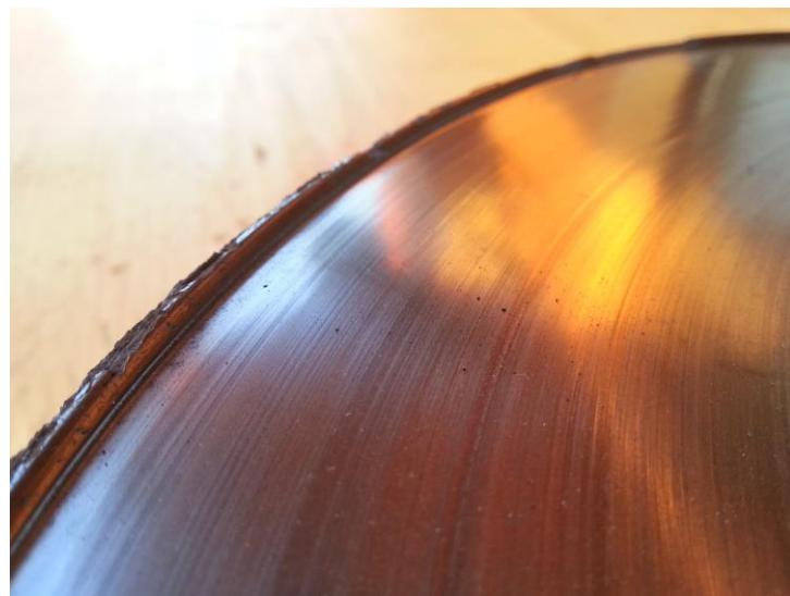
Slika 81. Trošena površina ispitivanog diska
