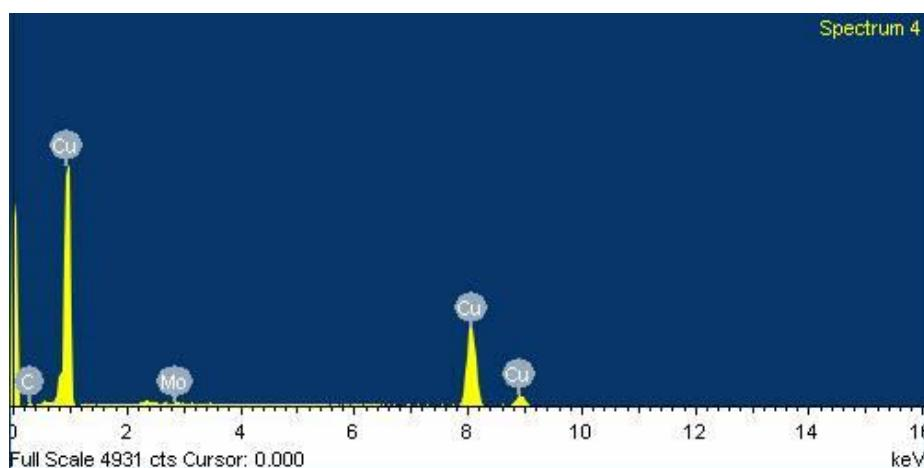
**Slika 114. EDS kemijska analiza elemenata uzorka kočione obloge - 3**
