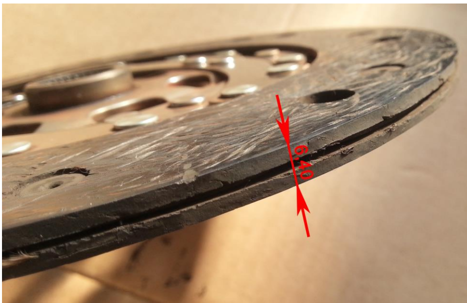
Slika 61. Debljina tanjura tarne spojke
