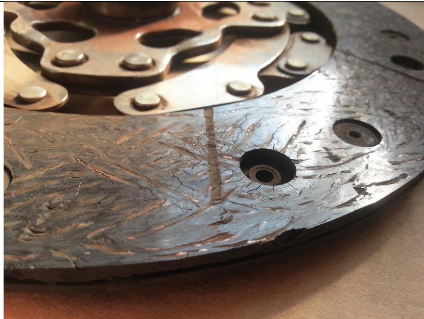
**Slika 60. Tragovi trošenja na tanjuru tarne spojke**
