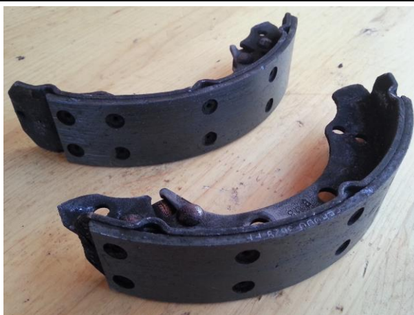
Slika 71. Potrošene obloge bubanj kočnice
