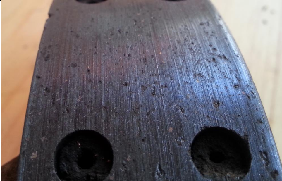
Slika 73. Površina potrošene kočione obloge bubanj kočnice
