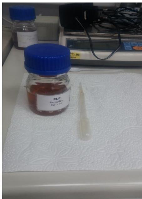
Slika 4.6. Uzorak ulja 1 i pipeta
