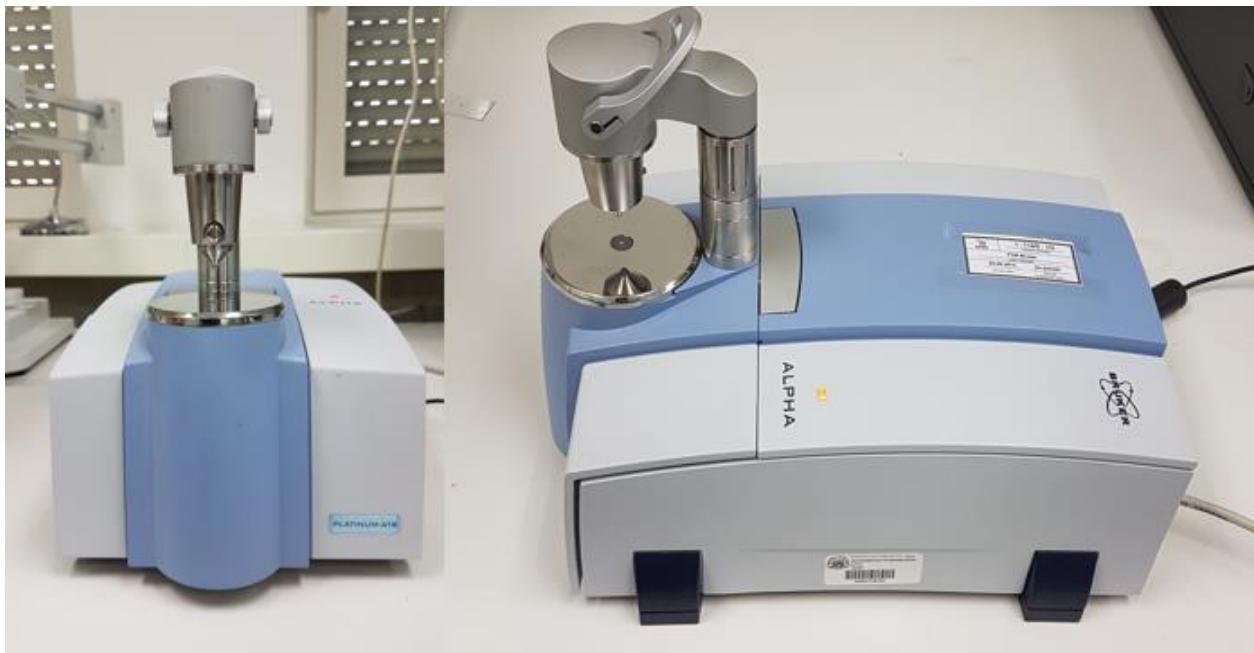
Slika 4.12. Infracrveni spektrometar
