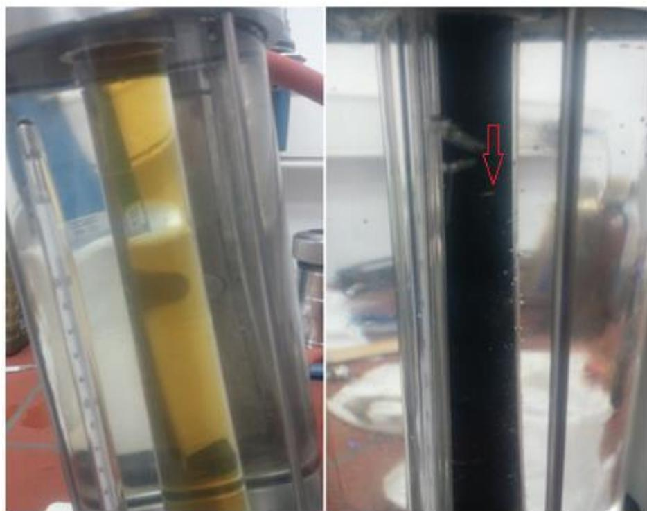
**Slika 4.5. Kuglica u staklenoj cijevi viskozimetra**
