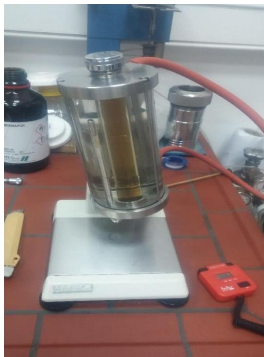
Slika 4.2. Höpplerov viskozimetar
