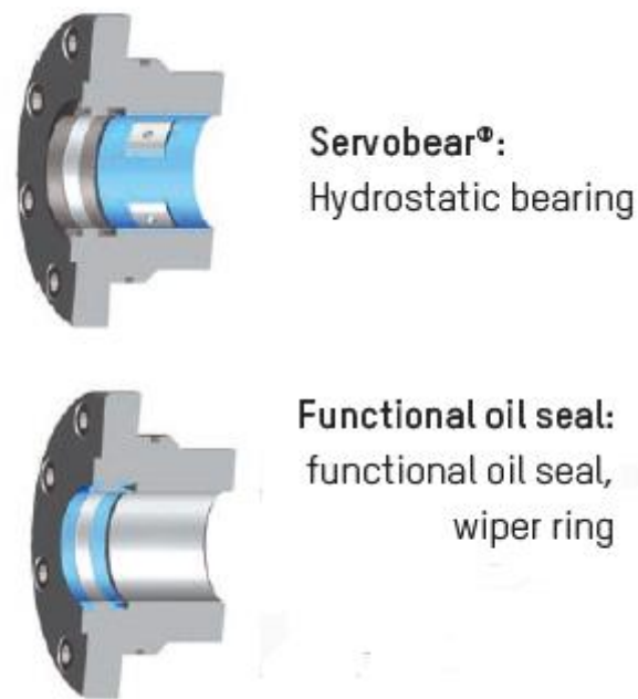
Slika 19. Sustav za vođenje i brtveni sustav cilindra [5]
