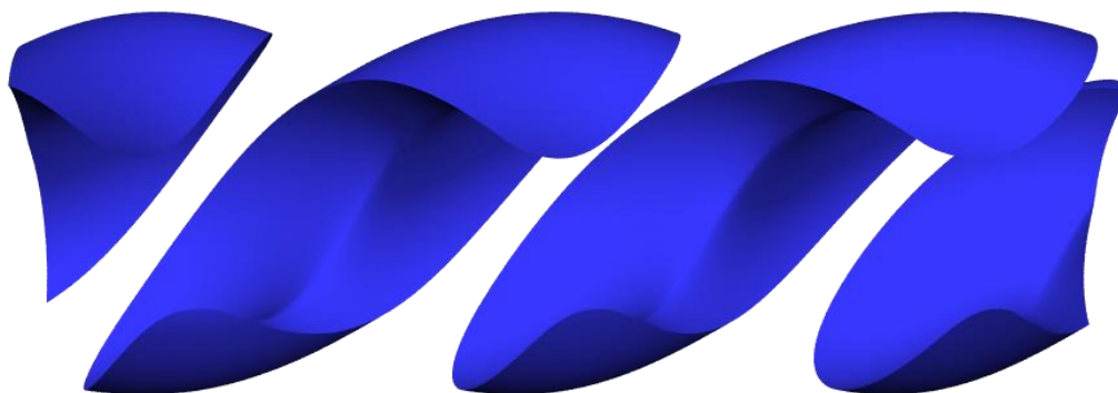
Slika 13. Prikaz šupljina unutar vijčano-ekscentrične pumpe [28]
