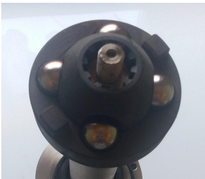
Slika 29. Glava s donjim dijelom gnijezda i kuglicama
