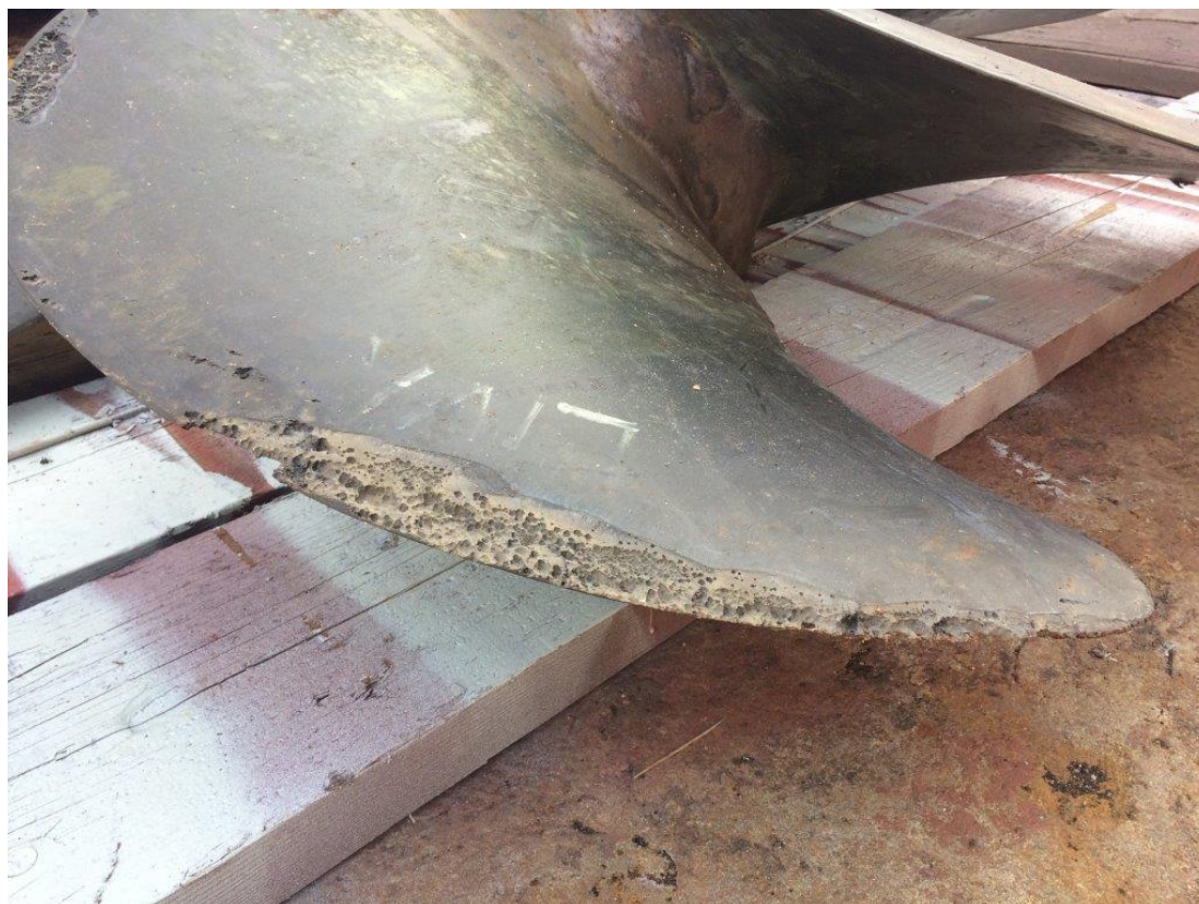
Slika 7. Kavitacija na brodskom propeleru [17]
