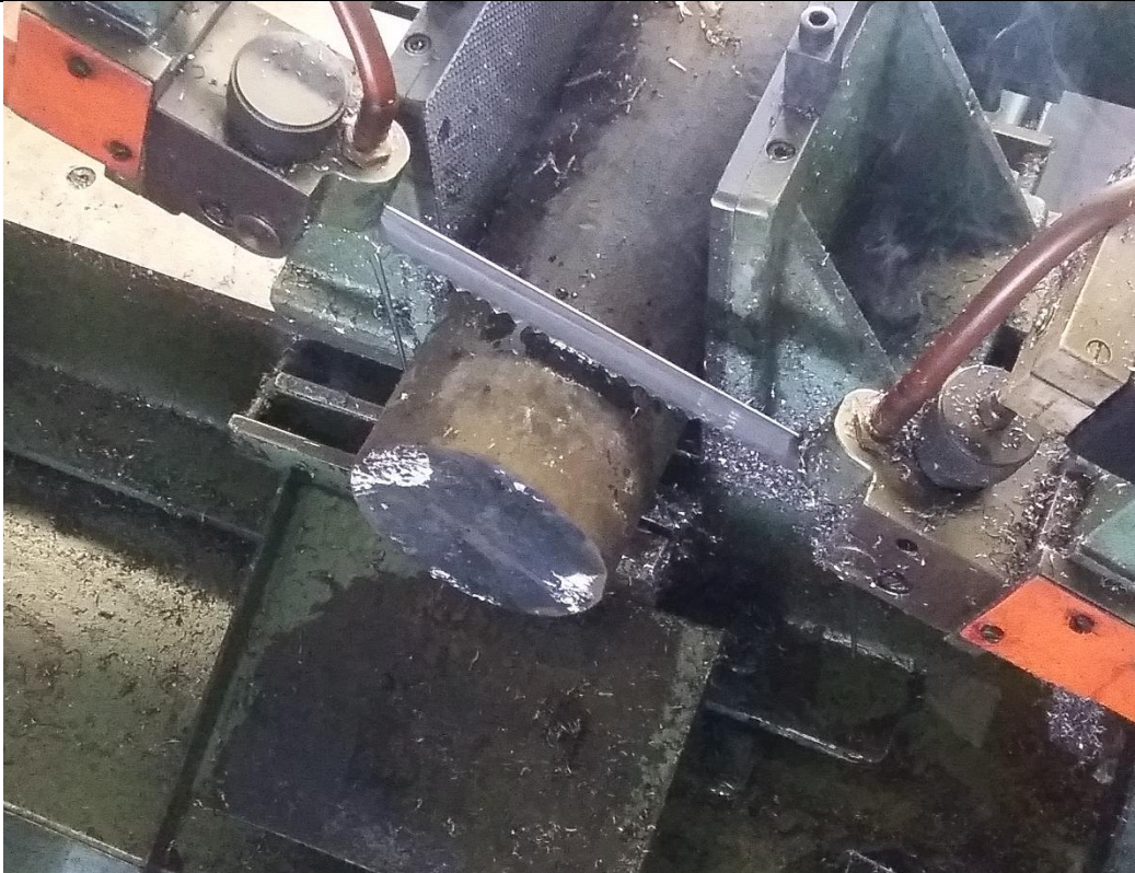
Slika 38. Tračno piljenje šipkastog materijala
