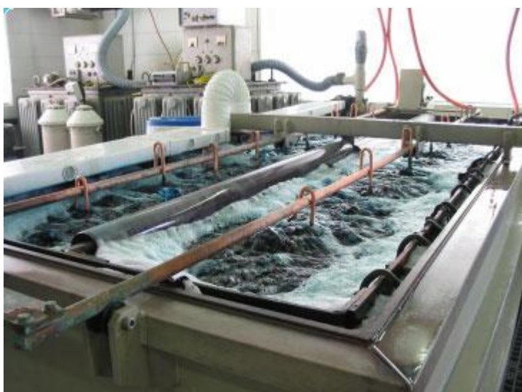
Slika 9. Prikaz procesa galvanizacije [20]
