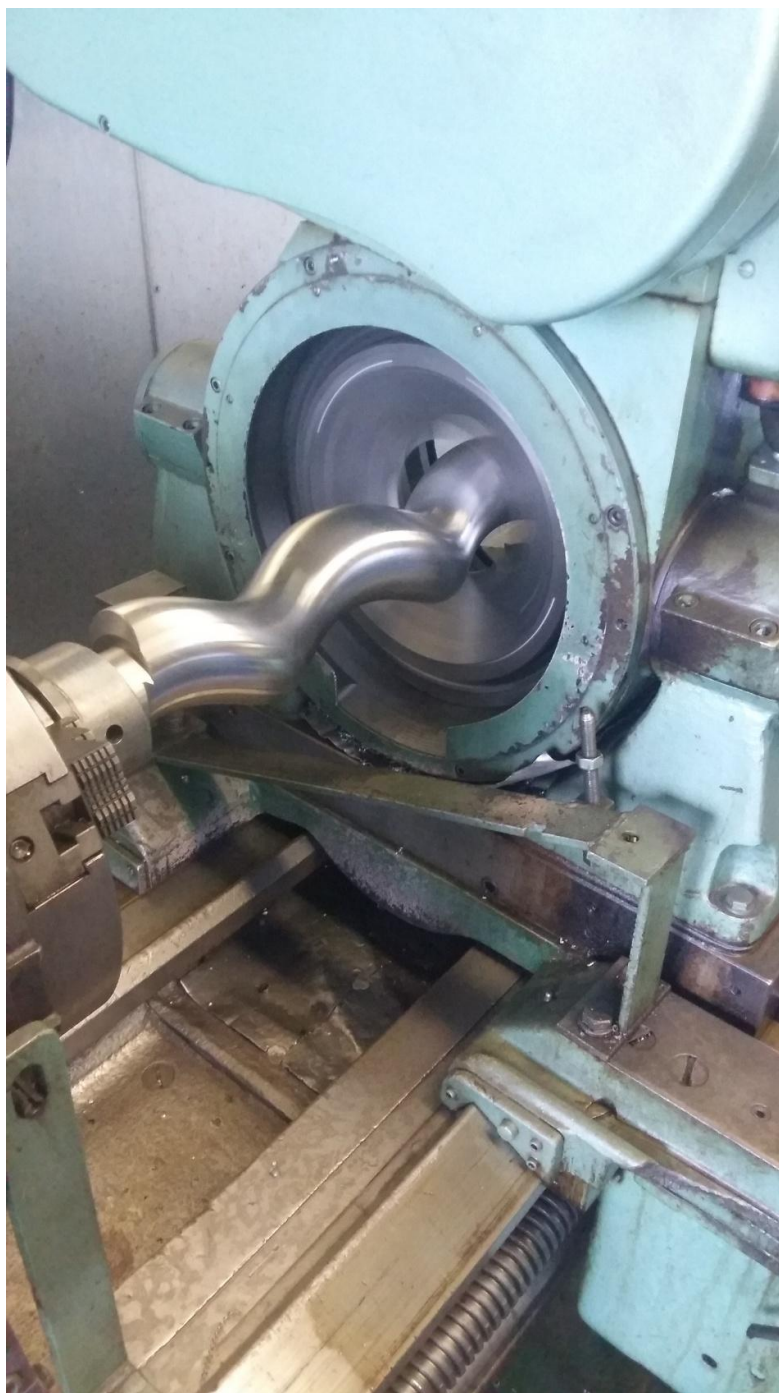
Slika 50. Izrada spirale rotora vijčano-ekscentrične pumpe
