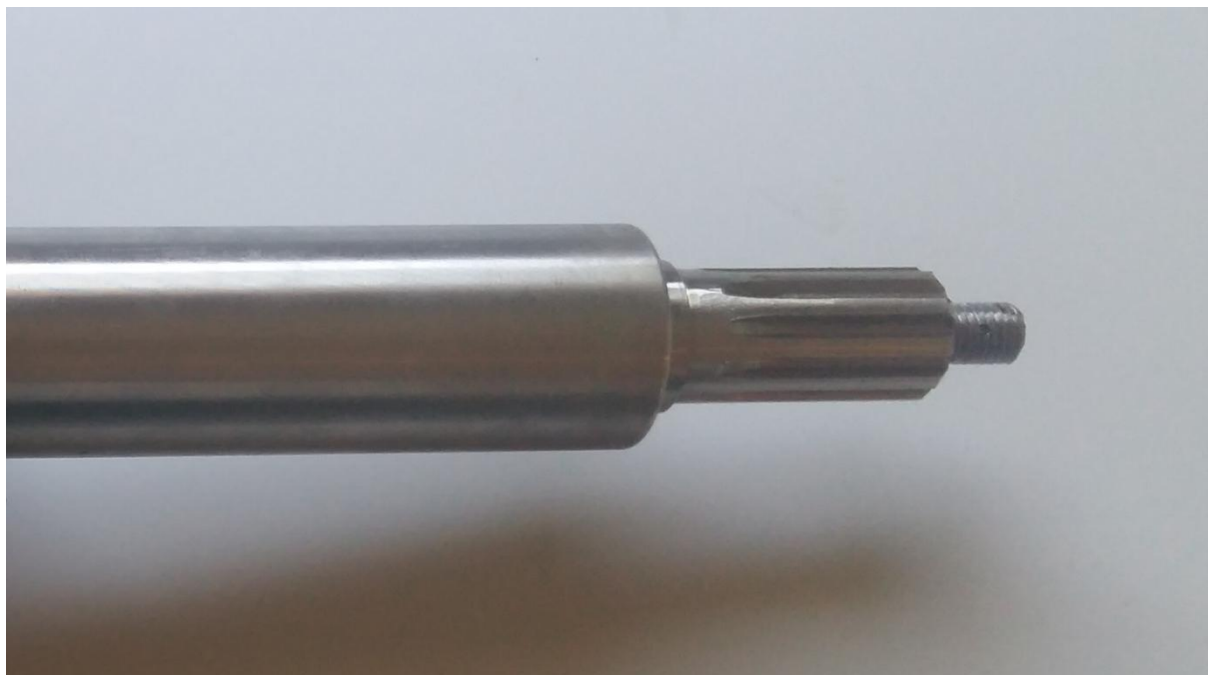
Slika 25. Ozubljenje kardanskog vratila
