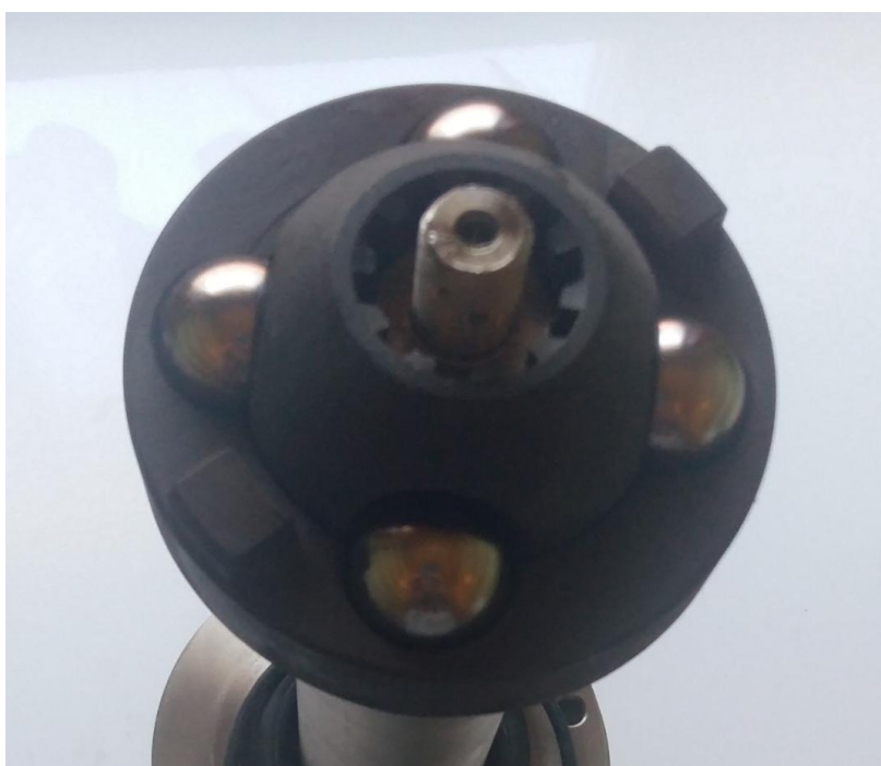
Slika 29. Glava s donjim dijelom gnijezda i kuglicama
