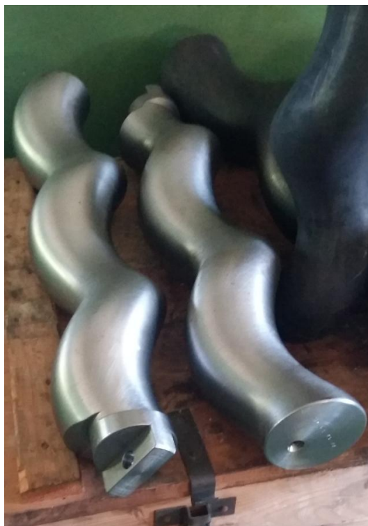
Slika 52. Konačni izgled rotora vijčano-ekscentrične pumpe
