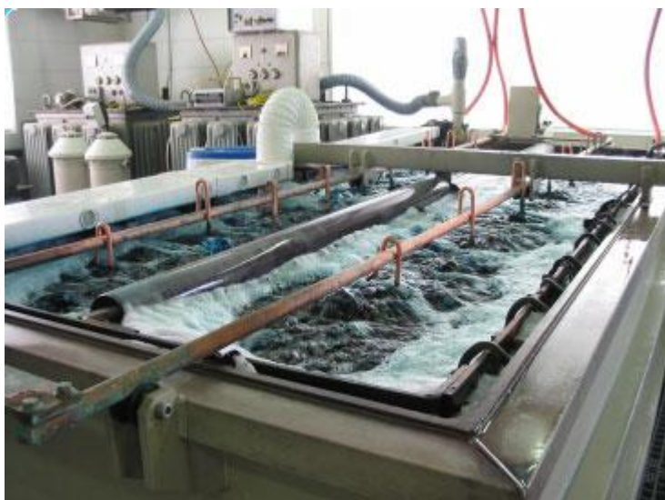
Slika 9. Prikaz procesa galvanizacije [20]
