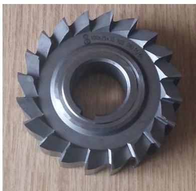
Slika 42. Glodalo za obradu glave rotora vijčano-ekscentrične pumpe
