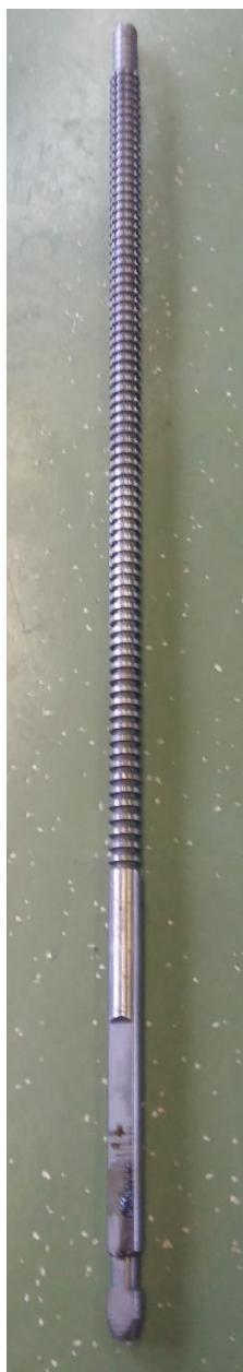
Slika 27. Igla za provlačenje glave kardanskog vratila
