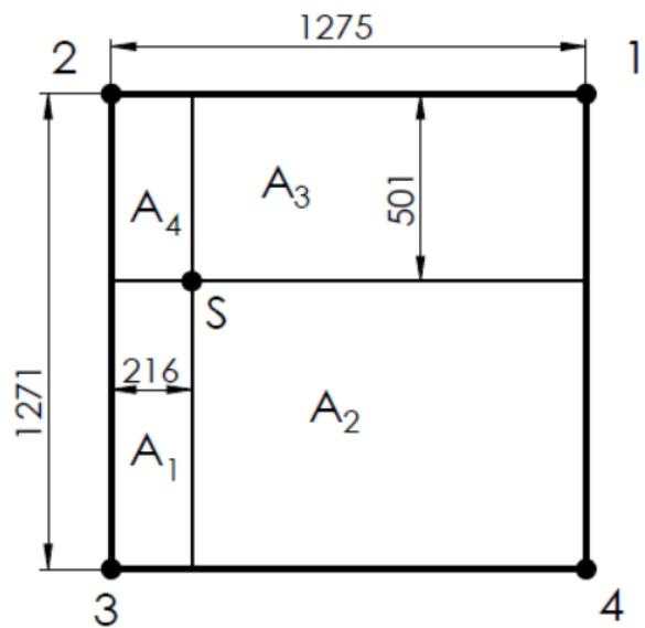
Slika 27. Površine za izračunavanje sila Andreeovom metodom
