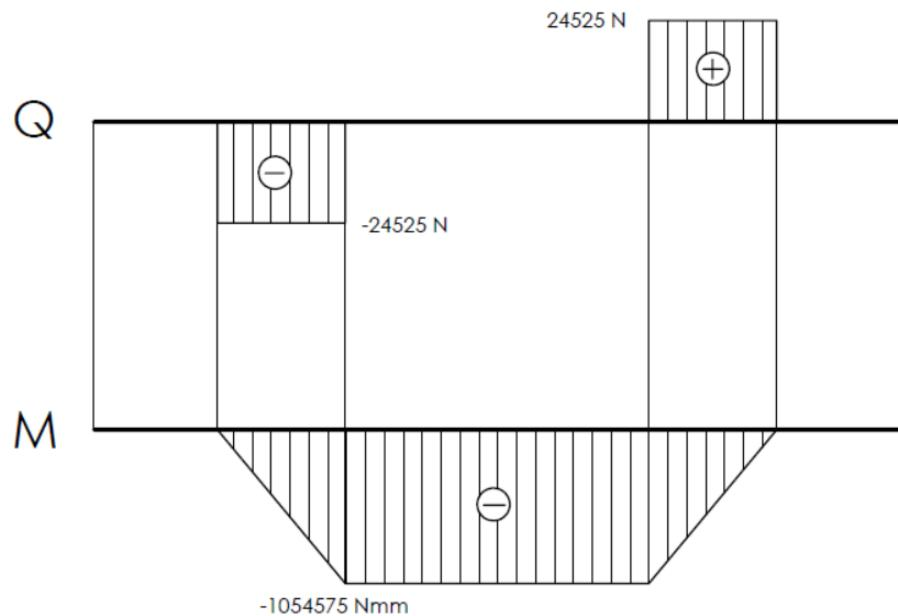
**Slika 19. Dijagrami poprečnih sila i momenata savijanja osovine užnice**
