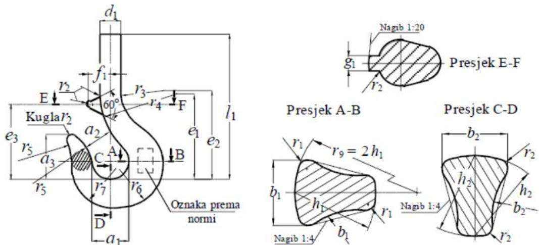
Slika 10. Oznake mjera jednokrake kuke kovane u kalupu
