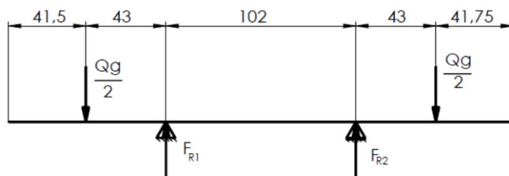
Slika 18. Proračunski model osovine užnice
