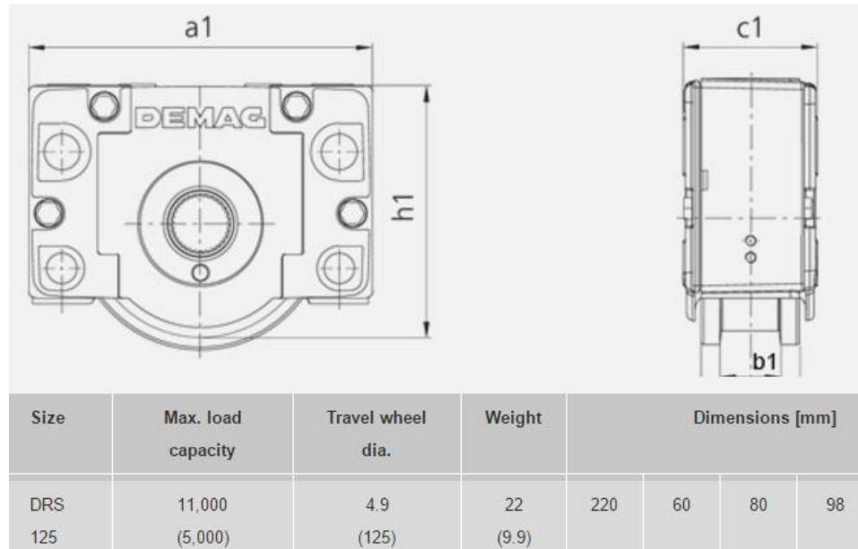
**Slika 44. Karakteristike pogonskog kotača na donjem uzdužnom nosaču**
