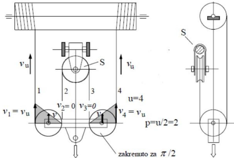
Slika 8. Udvojeni faktorski koloturnik prijenosnog omjera 4/2
