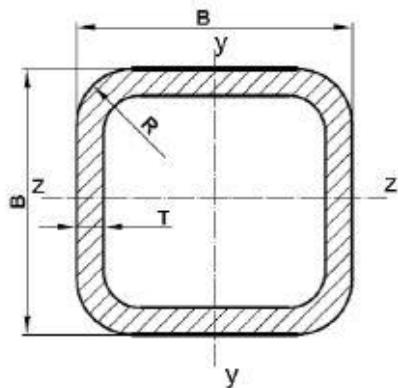
**Slika 41. Profil vertikalnog stupa**
