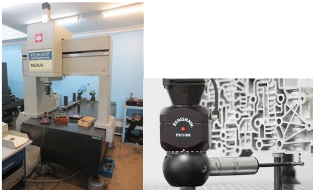
Slika 59. Trokoordinatni mjerni uređaj MERLIN I ticalo RENISHAW
