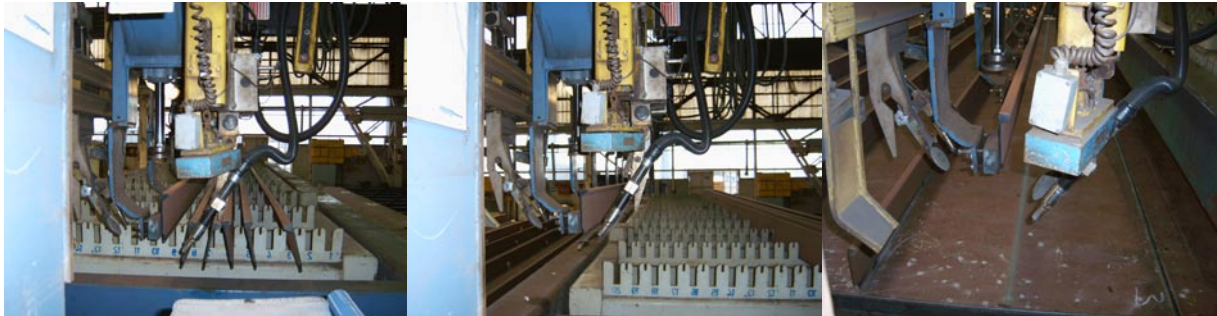
Slika 3.3.9 Dohvat i pozicioniranje profila
