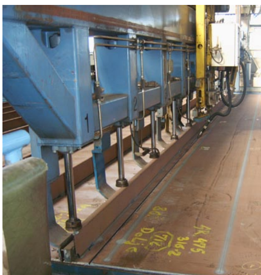
Slika 3.3.10 Pritiskivanje i privarivanje profila
