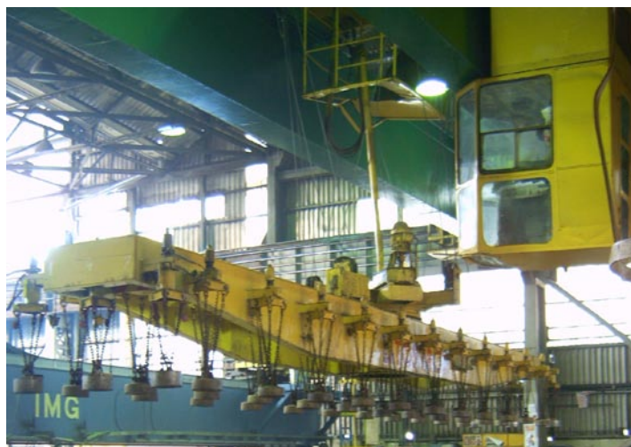
Slika 3.2.2 Portalna magnetska dizalica
