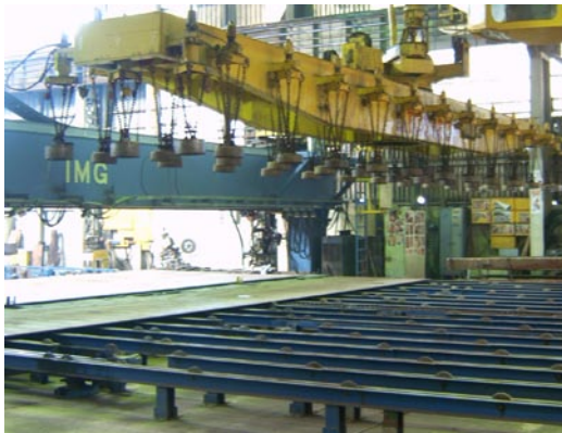
Slika 3.3.1 postavljanje drugog lima
