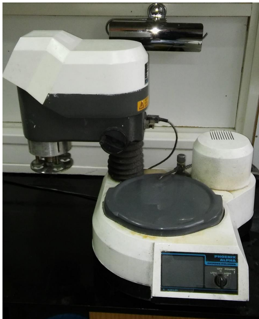
Slika 56. Poliranje uzoraka na uređaju za poliranje Buehler Phoenix Alpha
