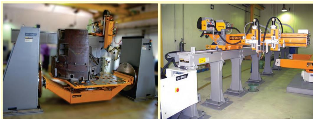
Slika 13. Primjer robotiziranog (lijevo) i automatiziranog (desno) zavarivanja [17]
