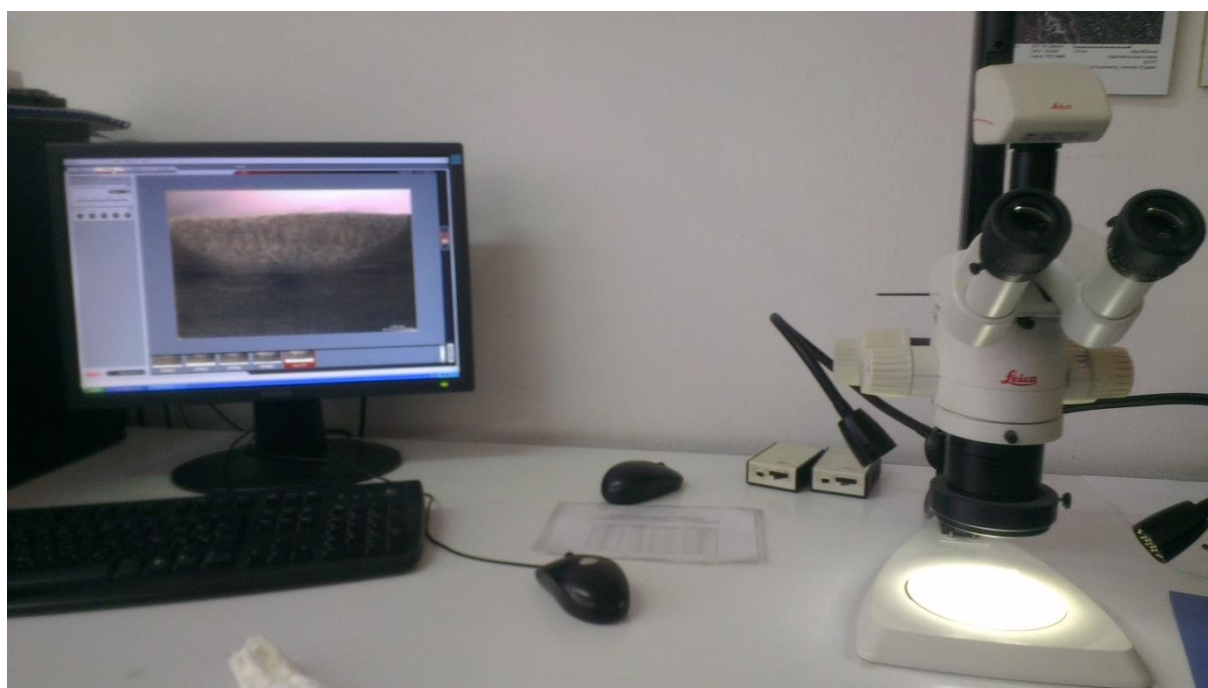
Slika 57. Snimanje makroizbrusaka korištenjem Leica MZ6 stereomikroskopa
