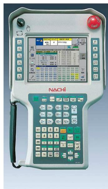
Slika 19. Upravljačka jedinica i privjesak za učenje [17]
