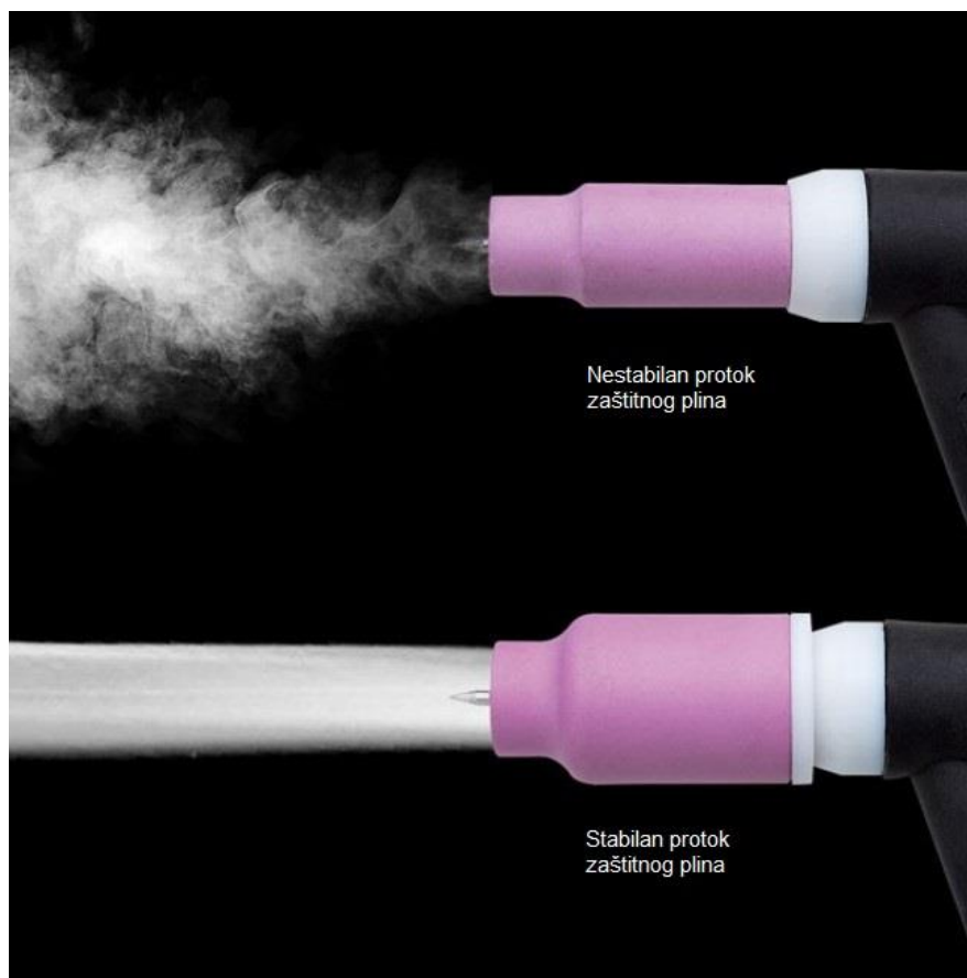
Slika 7. Stabilan i nestabilan protok zaštitnog plina [9]
