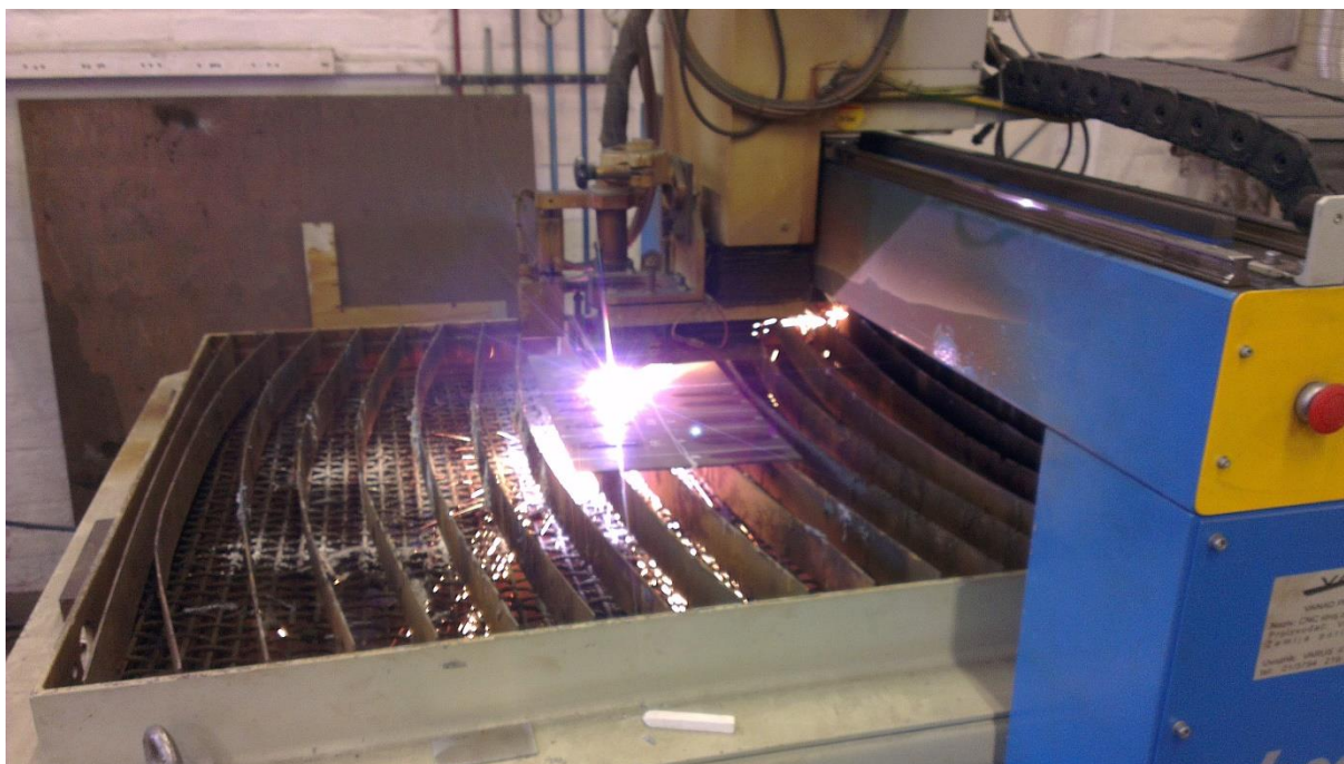
Slika 54. Rezanje čelične ploče na manje komade na CNC plazma rezaču Vanad
