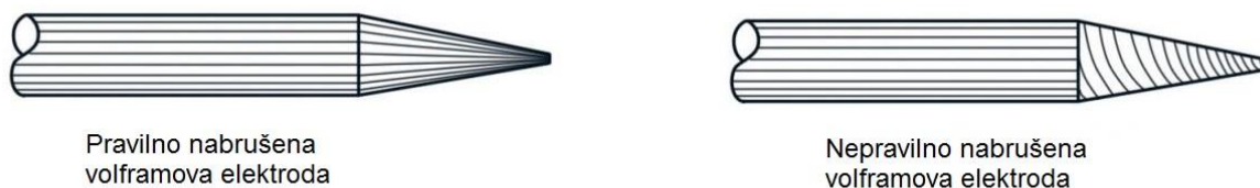
Slika 9. Izgled pravilno i nepravilno nabrušene volframove elektrode [10]
