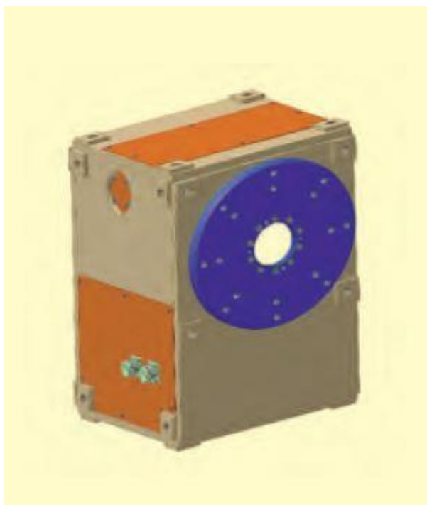
Slika 24. Jednostruki robotizirani okretni pozicioner [17]
