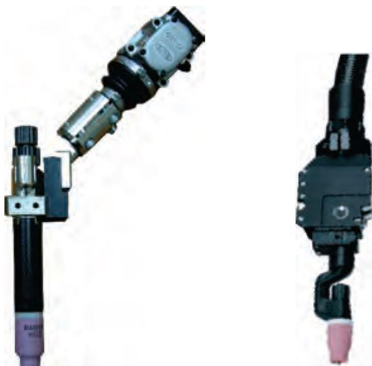
Slika 23. Pištolj za robotizirano TIG zavarivanje bez automatskog dodavanja dodatnog materijala [17]
