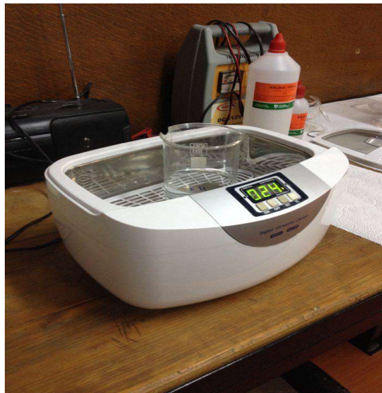
Slika 10. Ultrazvučni uređaj za čišćenje uzorka
