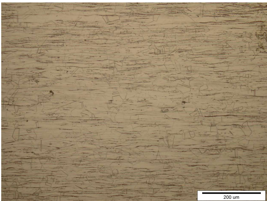
Slika 22. AISI 304 (A2) povećanje 200x
