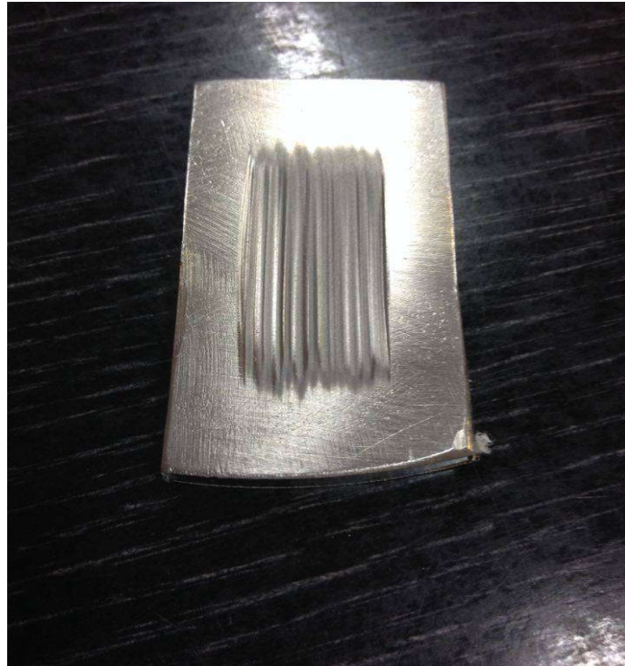
Slika 14. Trag trošenja materijala
