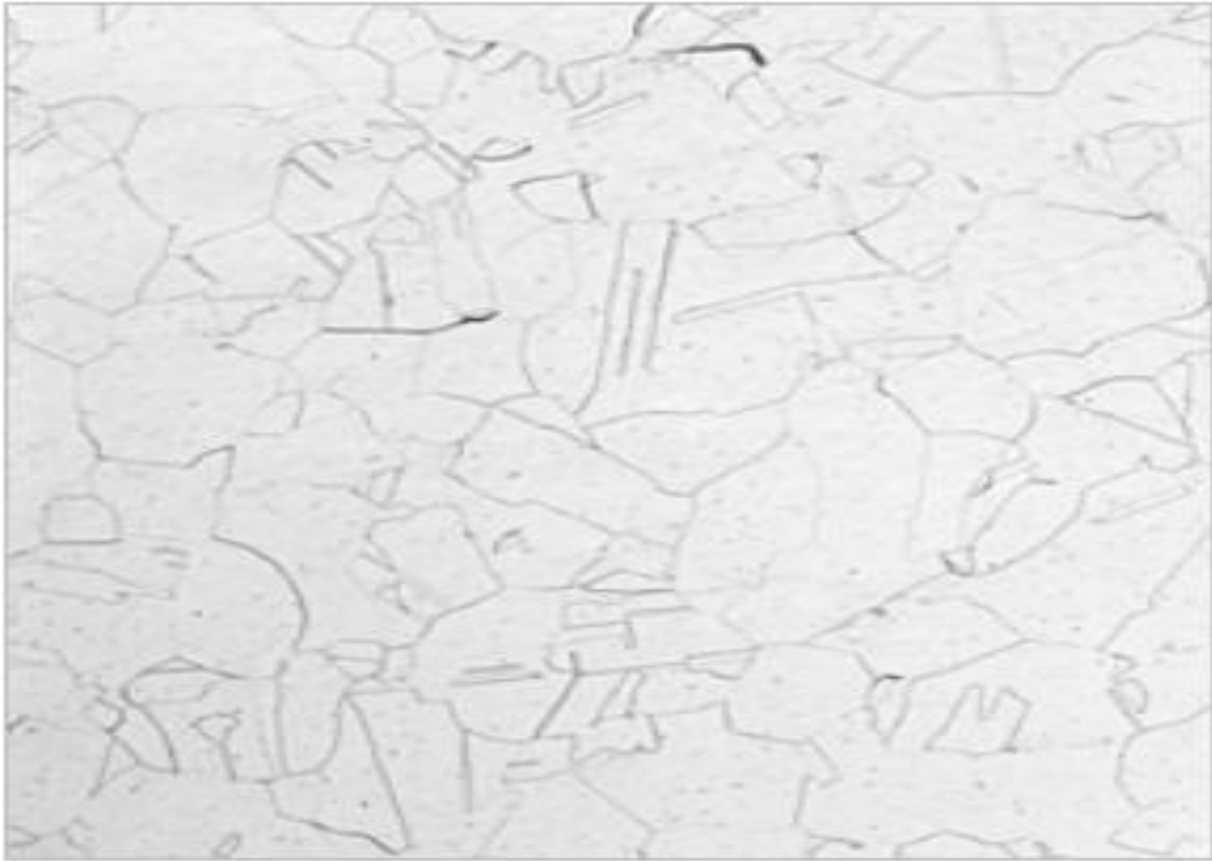
Slika 2. Mikrostruktura austenitnog nehrđajućeg čelika [4]
