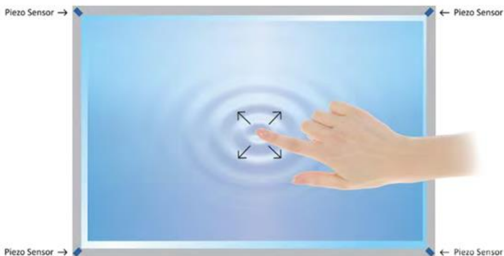
Slika 17. Zaslon koji koristi tehnologiju disperzivnih signala [14]
