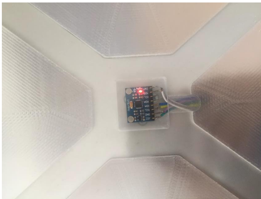
Slika 11. Žiroskop MPU-6050 na nastavnoj maketi
