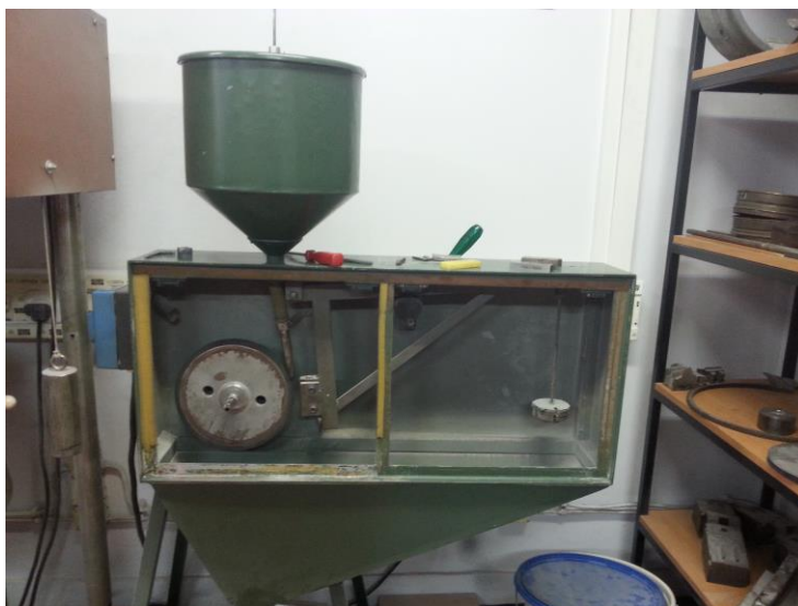
Slika 5.5. Uređaj „suhi pijesak/gumeni kotač“
