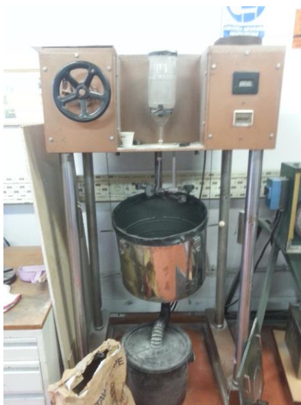
Slika 5.13. Uređaj za ispitivanje erozijskog trošenja a) izgled uređaja, b) shematski prikaz [10].
