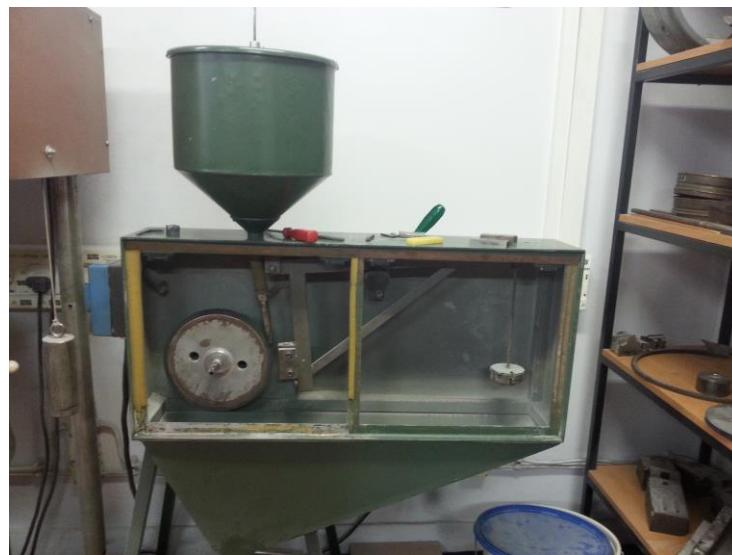
**Slika 5.5.** Uređaj „suhu pijesak/gumeni kotač“
