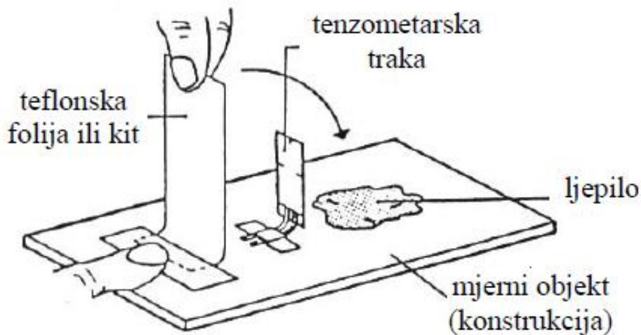
**Slika 4.3.** Lijepljenje tenzometarske trake [10].
