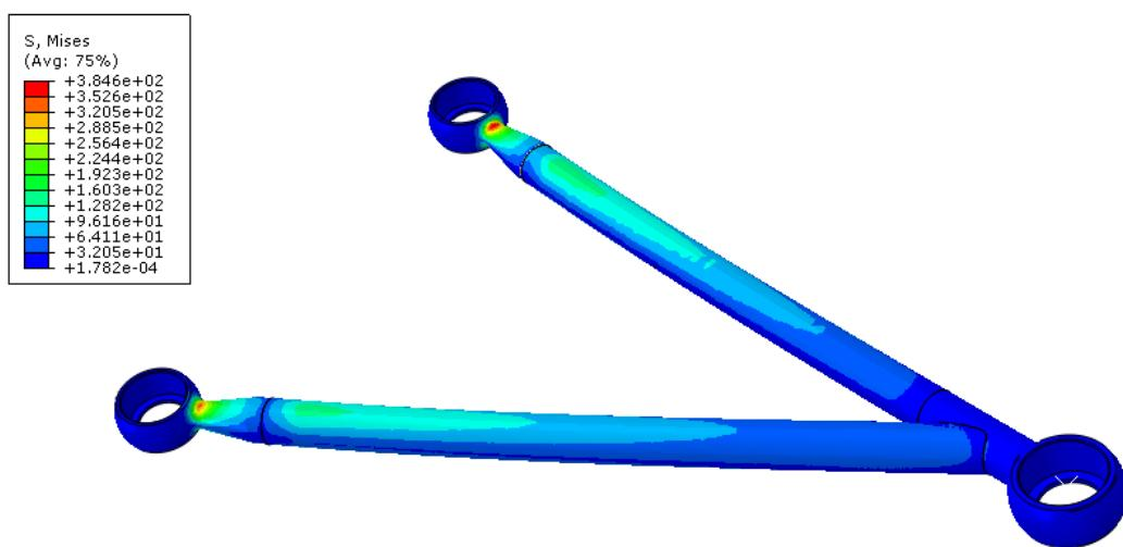
Slika 5.11. Prikaz naprezanja za ispitnu proceduru *Skidpad*.
