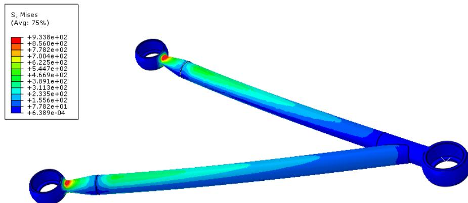
**Slika 3.15.** Prikaz naprezanja za 3. slučaj opterećenja.
