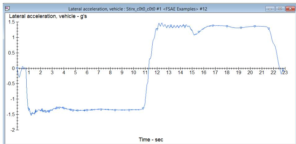
**Slika 5.3.** Prikaz ovisnosti bočnog ubrzanja o vremenu.
