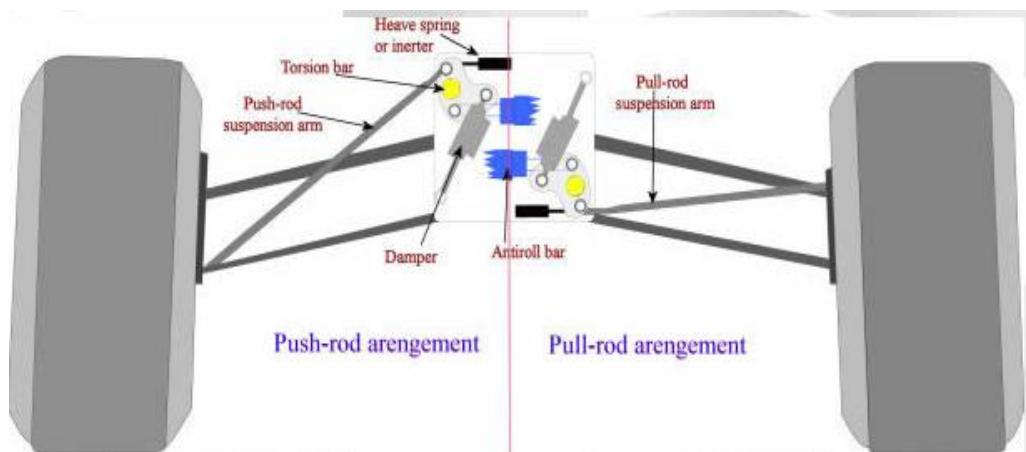
**Slika 2.6.** *Push – rod* i *Pull – rod* sustav.
