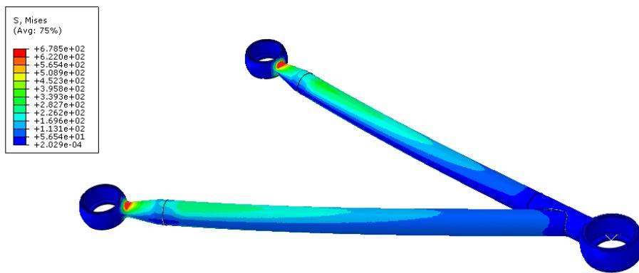
**Slika 3.14.** Prikaz naprezanja za 2. slučaj opterećenja.
