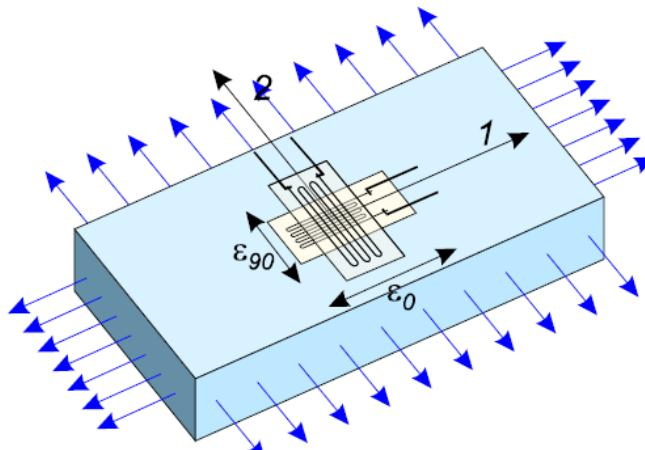
**Slika 4.5.** Mjerna traka postavljena u smjerovima glavnih naprezanja [10].
