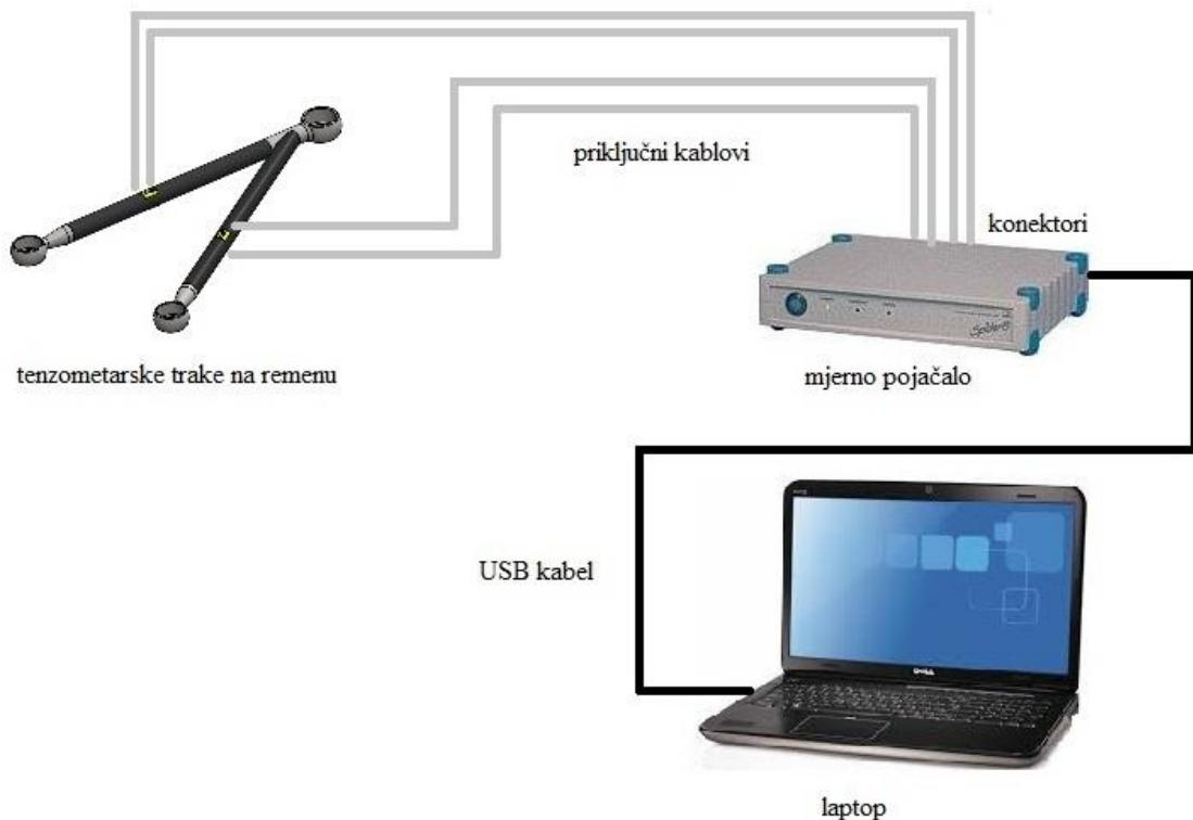
**Slika 4.19.** Shema ispitivanja naprezanja ramena ovjesa.
