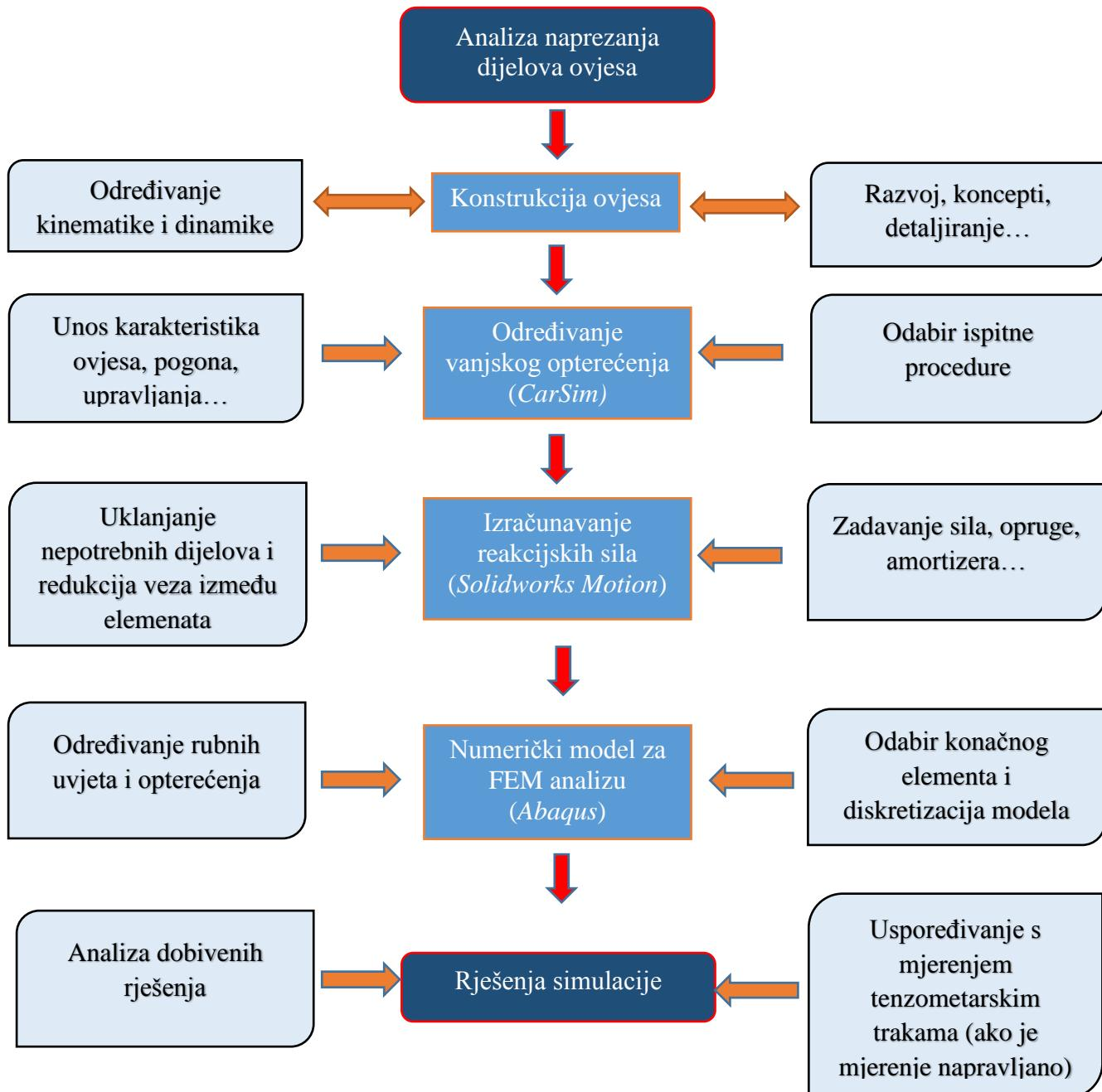
**Slika 6.1.** Dijagram toka određivanja naprezanja dijelova ovjesa.
