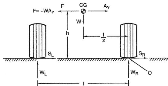
Slika 5.7. Prikaz prijenosa bočnog opterećenja, preuzeto iz [1].
