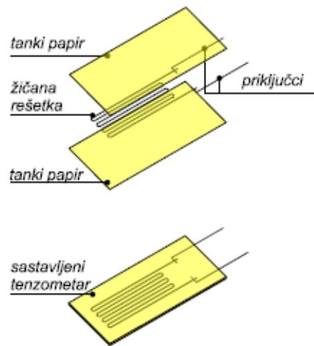
**Slika 4.2.** Tenzometar sa žičanom rešetkom [10].
