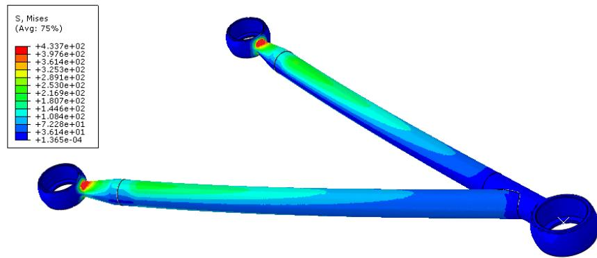
**Slika 3.13.** Prikaz naprezanja za 1. slučaj opterećenja.
