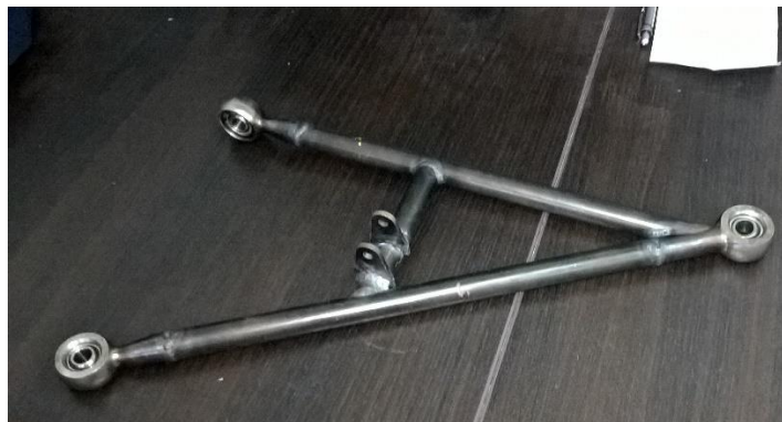
Slika 10. Donje stražnje rame bolida Strix
