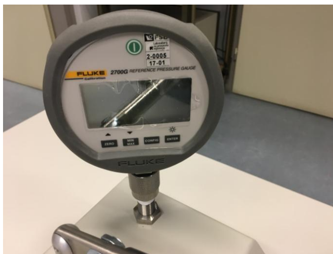
Slika 9: FLUKE 2700G pretvornik tlaka
