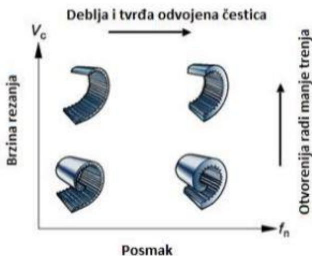
Slika 11. Ovisnost odvojenih čestica o posmaku i brzini rezanja [9]
