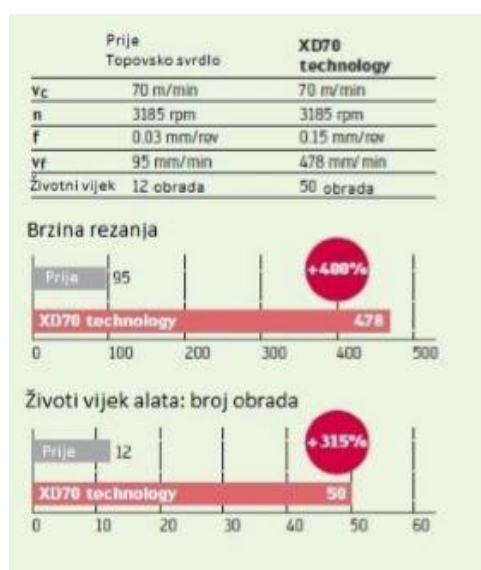
Slika 25. Usporedba XD tehnologije i topovskog svrdla [7]
