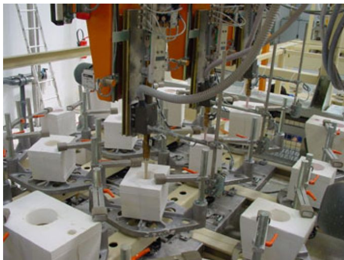
Slika 11. Izgled linije automatiziranog postupka lijevanja suspenzije [11]
