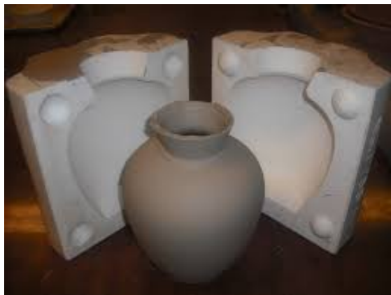
Slika 10. Primjer proizvoda dobivenog lijevanjem suspenzije [11]
