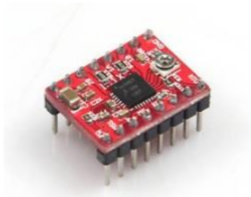
Slika 15. Upravljač koraknim motorima ( A4988 )
