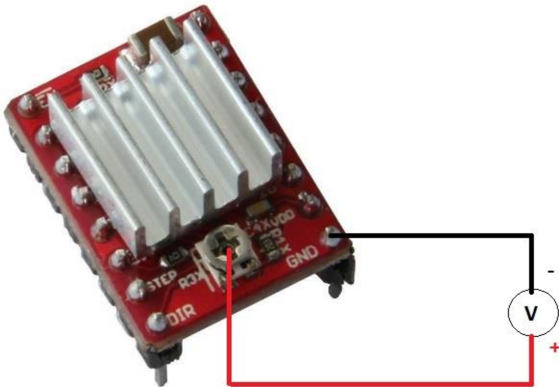
Slika 16. Mjerenje napona na upravljaču koračnih motora
