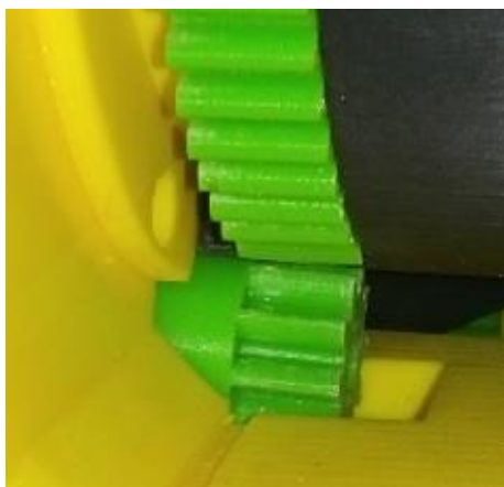
Slika 6. Zupčanic koračnog motora u zahvatu sa zupčanicom članka robotskog manipulatora
