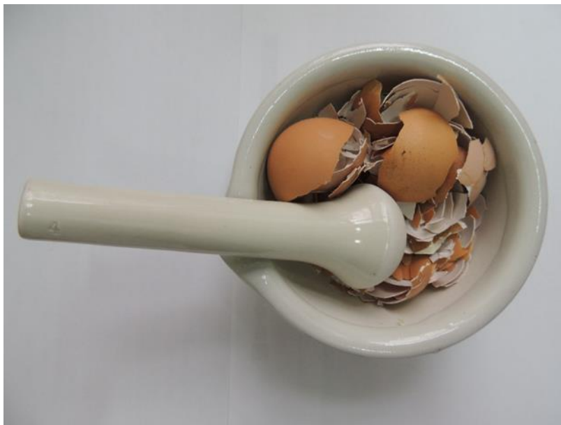
Slika 8. Usitnjavanje osušenih ljsaka jajeta u keramičkom tarioniku
