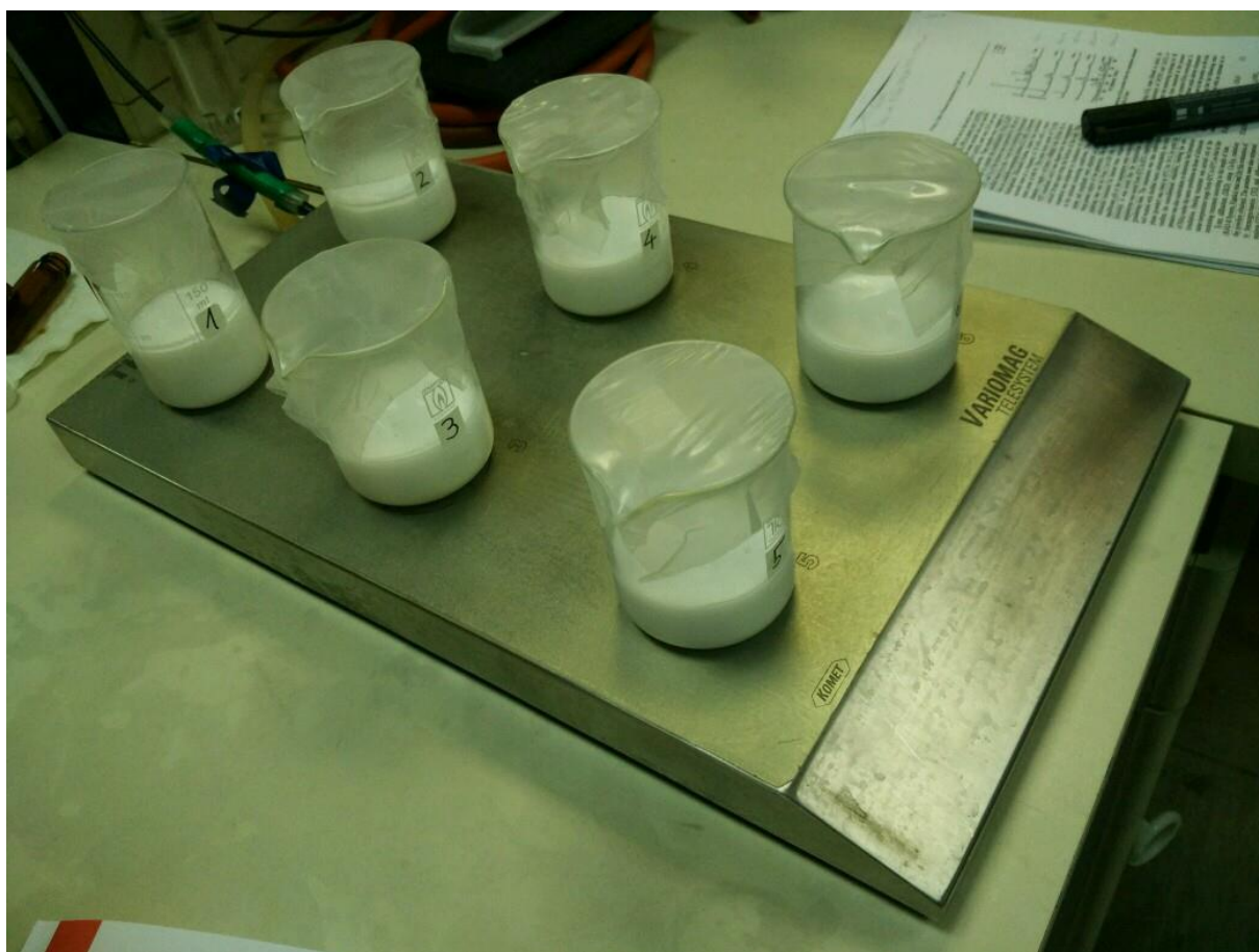
Slika 12. Sinteza kalcijevog hidroksida na magnetnoj miješalici
