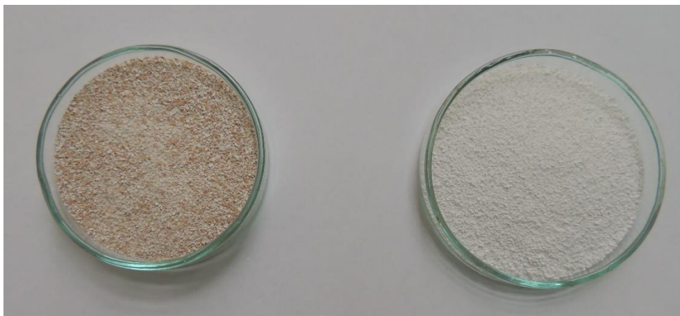
Slika 10. Usitnjene ljuske jajeta: (A) \text{CaCO}_3 - prije toplinske obrade; (B) \text{CaO} - nakon toplinske obrade pri 1000 °C
