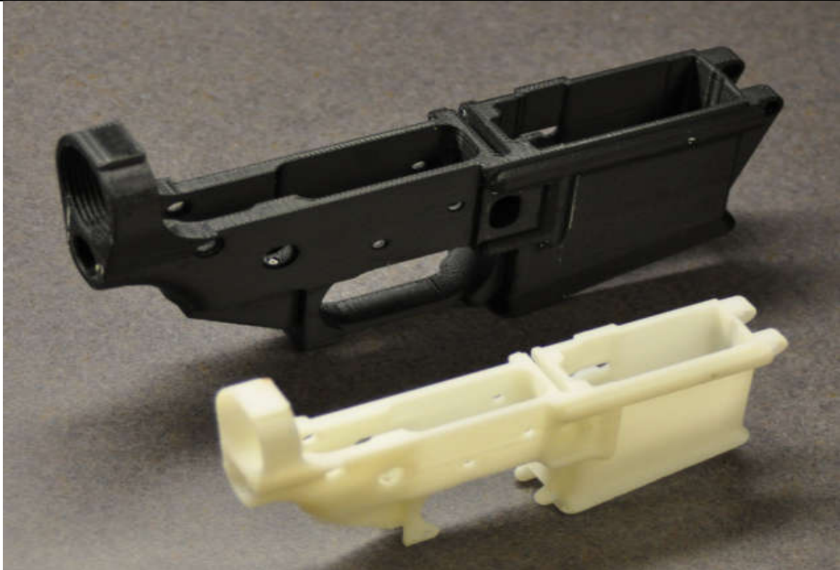
Slika 14. Konstrukcijski dijelovi oružja izrađeni 3D printanjem[22]
