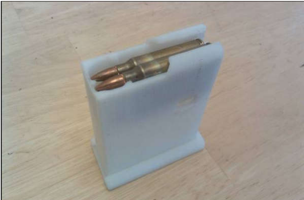
Slika 13. Okvir za metke izrađen 3D printanjem[21]
