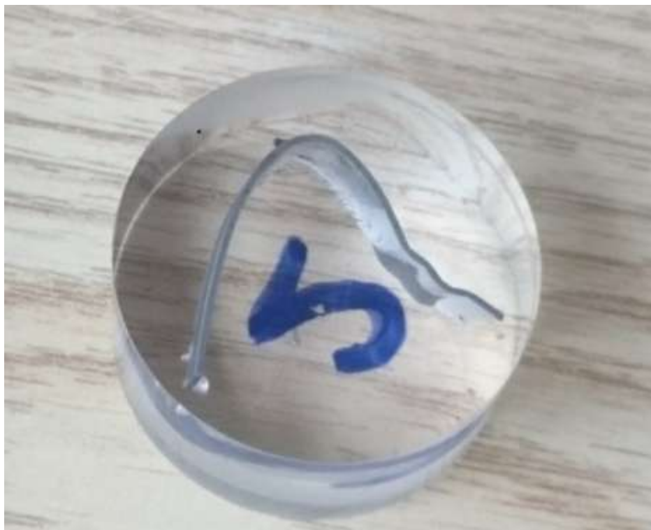
Slika 26. Metalografski pripremljen uzorak
