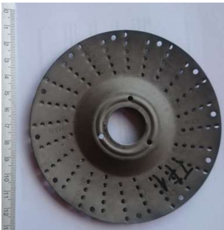
Slika 16. Izgled ispitnog uzorka nakon postupka nitrokarburiranja u solnoj kupki Tenifer (uzorak 1)
