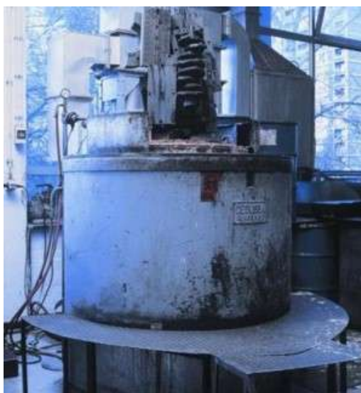
Slika 14. Peć za postupak tenifer "DURFERRIT-DEGUSSA GmbH"
