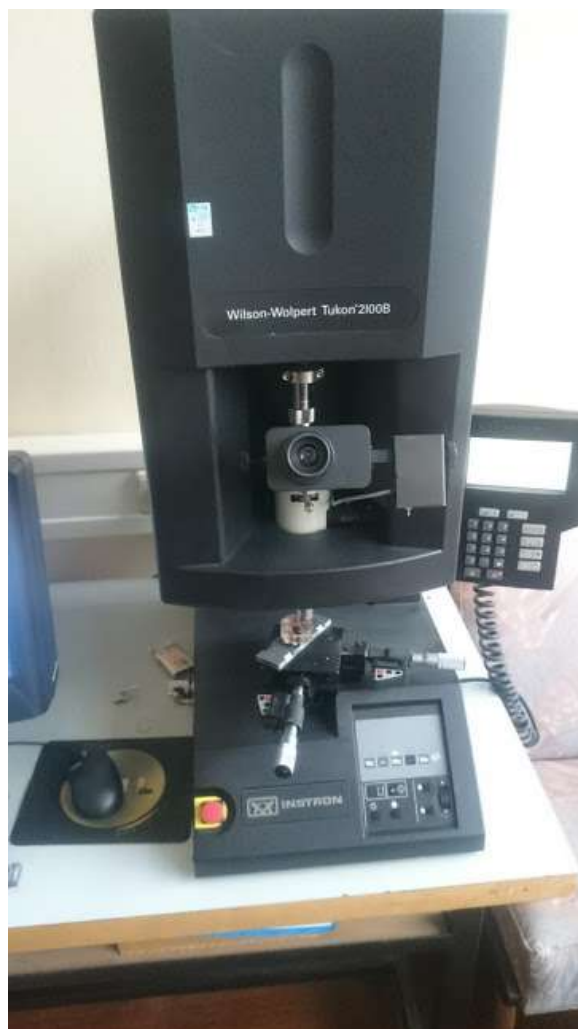
Slika 27. Mikrotvrdomjer Instron Wilson Wolpert Tukon 2100b
