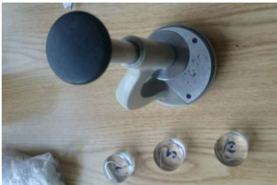
Slika 28. Ispitni uzorci i alat za utiskivanje uzoraka u plastelin
