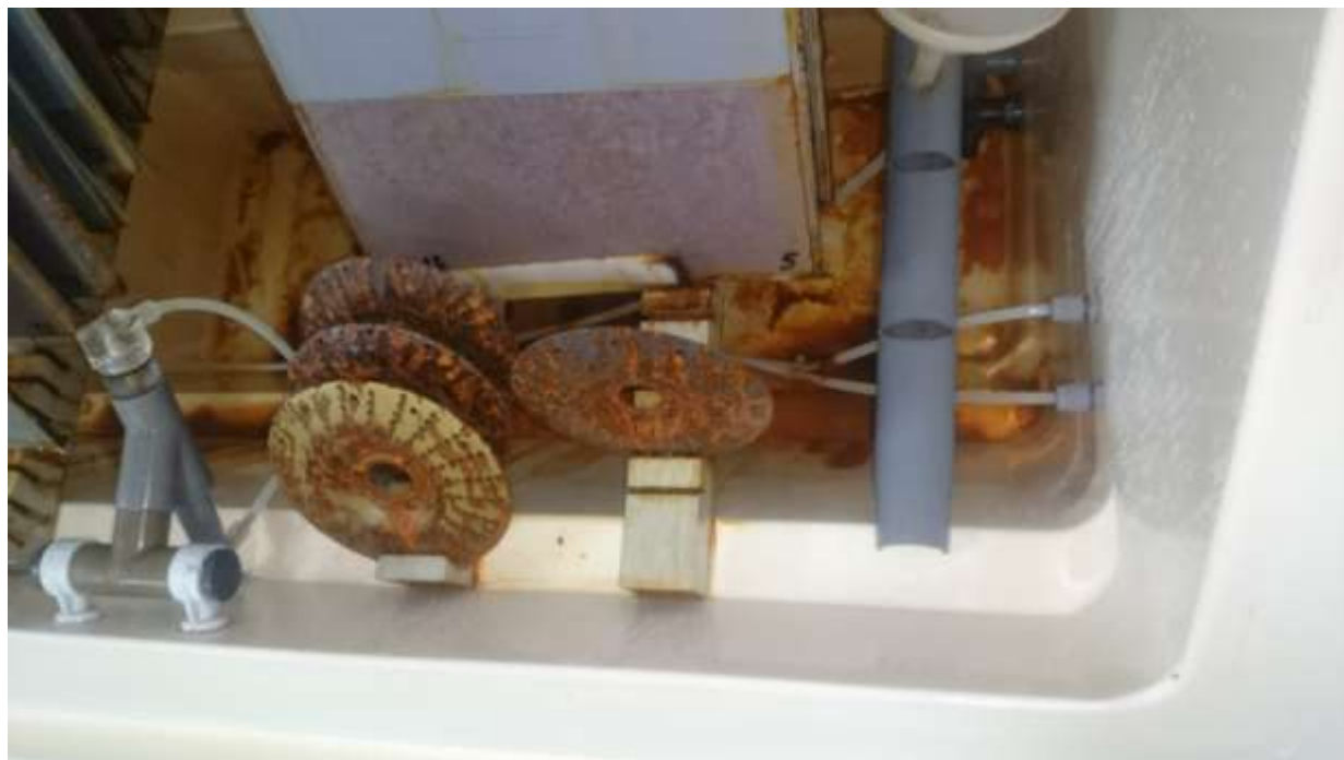
Slika 23. Ispitni uzorci prije ispitivanja u slanoj komori u trajanju 24 h
