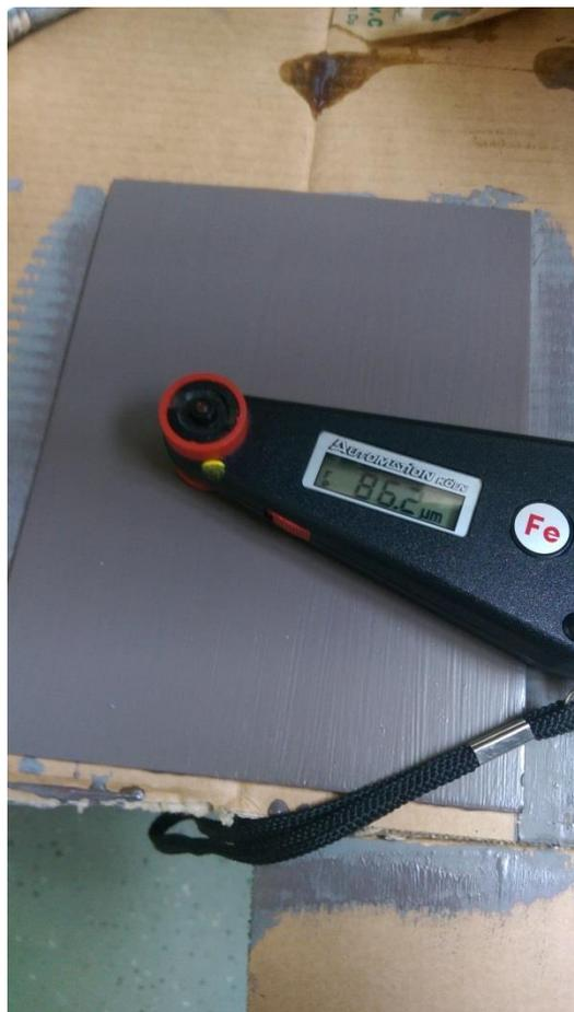
Slika 20. Mjerenje debljine suhog filma uređajem QuaNix 1500
