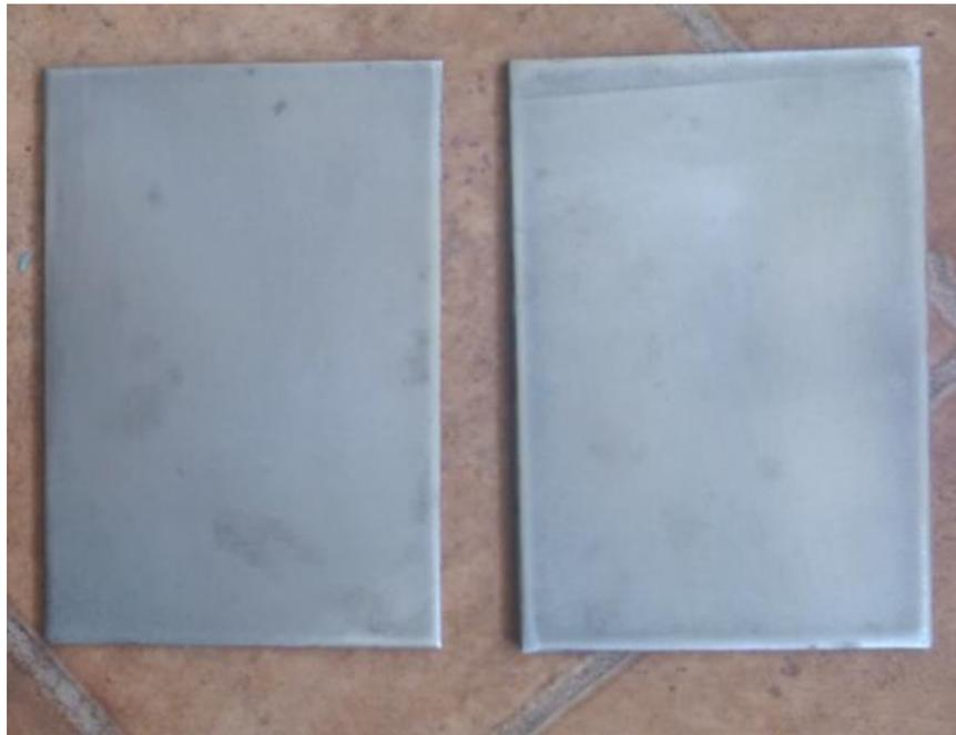
Slika 16. 1. grupa uzoraka (očišćeni i odmašćeni)
