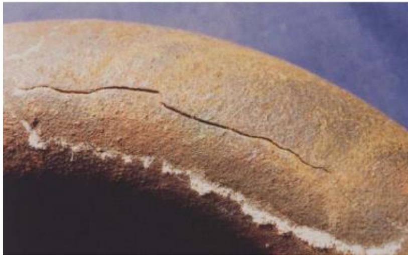
Slika 5. Napetosna korozija na cijevi [6]
