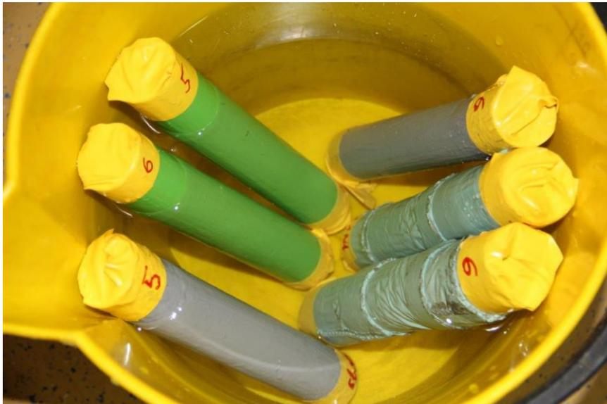
Slika 23. Ispitivanje u vodenoj otopini 3,5 % NaCl
