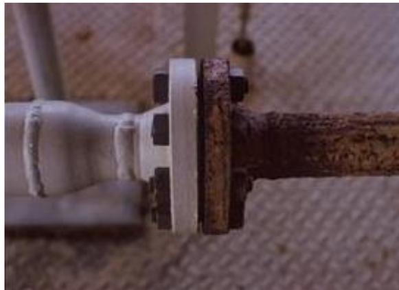
Slika 4. Kontaktna korozija na odobalnom postrojenju [5]
