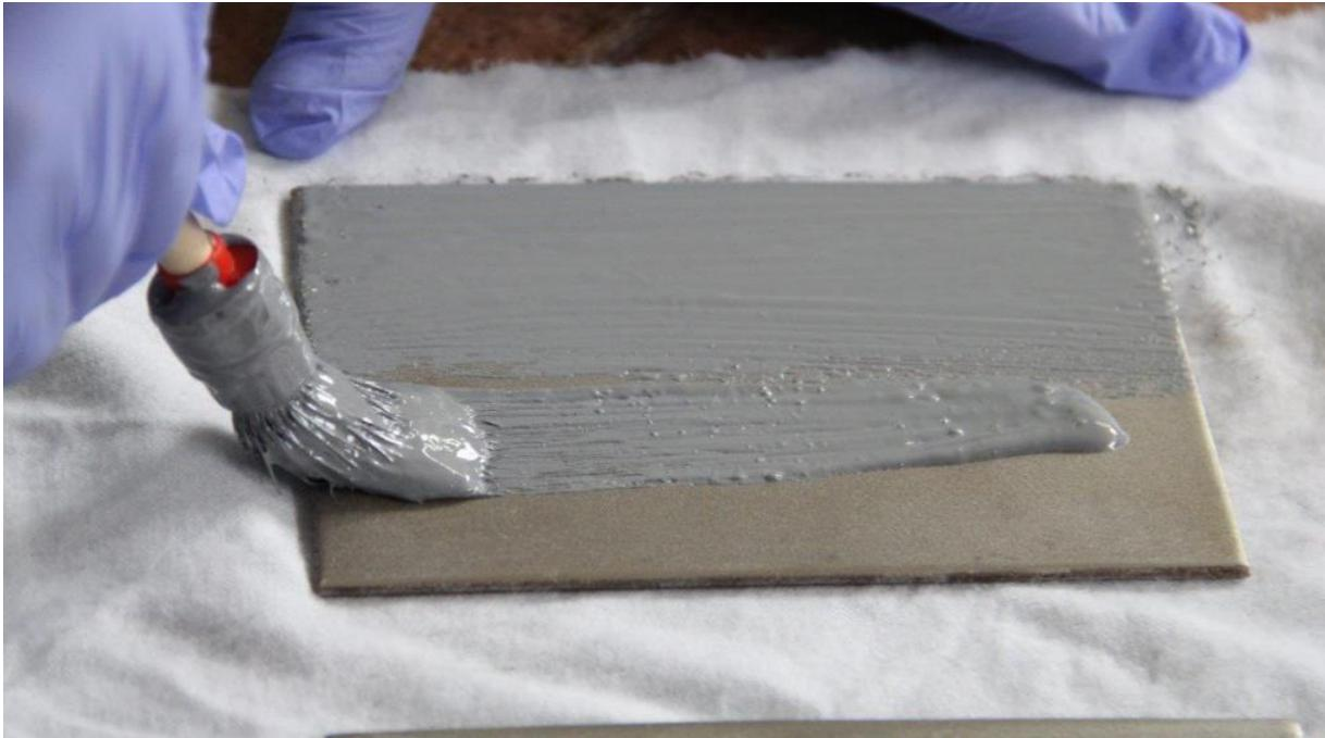
Slika 18. Nanošenje premaza od Belzone na pločice
