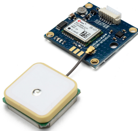
Slika 5.9: GPS modul baziran na uBlox NEO M8N prijammniku
