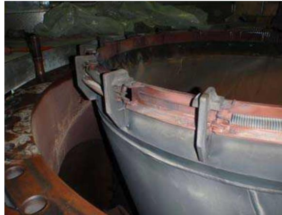
Slika 4. Jedan segment belt brtve i ugrađena belt brtva na donji dio unutarnjeg kućišta komore izgaranja
