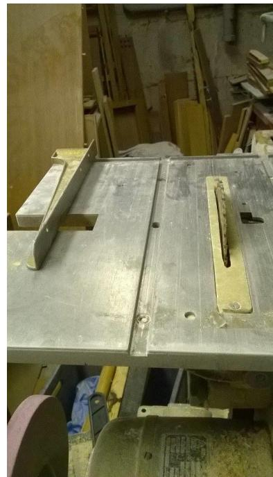
**Slika 28. Kružna motorna pila za rezanje uzoraka**
