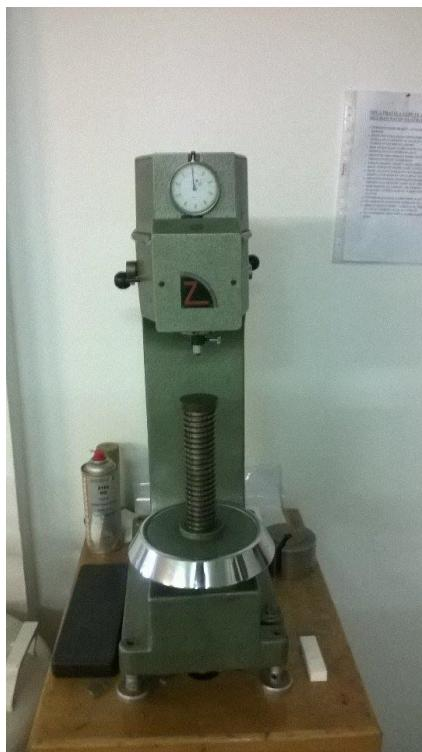
Slika 39. Tvrdomjer ZWICK & Co Härteprüfgerät 3106
