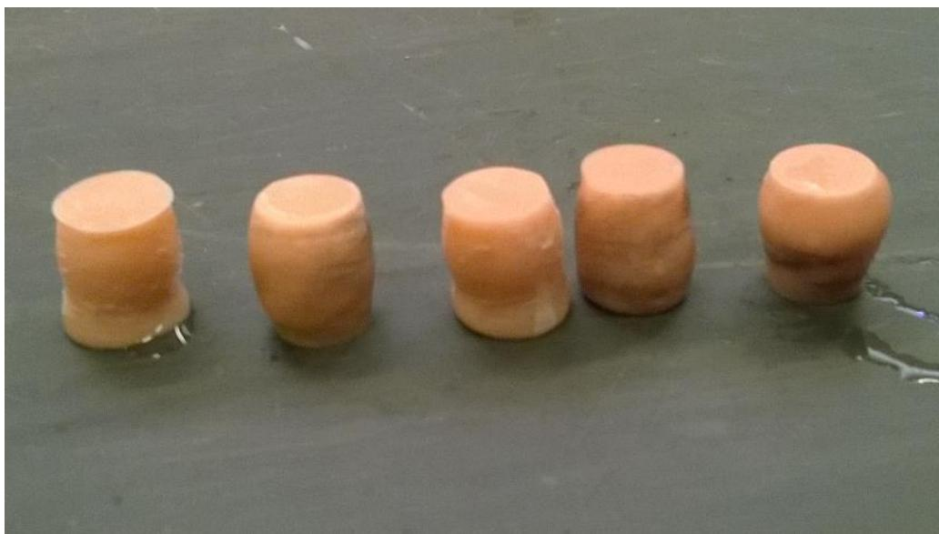
Slika 44. Deformirane (sabijene) epruvete nakon ispitivanja
