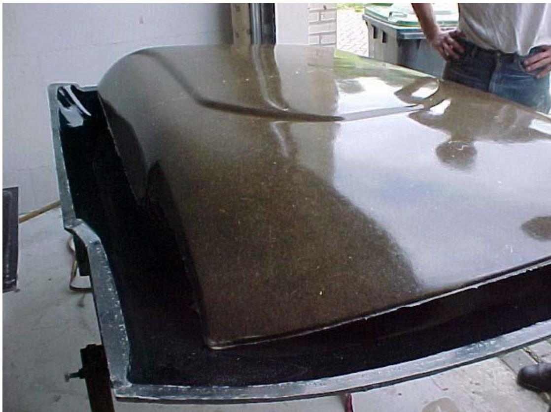
**Slika 2. Krov automobila načinjen od lanenog vlakna**
