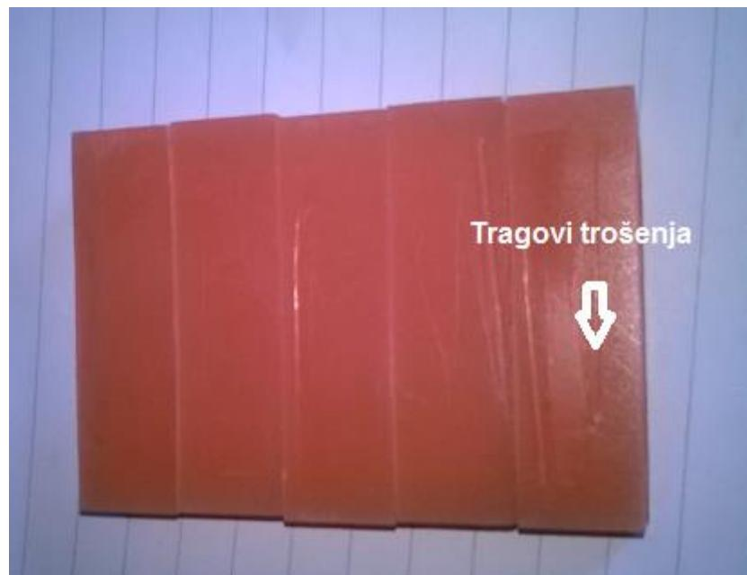
Slika 51. Ispitani uzorci na trošenje
