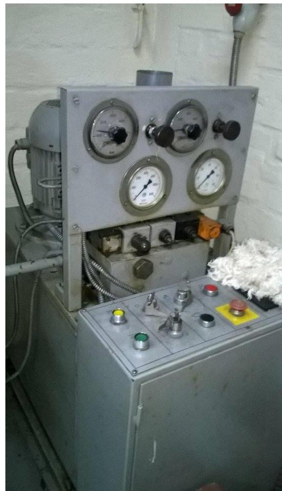
Slika 25. Slika prikazuje upravljačku ploču preše
