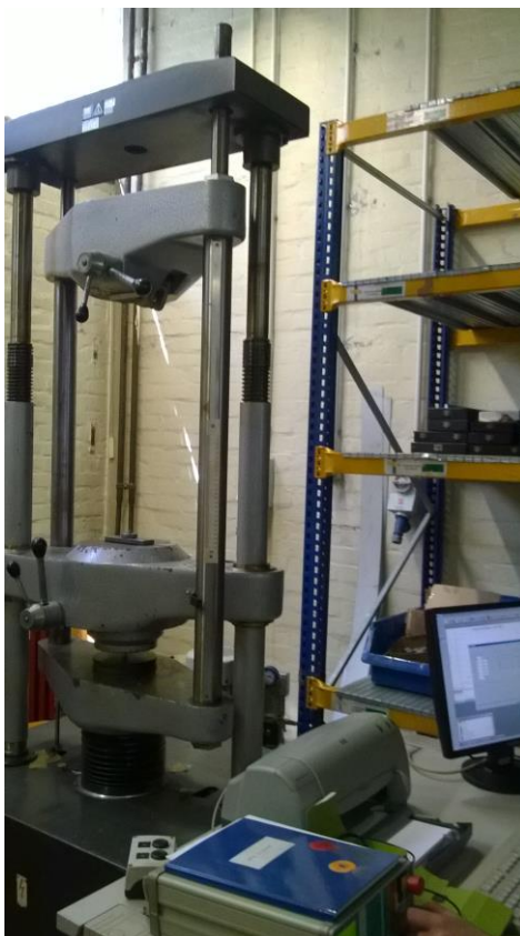
Slika 41. Univerzalna kidalica WPM EU 40 MOD
