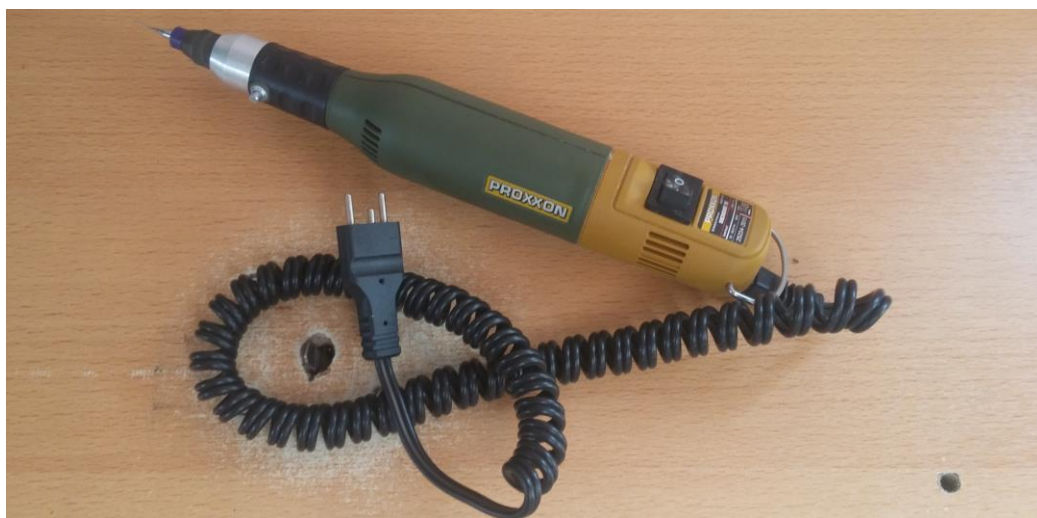
Slika 19. Bušilica za bušenje rupa na tiskanim pločicama
