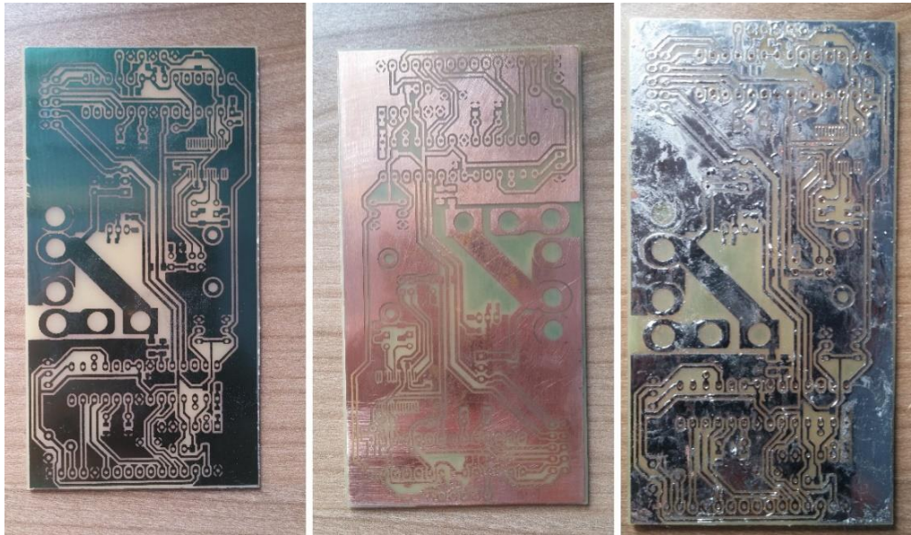
Slika 18. Skidanje laka i kositrenje tiskane pločice
